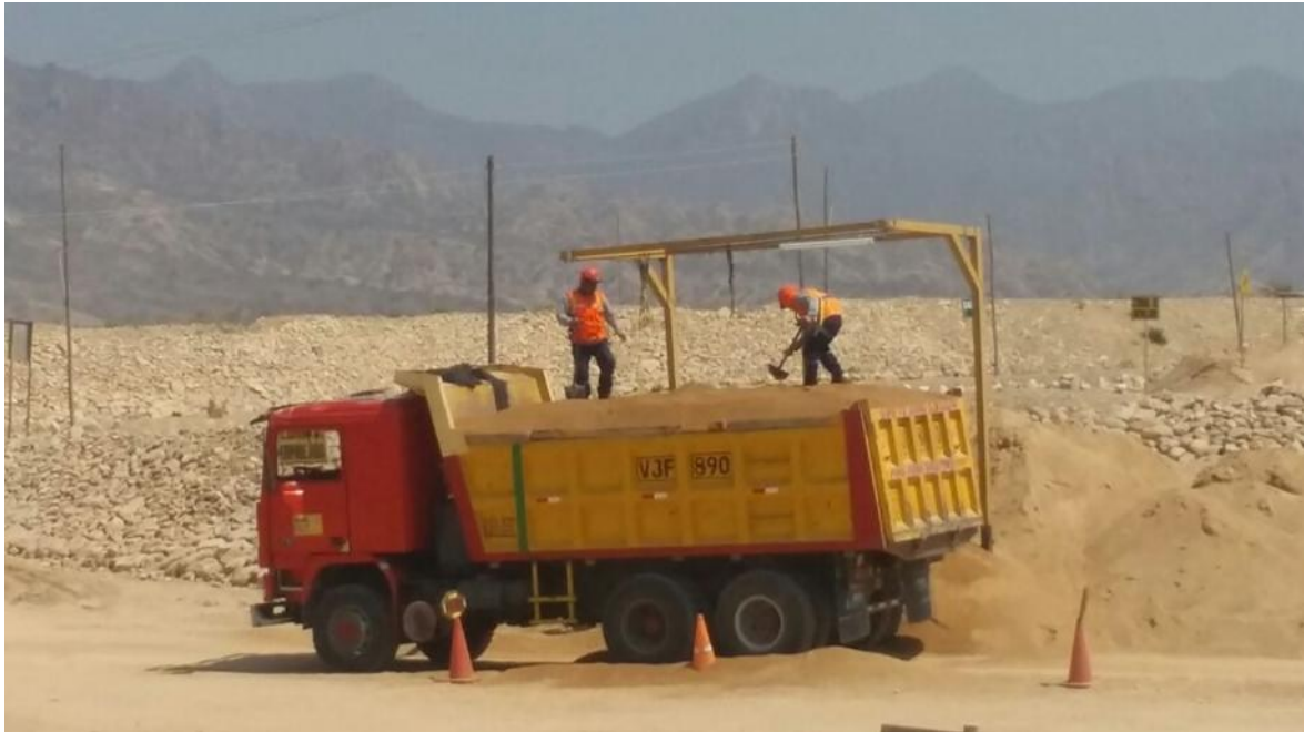
Labores de emparejado en el sector Clasificadora en la cantera Pátapo La Victoria S.A.
