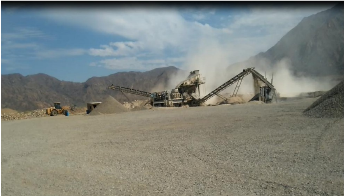
Equipo de chancado en operaciones en el sector Planta Chancadora en la cantera Pátapo La Victoria S.A.
