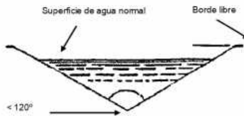
FIGURA 6 – SECCIÓN TEÓRICA DE UNA RÁPIDA DE FLUJO ESTABLE. LA FORMA TRIANGULAR PROVIENE TANTO DE LAS ONDAS CRUZADAS COMO DE FLUJO NO ESTABLE
