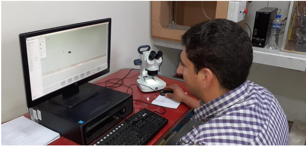
Figura 26. Evaluación microscópica de fibras de pseudotallo de plátano
