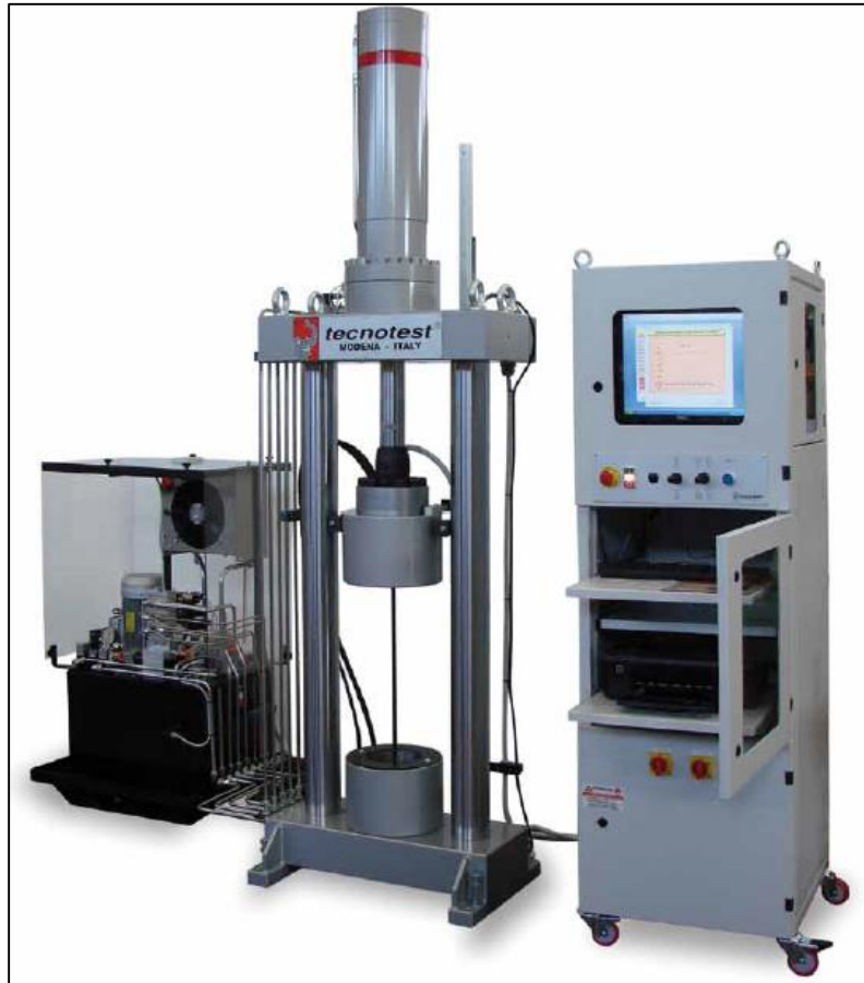
Figura 13. Equipo de ensayo universal utilizado
