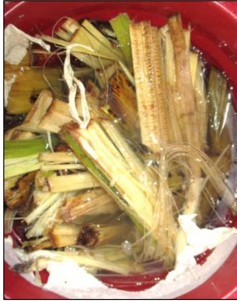
Figura 17. Proceso de remojo de Pseudotallo de plátano
