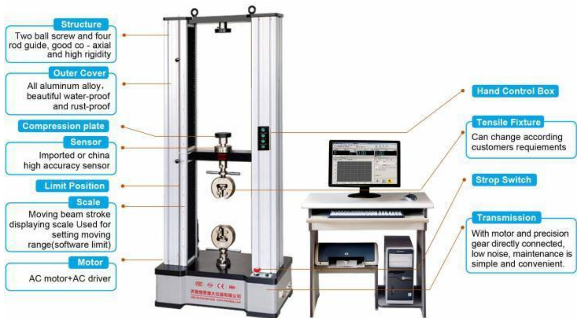
Figura 21. Partes del equipo universal de ensayos
