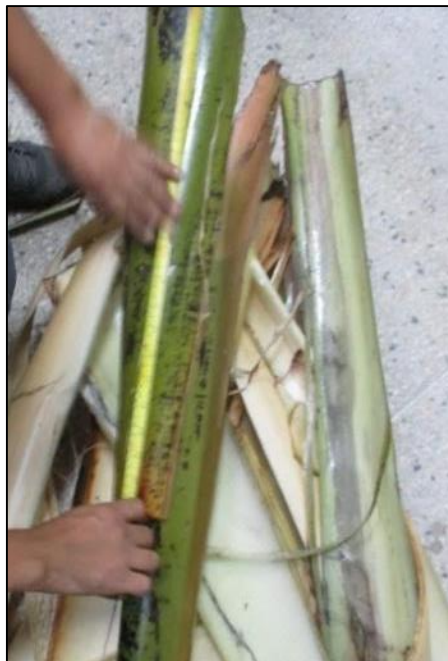
Figura 16. Proceso de separación de capas de Pseudotallo de plátano
