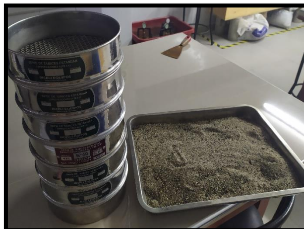
Foto 04: Tamizado de la muestra secada durante 24 horas.
