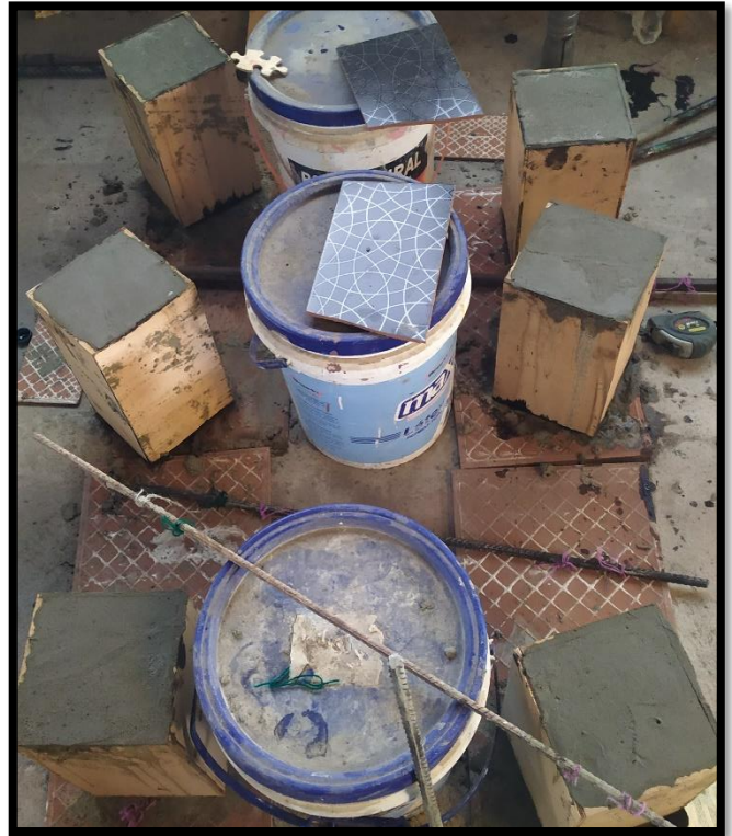
Foto 23: Vaciado del mortero y enrasamiento de cada bloque.
