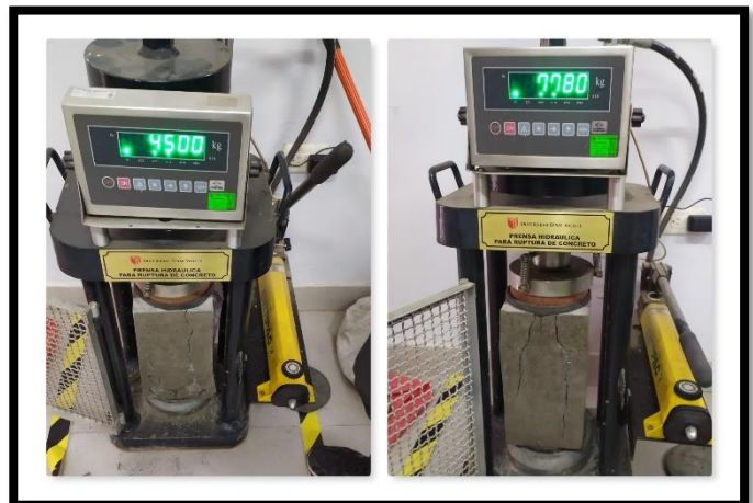
Foto 26: Ruptura de prismas a los 14 días.
