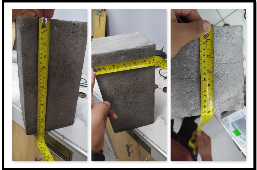
Foto 25: Medición de todos los prismas.
