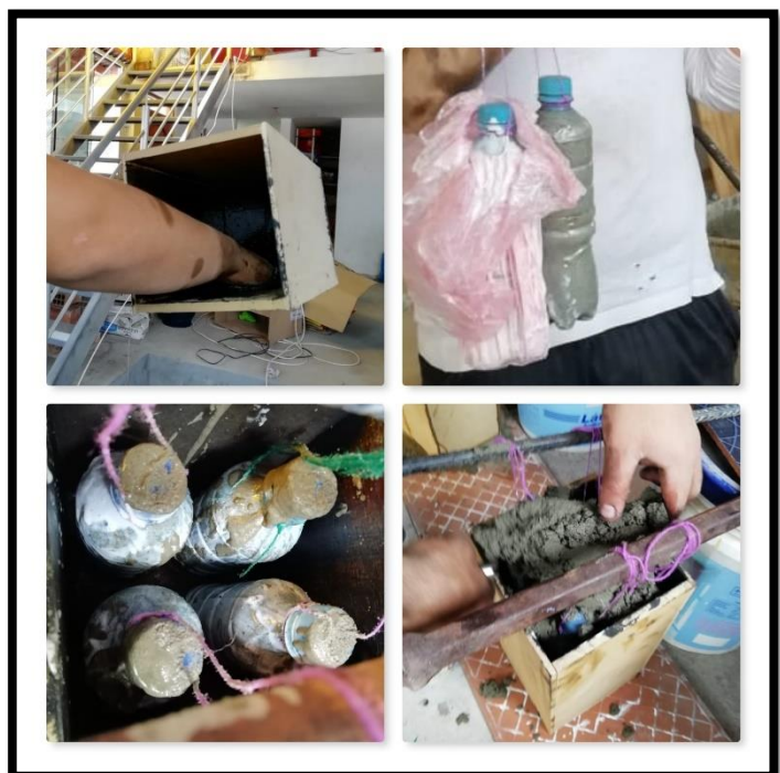
Foto 22: Engrasado de los moldes, engomado de las botellas y vaciado del mortero.
