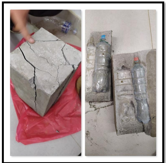
Foto 29: Vista de las fallas de los prismas.
