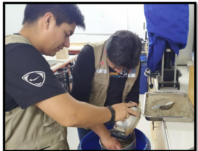
Foto 03: Lavado de material usando malla N°200 para eliminar limo.
