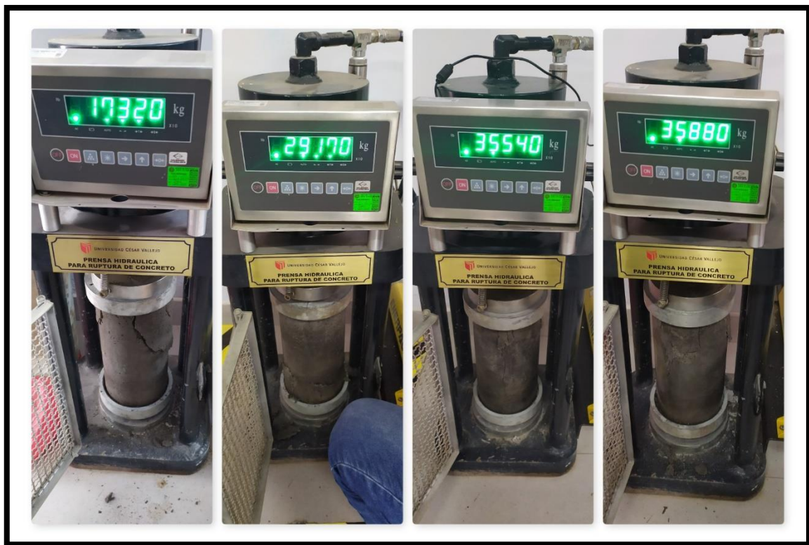
Foto 16: Ruptura de probetas a los 7, 14, 21 y 28 días respectivamente.
