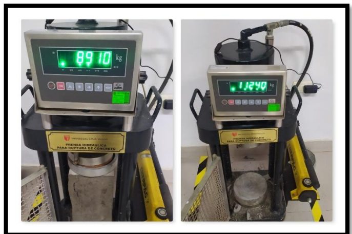
Foto 27: Ruptura de prismas a los 21 días.
