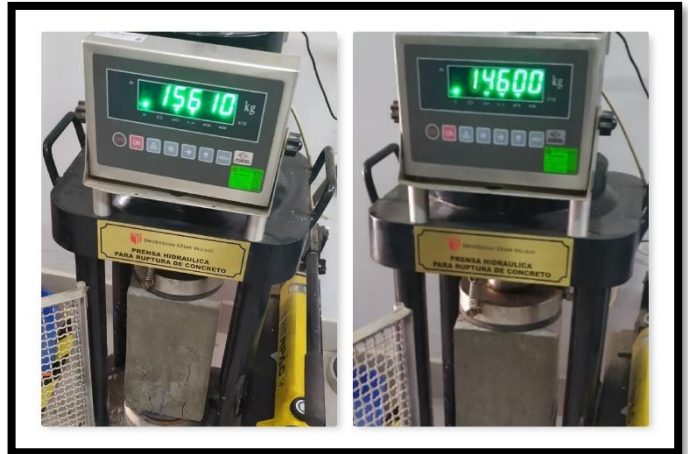
Foto 28: Ruptura de prismas a los 28 días.
