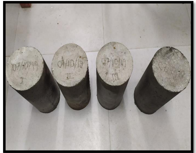
Foto 12: Desencofrado y marcado de las probetas con fecha y numeración.
