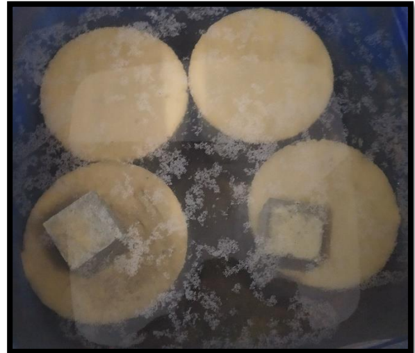
Foto 15: Sumergimiento de las probetas en agua, hasta su respectivo ensayo.
