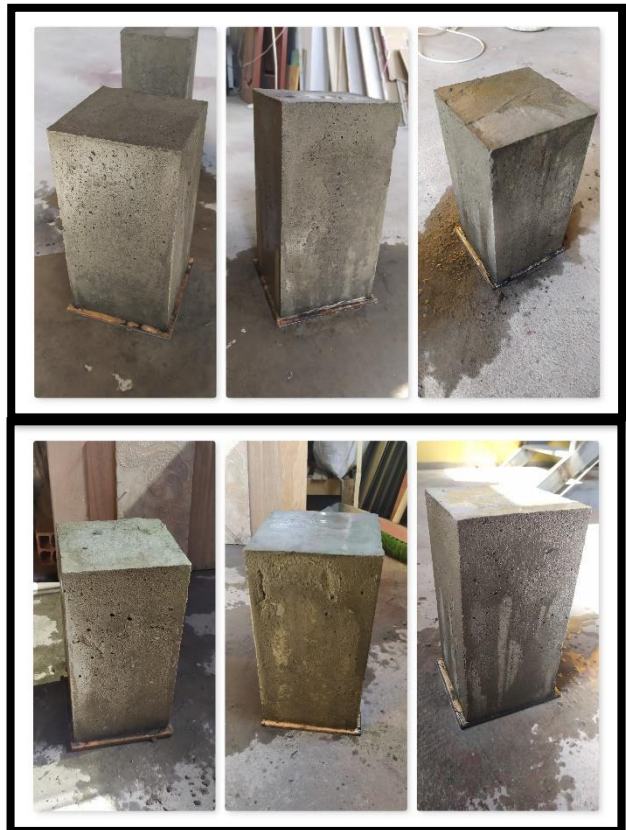
Foto 24: Desencofrado y curado de los prismas.
