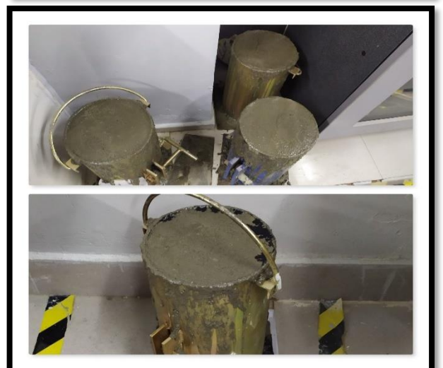
Foto 11: Probetas enrazadas para su respectivo secado a temperatura ambiente.
