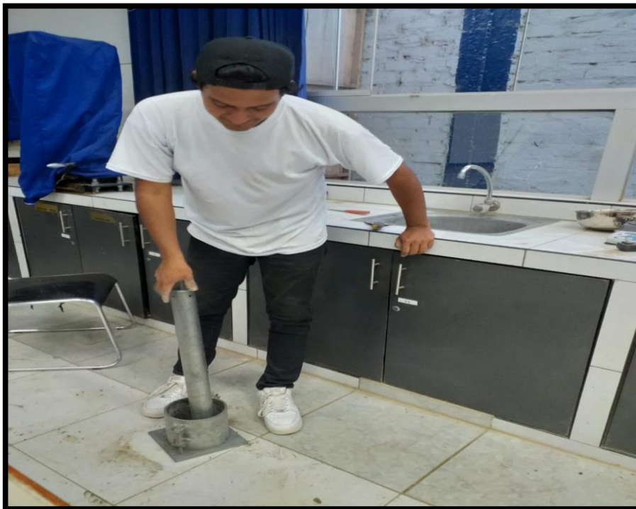
FOTO N° 07 GOLPEO POR CAPAS EN EL MOLDE DEL PROCTOR MODIFICADO
