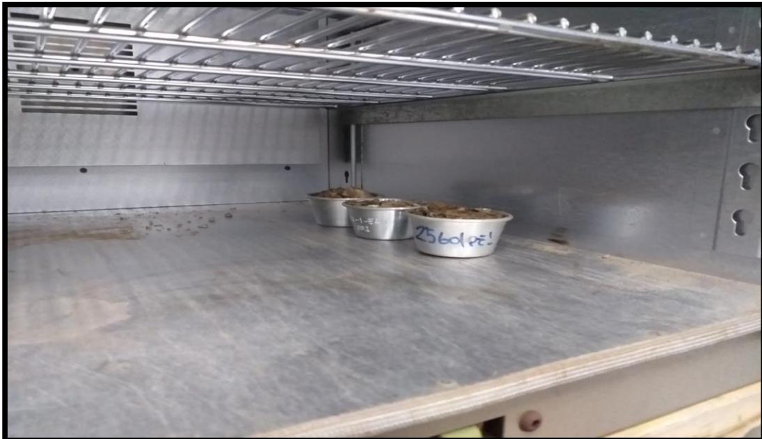
FOTO N° 11 TARAS CON MATERIAL PARA DETERMINAR EL CONTENIDO DE HUMEDAD A TRAVÉS DEL HORNO.
