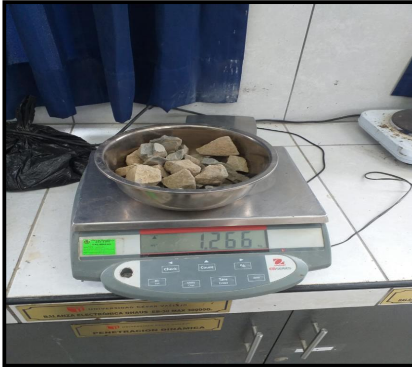
FOTO N° 11 TARAS CON MATERIAL PARA DETERMINAR EL CONTENIDO DE HUMEDAD A TRAVÉS DEL HORNO.
