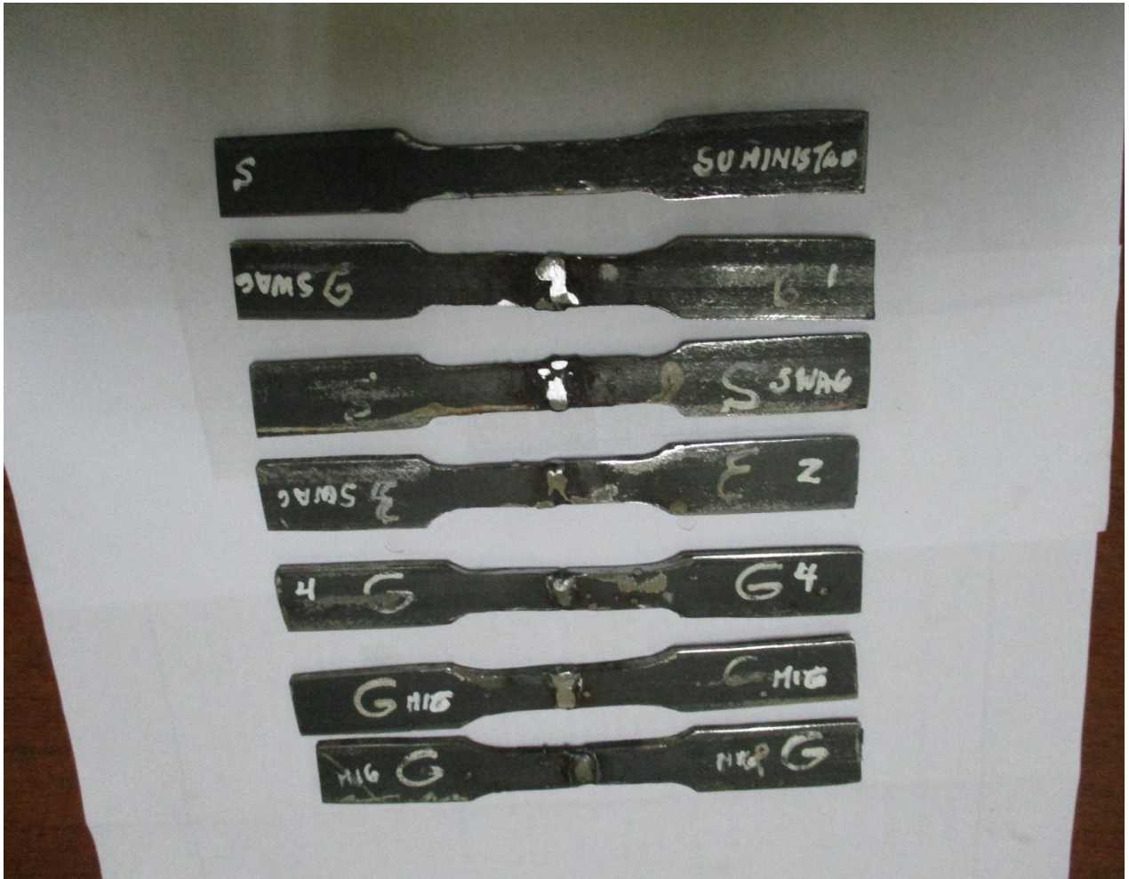
Probetas soldadas con los procesos SMAW y GMAW, incluida la probeta de suministro (sin soldar)
