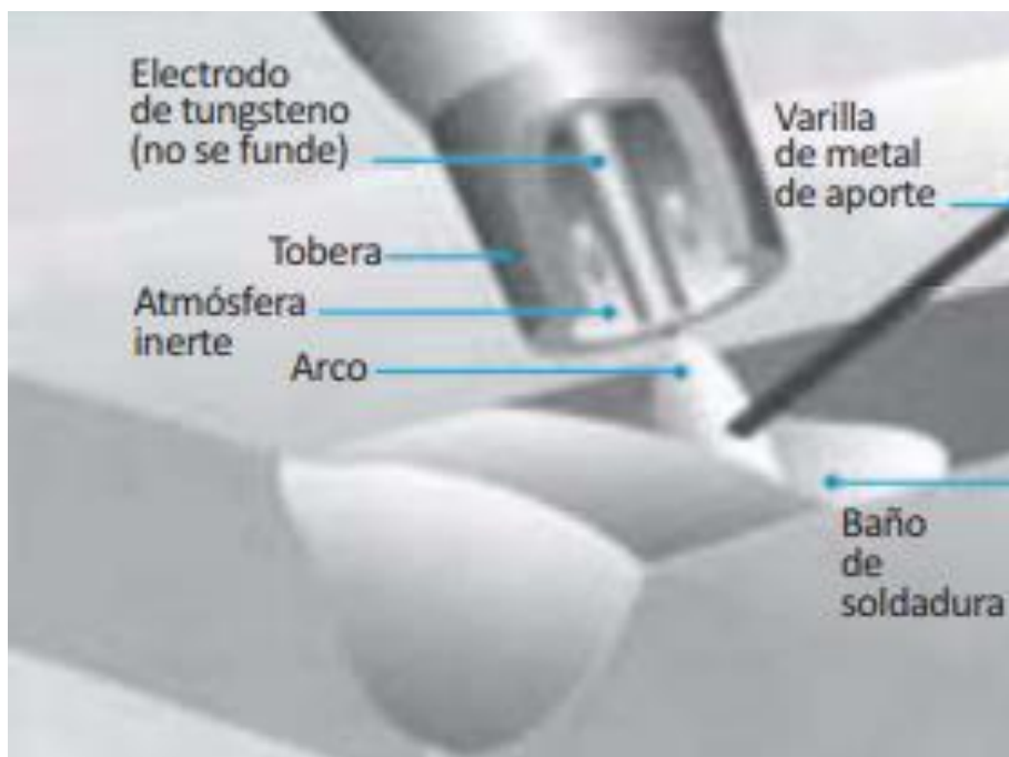
Figura 11. Proceso de soldadura TIG
