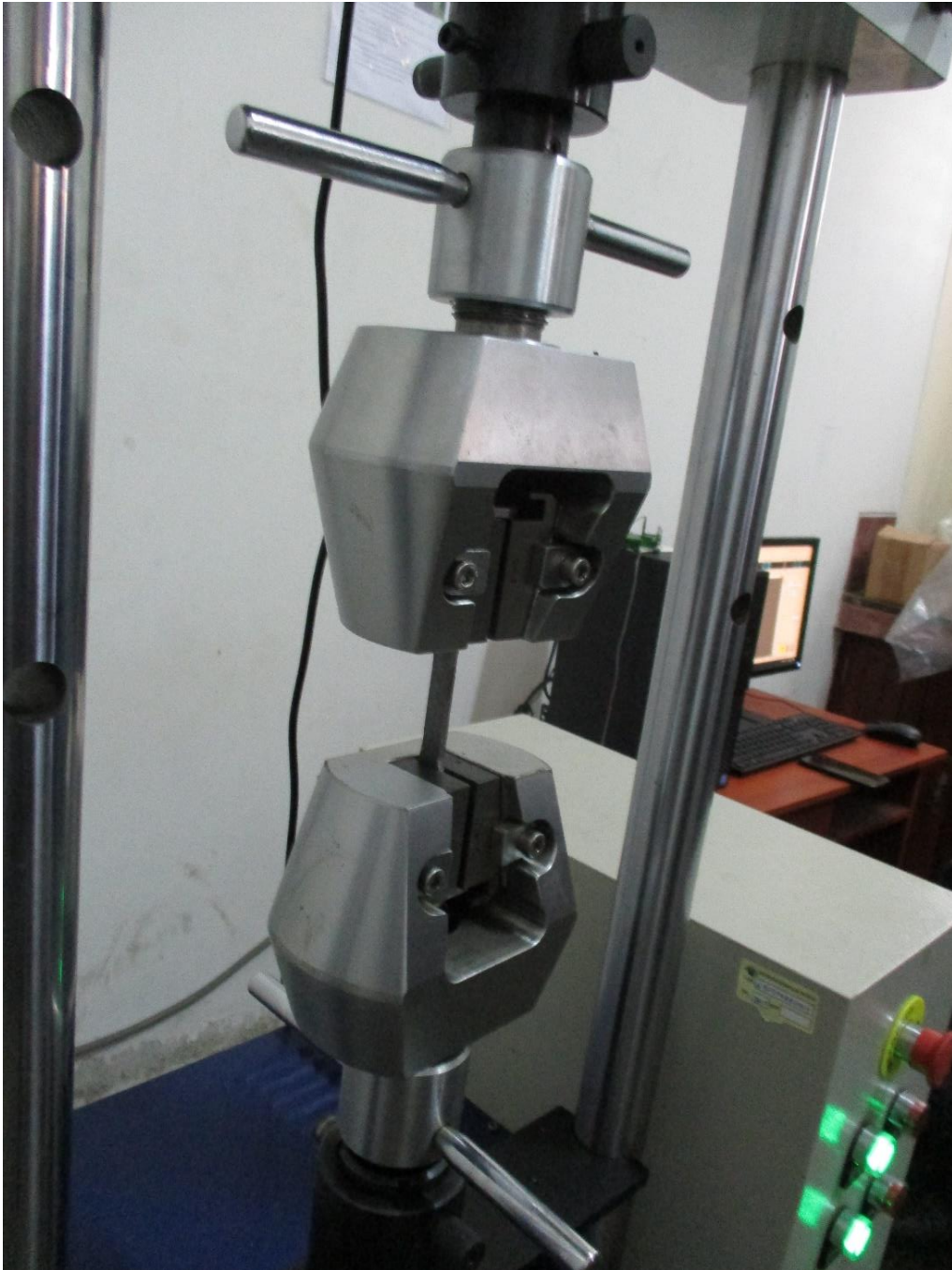
Máquina universal en el proceso de ejecución de la prueba de ensayo a la tracción.
