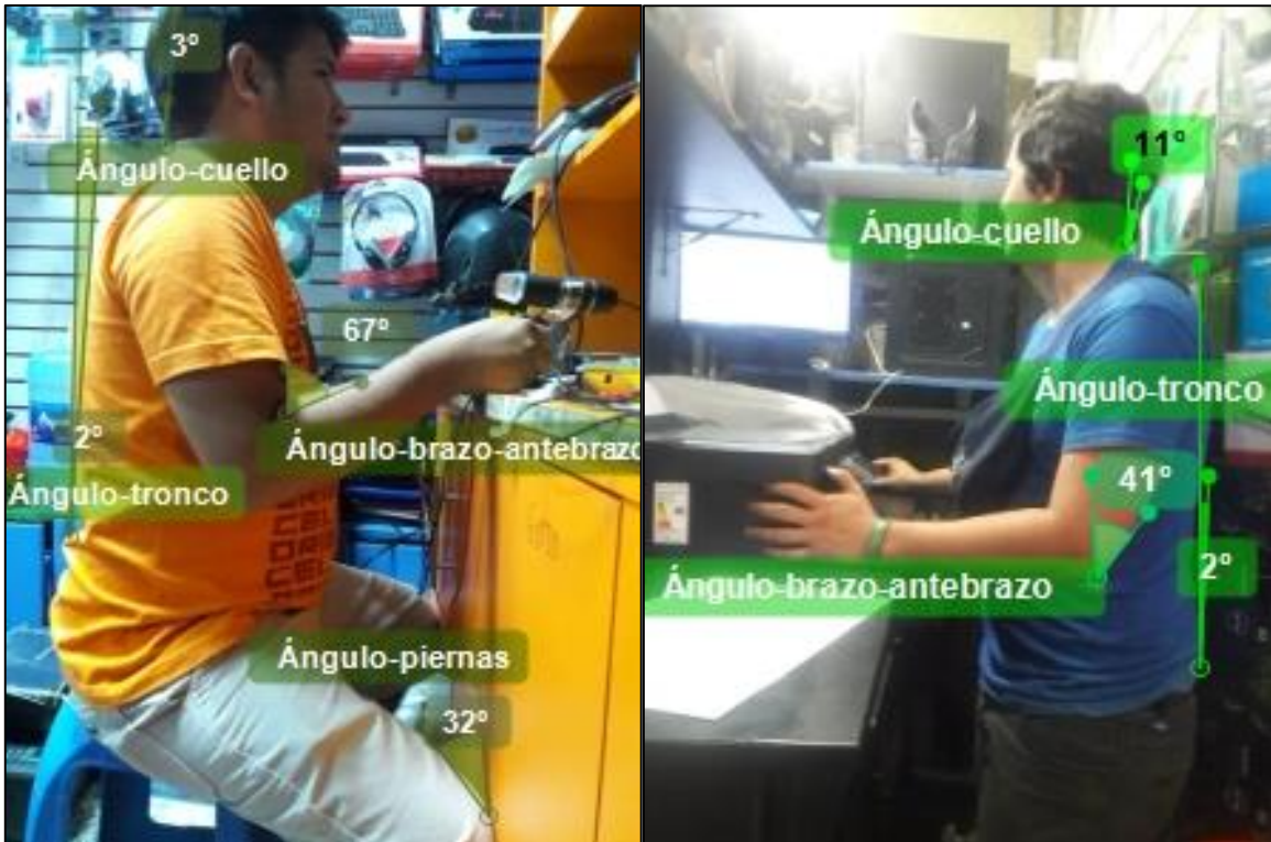
Figura 9 (13 y 14). Evaluación con el software Kinovea de la situación mejorada en el interior de la Galería – área de soporte técnico del trabajador 1 y 2 (POST-TEST).
