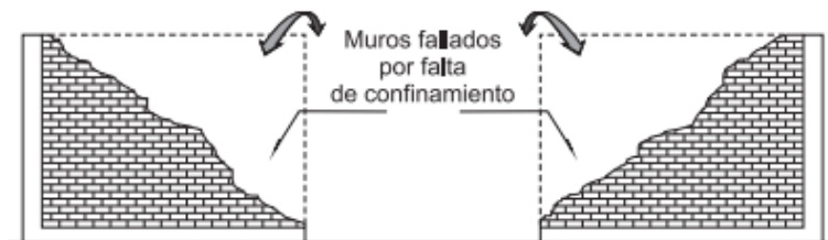
>>Fig 7.9a Falla típica en las puertas de garajes y su reforzamiento. Nótese que la falla es similar a las presentadas en la F-3.6 y F-3.7.
