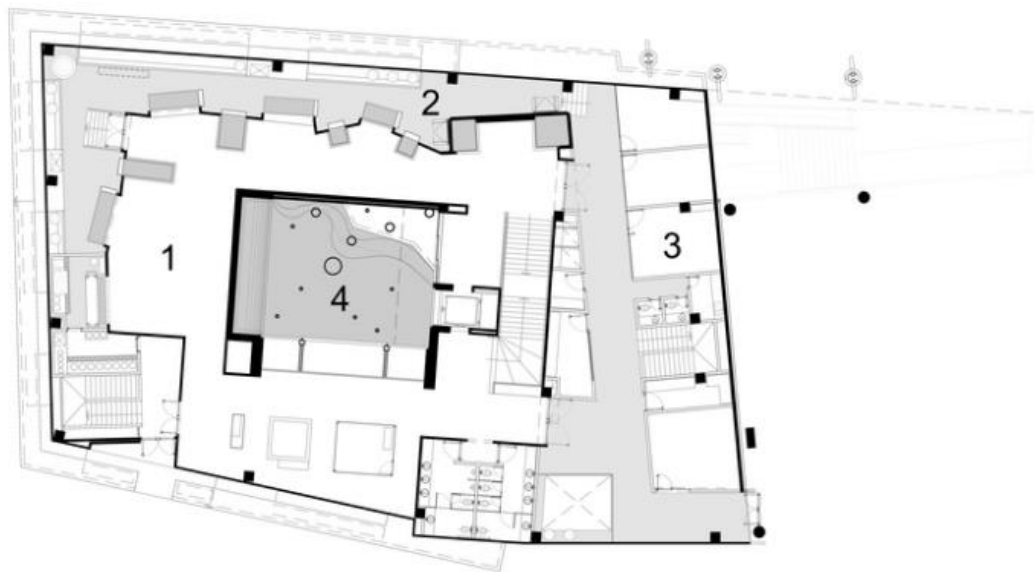
Planta N. -6.07. Piso 2. Agua Salada 1 Circulación Pública / 2 Circulación Técnica Agua Salada Acuario Agua Salada / 3 Oficina / 4 Selva Inundada
