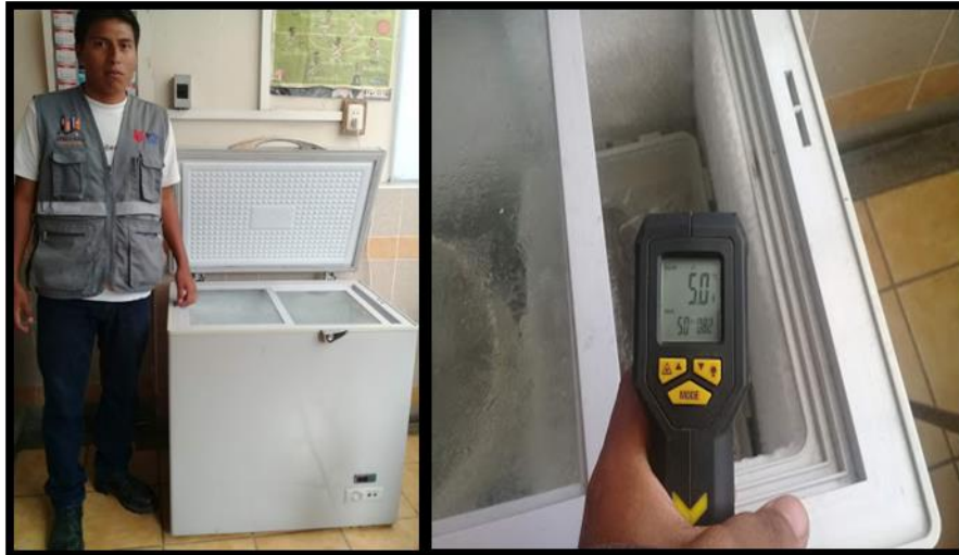
Figura 25: Cámara congeladora para simular climas fríos. Fuente: Elaboración propia.
