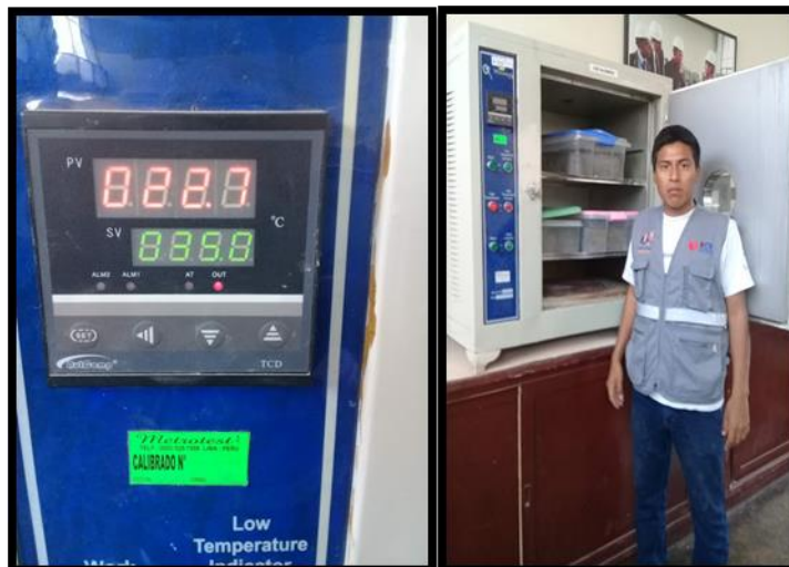
Figura 26: Cámara de curado para simular climas cálidos. Fuente: Elaboración propia.
