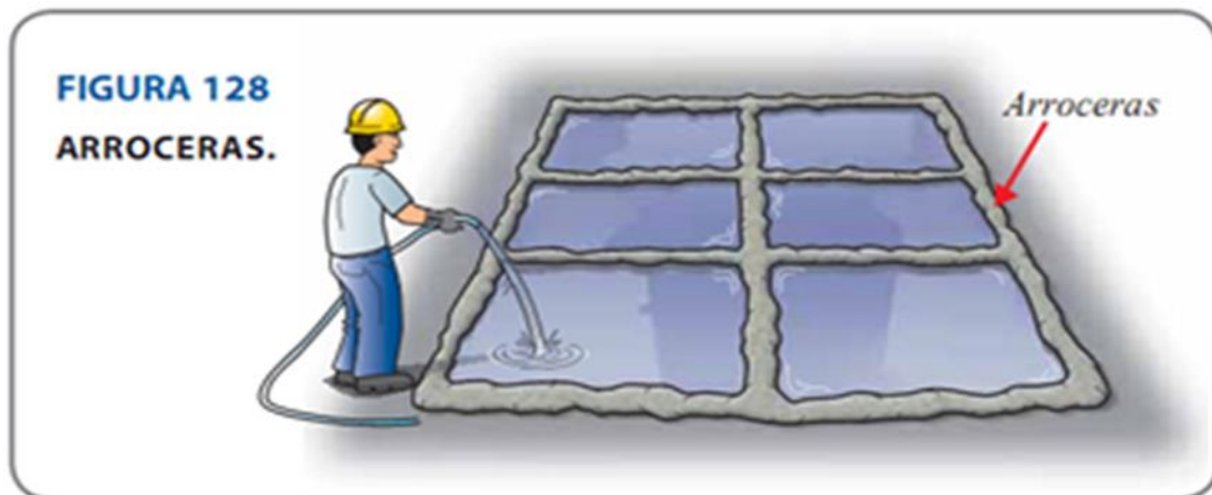
Figura 2: Curado de una losa con arroceras.
