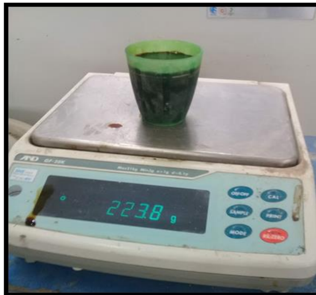
Figura 21: Medición del aditivo superplastificante
