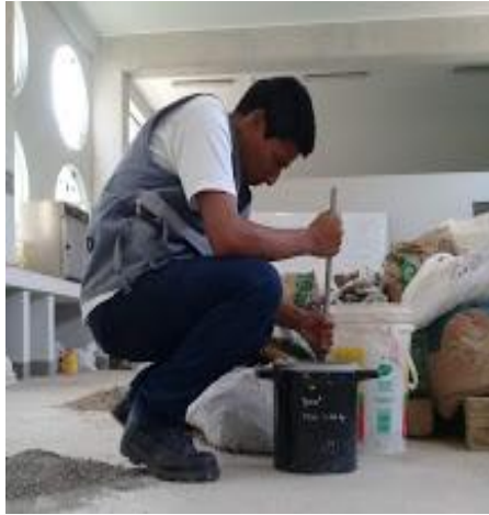
Peso unitario compactado – agregado grueso
