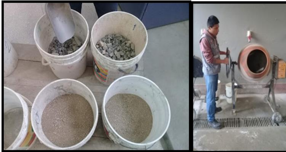
Figura 20: Preparación de concreto.
