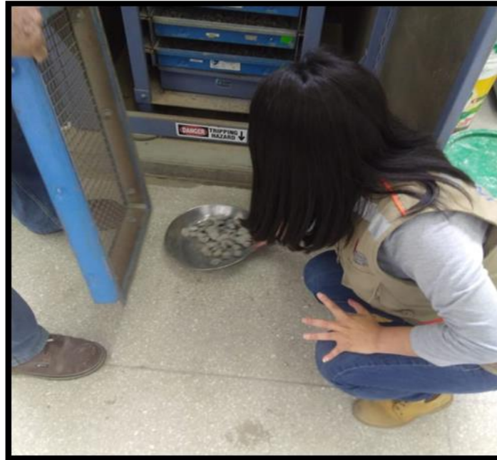
Figura 12: Agregado grueso puesta en la tamizadora por un lapso de 2min.
