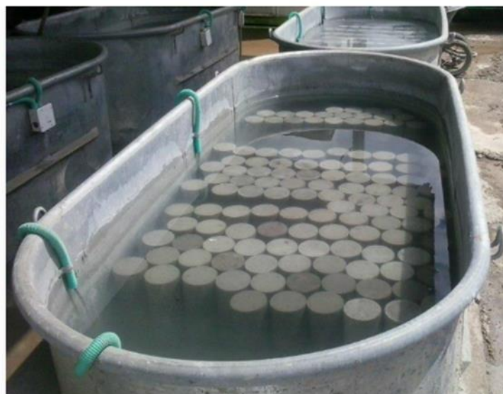
Figura 3: Curado de concreto en la construcción
