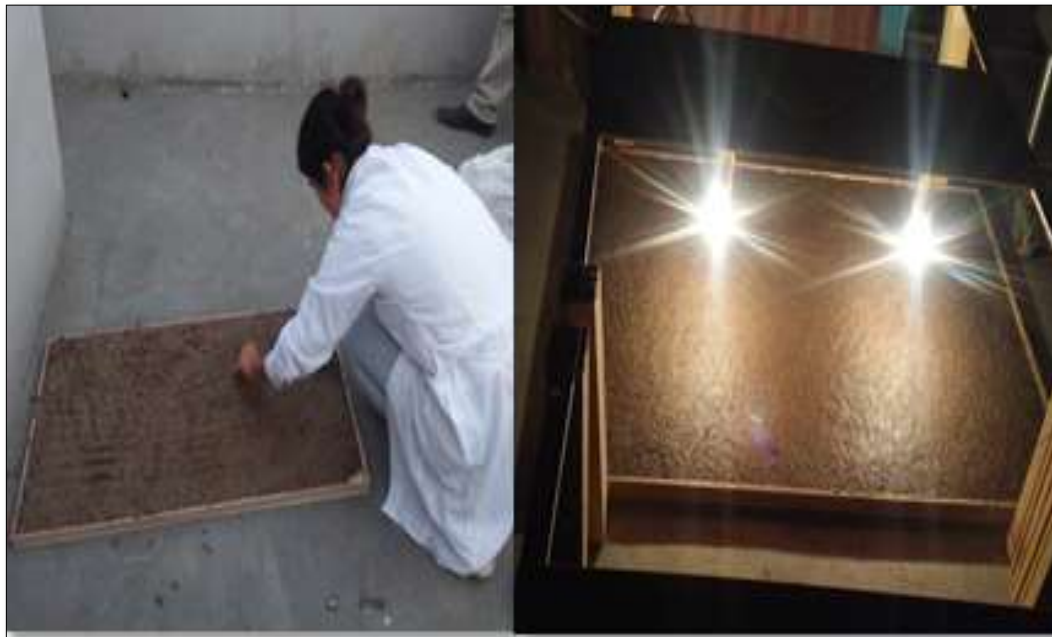
Figura 23. Homogenización de la mezcla y proceso de secado en incubadoras
