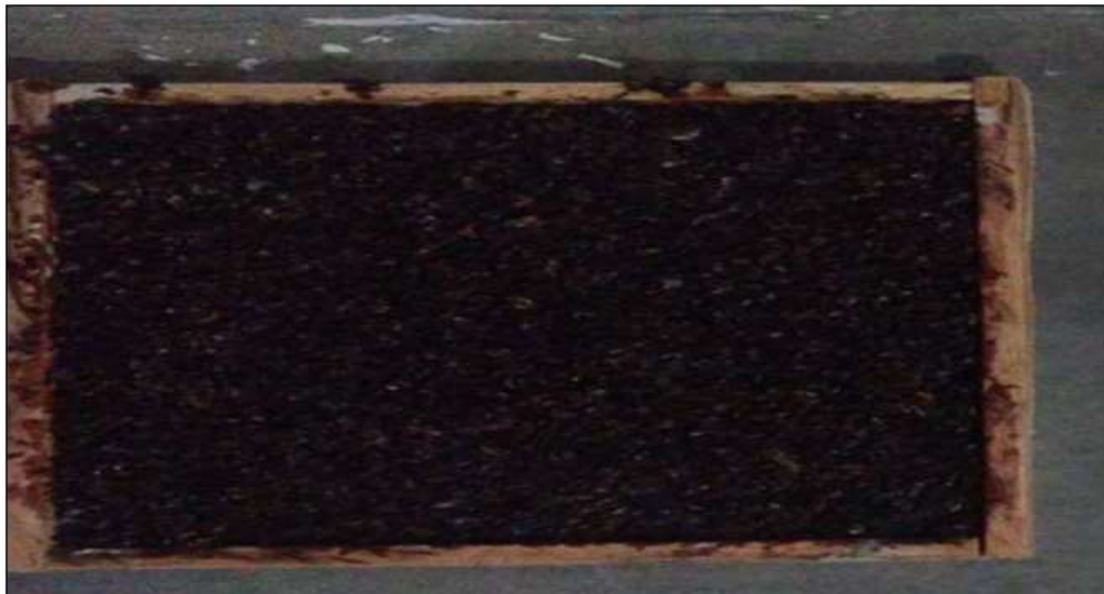
Figura 20. Compactación de tamaño de cisco de café de 2 mm en moldes de 1cm de espesor
