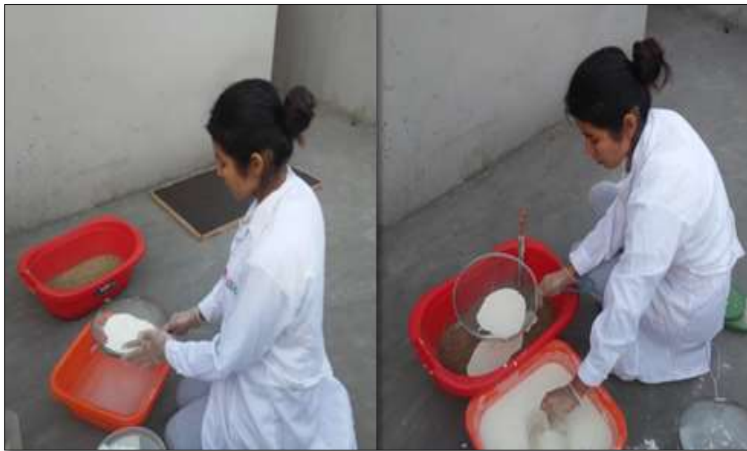
Figura 22. Cernido de harina con malla 1.5 mm y cernido de engrudo con malla 1 mm
