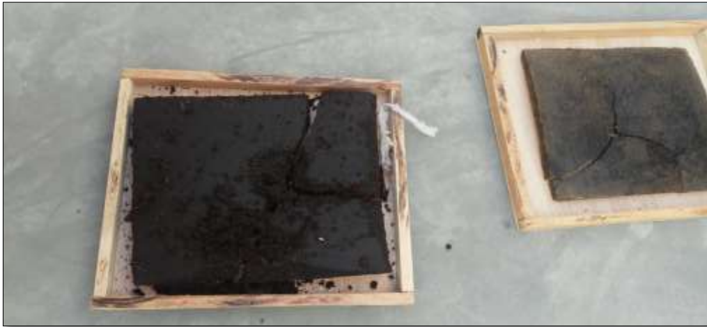
Figura 19. Compactación de tamaño de cisco de café de 1.5 mm en moldes de 1 y 2 cm de espesor
