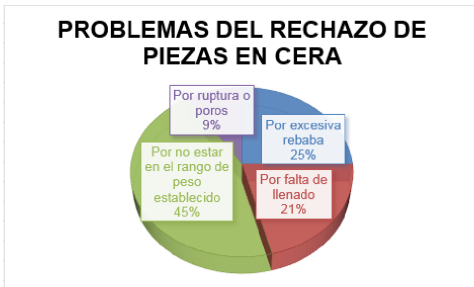
Gráfico 4. Porcentaje de los tipos de problemas más frecuentes que originan el rechazo de una pieza en cera
