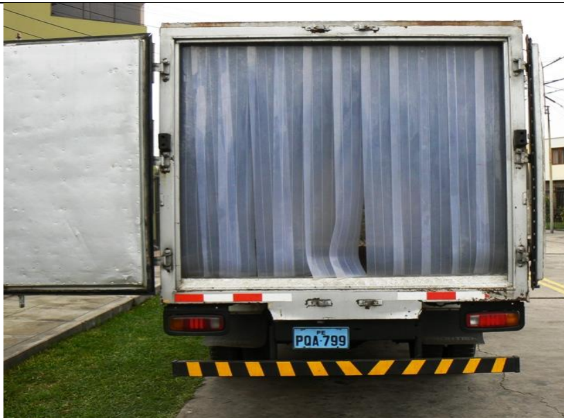
Figura 13 : Perspectiva posterior – Pediluvio de preservación de frío
