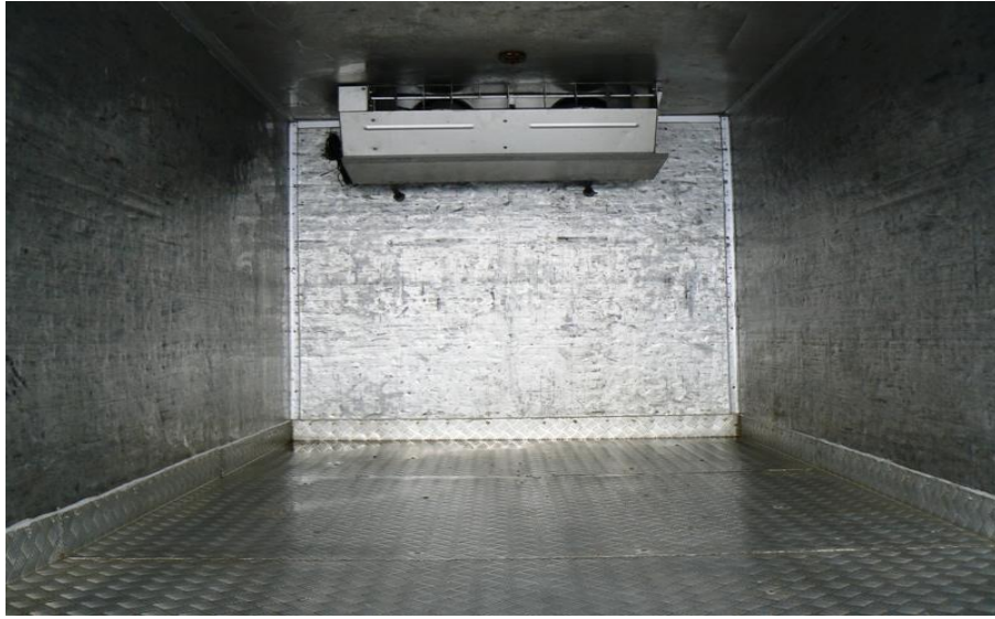
Figura 12 : Perspectiva interna – Cabina interna de carga
