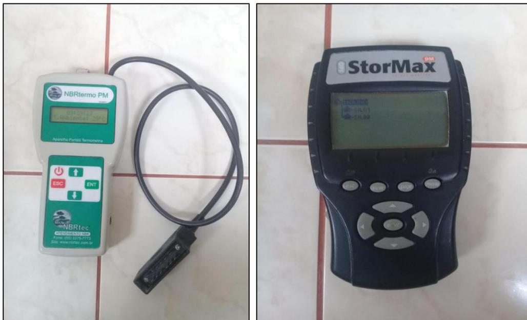
Figura 17. Equipo portátil para tomar la medida de la termometría de los silos.
