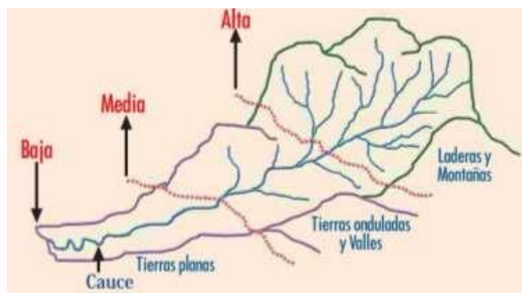
Figura 3-6: Elementos y partes principales de una cuenca. Fuente: Modelo de flujo de lodos y lodo. Gami3n (2014).
