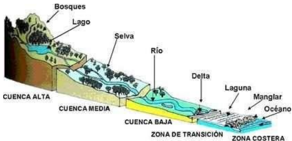
Figura 3-2: Vista tridimensional de una cuenca hidrográfica característica y sus partes. Fuente: Modelo de flujo de lodos y lodo. Gamión (2014).
