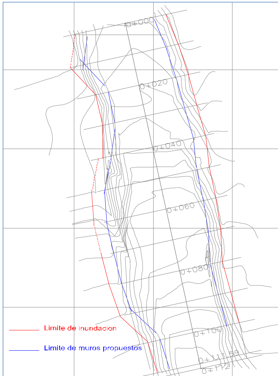
Figura 3-28: Demarcación de los muros de contención requeridos para la minimización de los efectos del flujo de lodos. Fuente: Elaboración propia.
