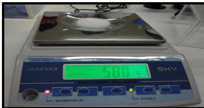
Figura 17: Balanza para pesar el porcentaje de arena reciclada que se va a utilizar para los morteros
