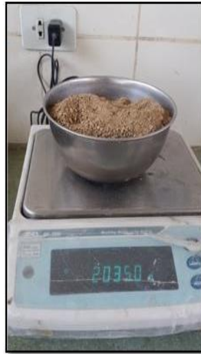
Figura 26: Ensayo de Porcentaje de Finos.
