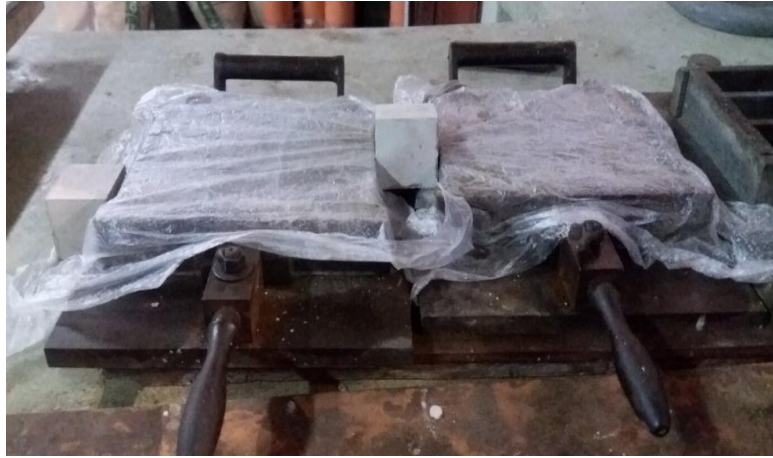
Figura 30: Moldes de cubos con muestras, protegidos con bolsa.
