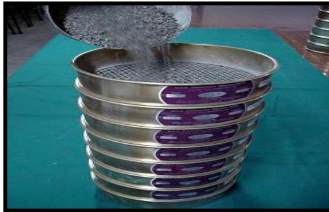
Figura 18: Tamices de aberturas de 0.074 mm, 0.149 mm, 0.50 mm, 1.00 mm, 1.68mm y 2.00 mm
