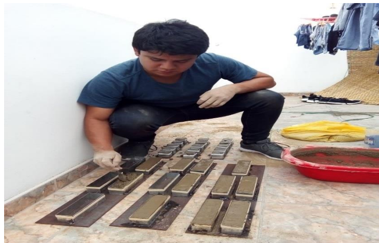
Figura 37: Concluyendo el llenado de los moldes para su análisis Fuente: Elaboración Propia
