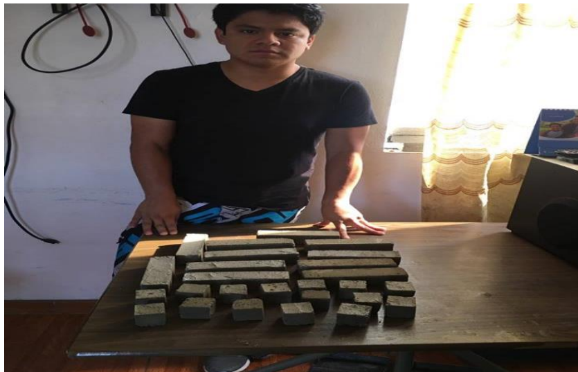
Figura 39: Bloques de mortero de los ensayos de compresión y flexión listos para el curado
