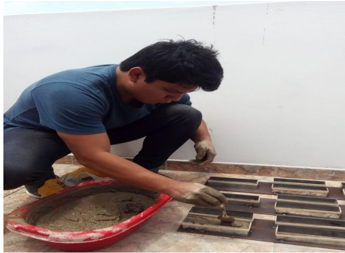
Figura 36: Llenado de mezcla a los moldes Fuente: Elaboración Propia
