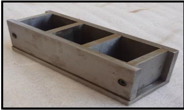
Figura 20: Moldes de mortero de 40 x 40 x 160 mm
