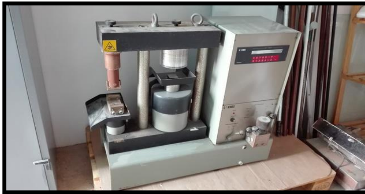
Figura 21: Máquina para ensayo de compresión y flexión del mortero
