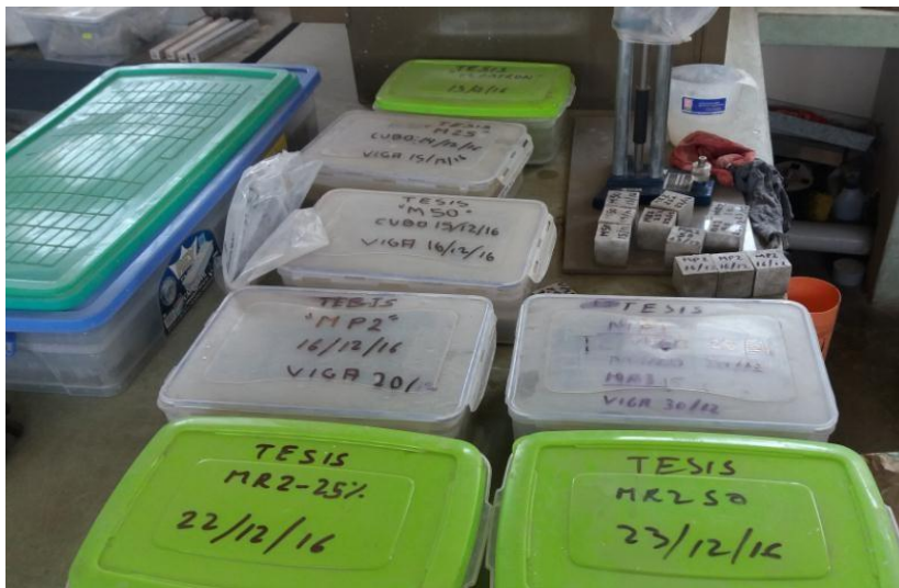
Figura 31: Moldes de vigas con muestras, protegidos con bolsa.
