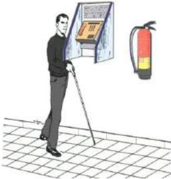
Figura 23 Mobiliario adosado a pared de forma incorrecta
