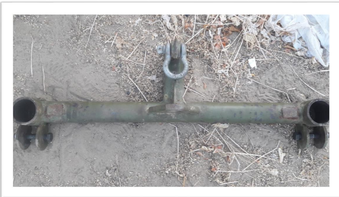
Ajustador superior de la estructura principal del perforador semi industrial y gancho para subir lo tubos de perforación.
