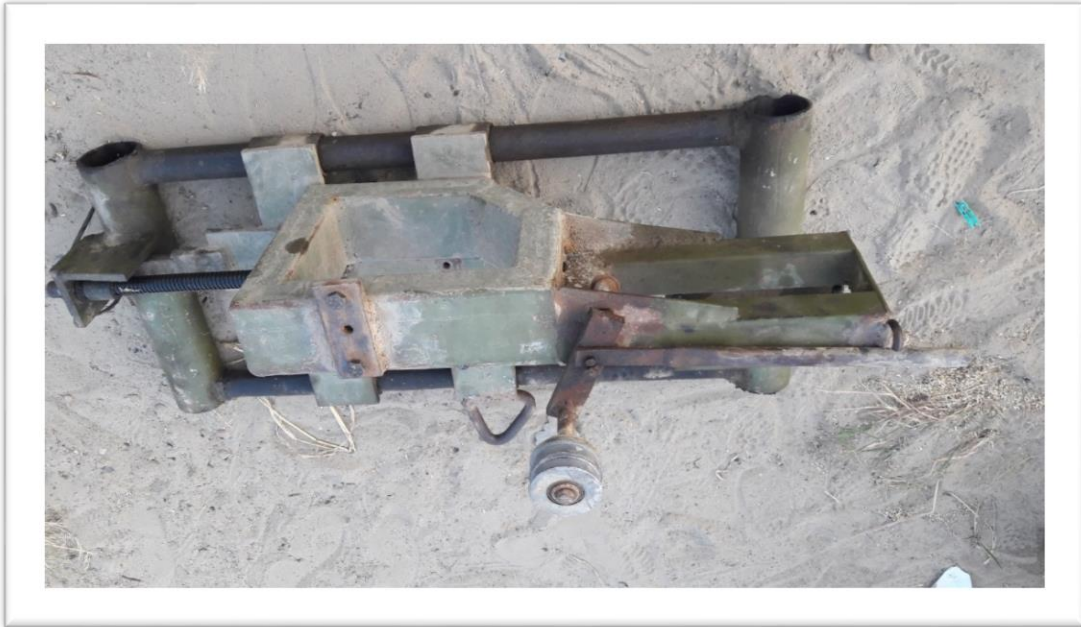
Torno mesa para el soporte del motor y reductor.
