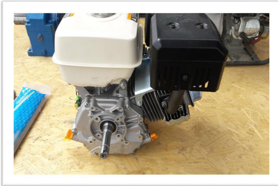
Motor Bonelly (420) utilizado para la rotación de los tubos de perforación.
