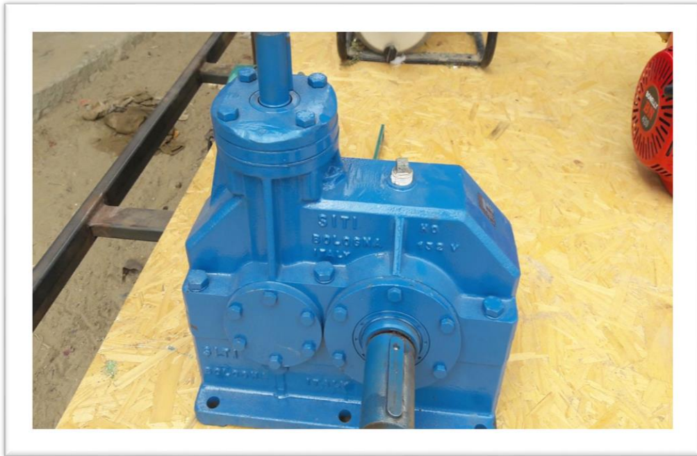
Reductor que permite dar la fuerza para realizar la perforación.
