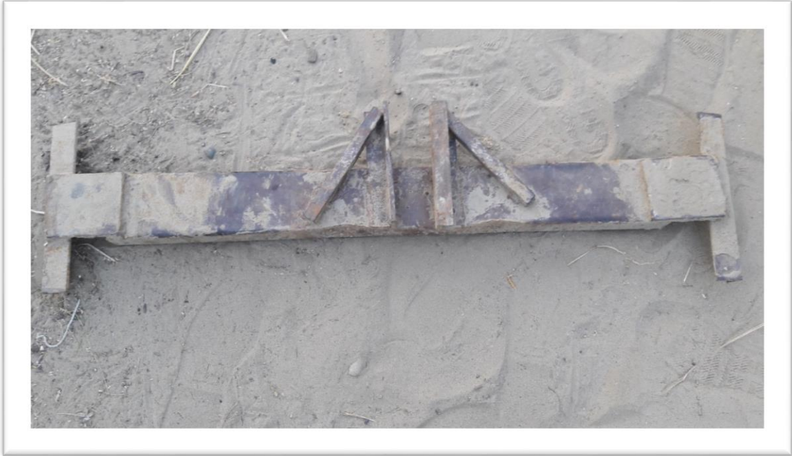
Sujetador para cambio de tubería del perforador semi industrial.
