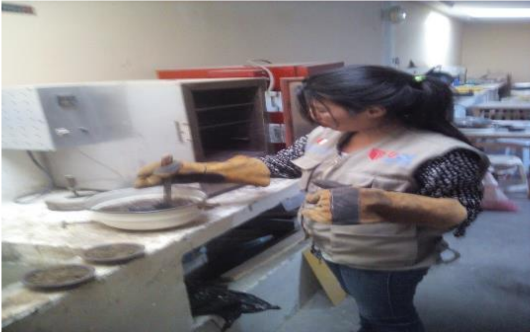
FOTO N°25: Después que se seca la muestra se expande con una espátula luego pesarla.
