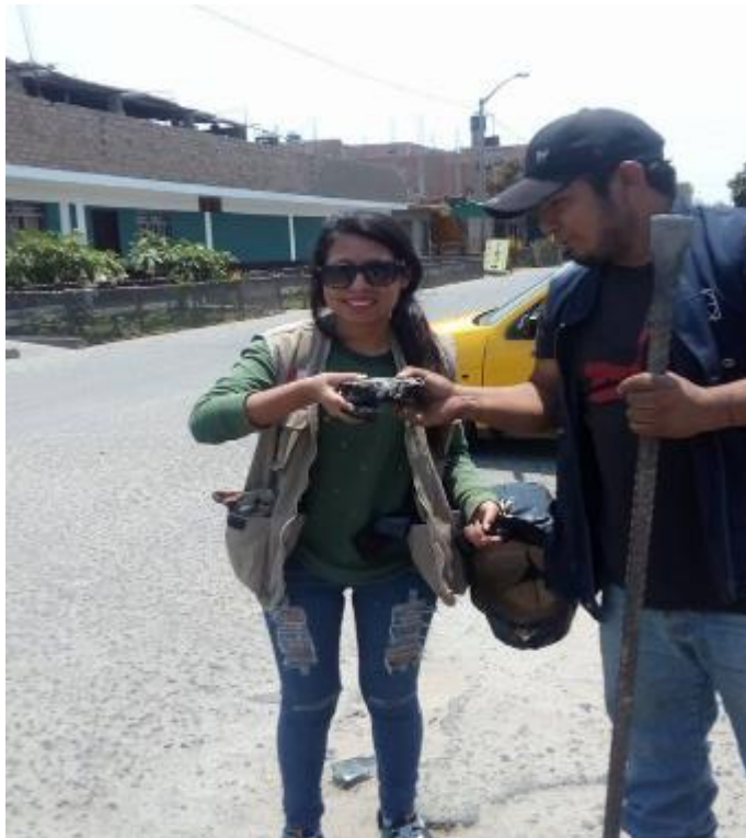
FOTO N° 10: Se procedió de partir un pedazo de asfalto para hacer el lavado asfáltico.
