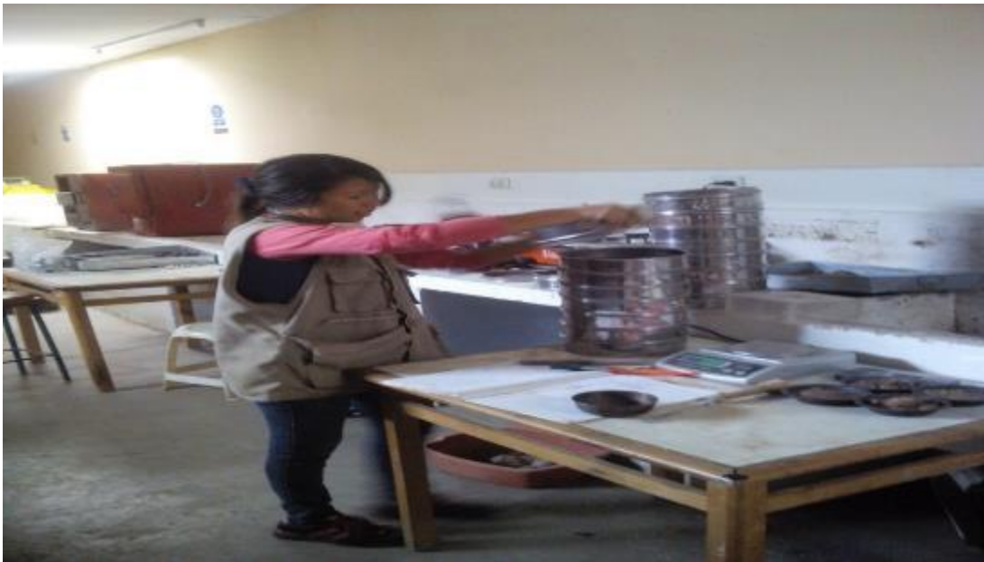
FOTO N° 13 Se pasa hacer el análisis granométricos de cada muestra extraídas de las calicatas en este caso como fue terreno natural se utilizó las mallas #4, #10, #16, #30, #40, #50, #100, #200, <200.
