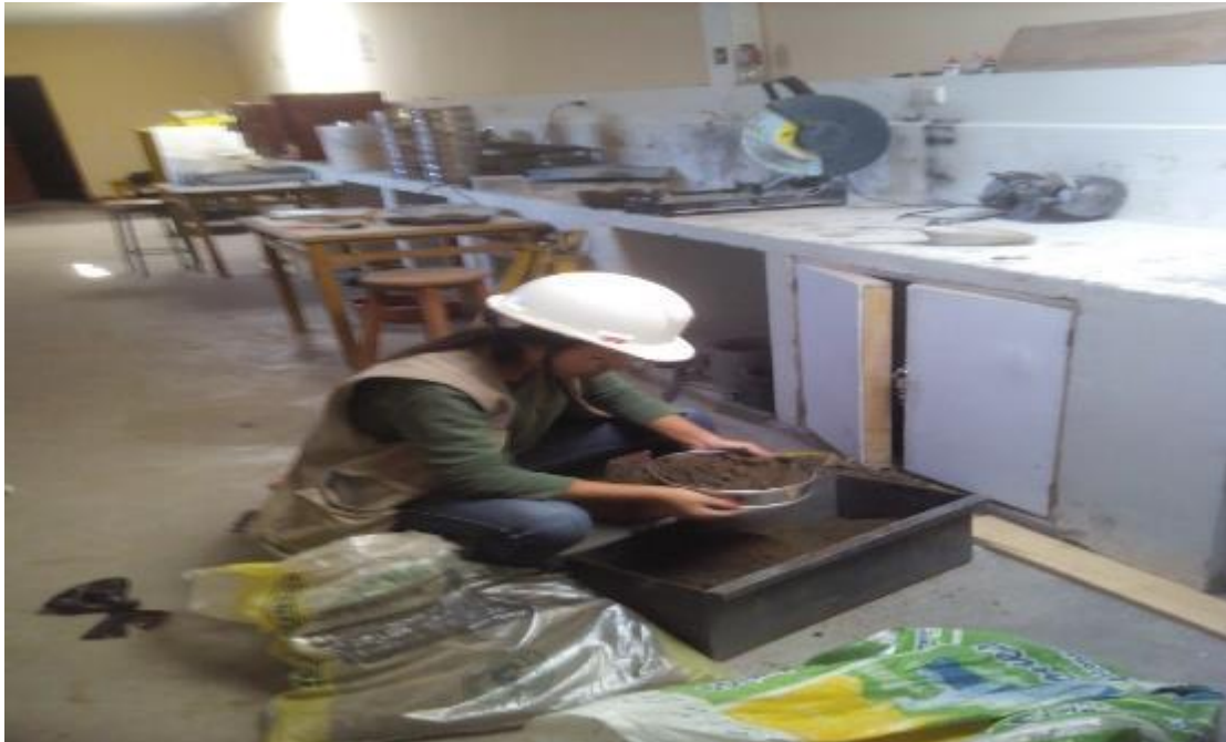
FOTO N°17 se procedió a realizar el CBR de lo cual se trajo una muestra de afirmado de 30 kg lo cual tamizamos con la malla #3/4.
