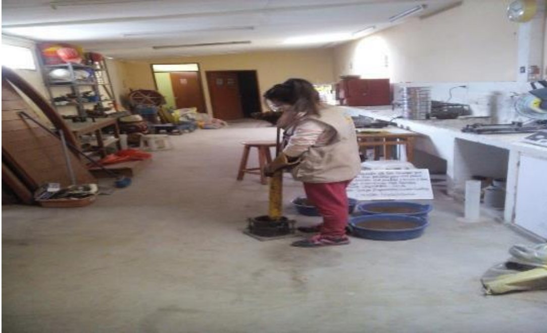
FOTO N°15: Luego se pasó a dar los numero de golpes en este caso como es terreno natural se dara 25 golpes de los 3 moldes de cada uno de 5 capas.
