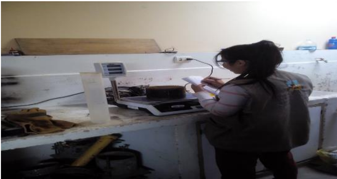
FOTO N°16: Luego se procede a pesar el molde con la muestra y se toma dato en el cuaderno para luego procederlo en la computadora todos los datos extraídos
