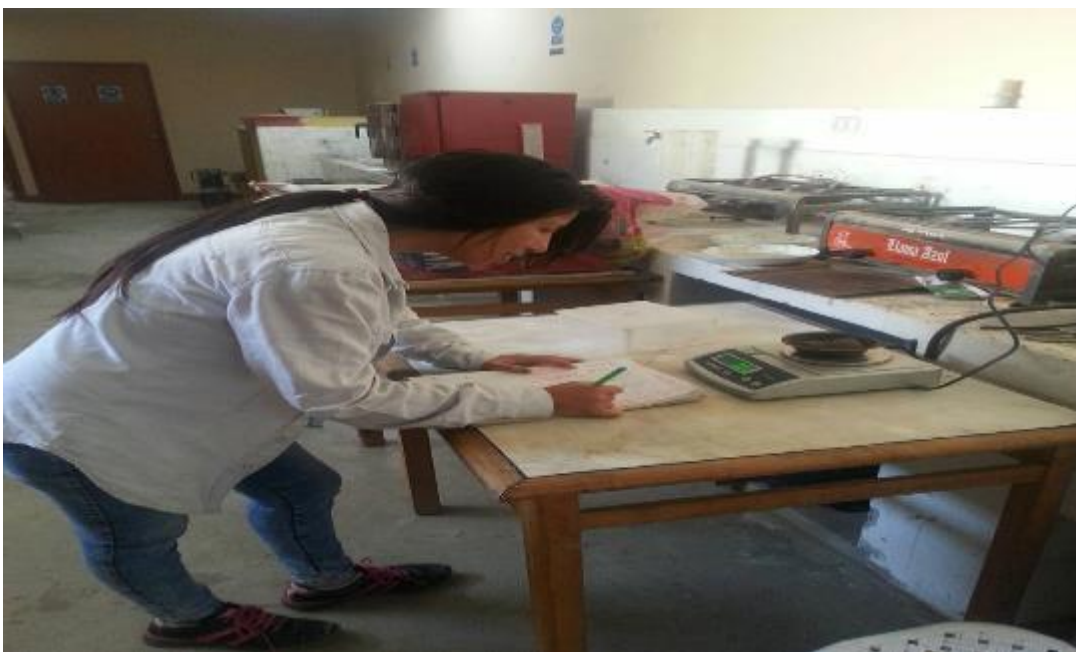
FOTO N° 11: Se realiza el ensayo de contenido de humedad de lo cual se extraes una muestra en una tara y luego se pesa en una balanza para tomar dato.
