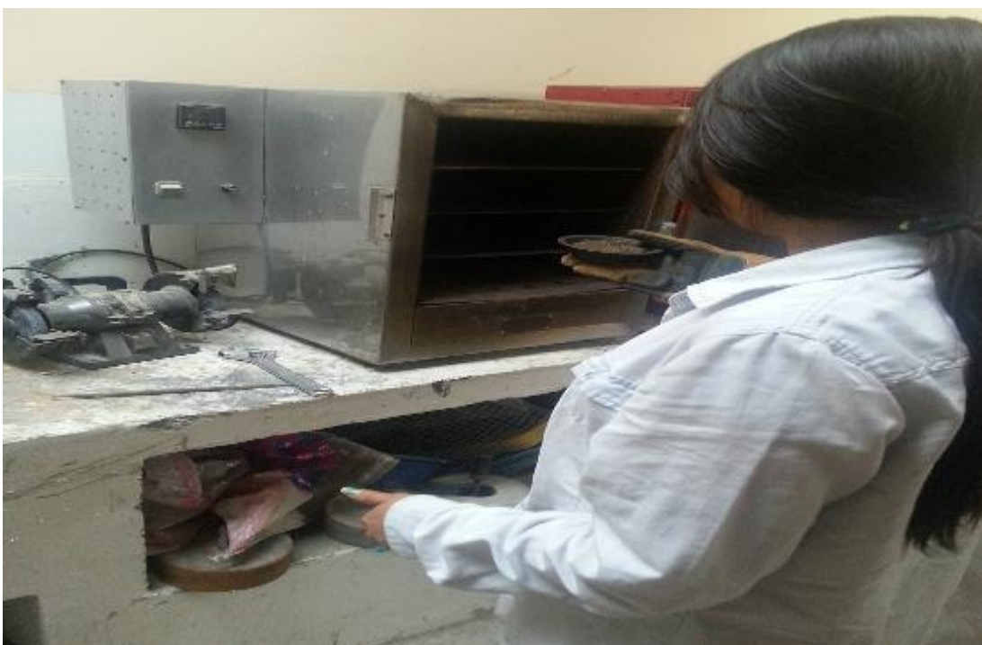
FOTO N° 12: Luego que se pesa el contenido de humedad se pasa al horno para secar la muestra 24 horas, lo cual tendrá una temperatura de 110 \pm 10 °C .
