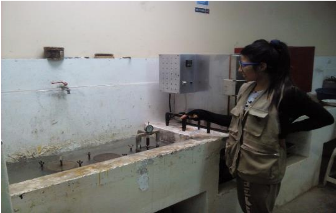
FOTO N°21 Luego se pasara a saturar el molde más muestra 96 horas esto quiere decir 4 días, en este caso se pondrá el expansimetro para tomar dato cada 24 horas.
