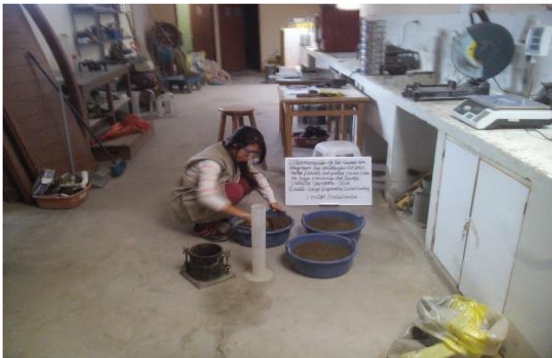
FOTO N°14 Luego se extrajo 30 kg de muestra del terreno de estudio, para tamizarlo y extraer 6kg en cada molde y adicionarlo agua a un porcentaje de 2%, 4% y 6%.
