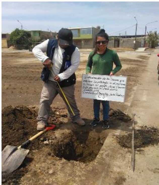
FOTO N° 6: Se procedió a medir la profundidad de la calicata con el técnico de laboratorio.
