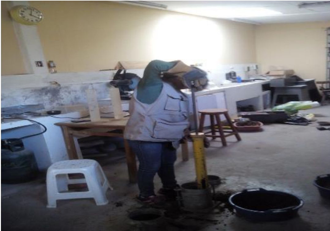
FOTO N° 19: Se realizó el número de golpes con el pisón de cada molde de #56, #25 y #12.
