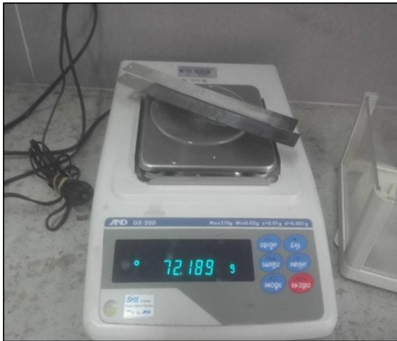
Figura N°9. Peso gastado de las placas de plata
