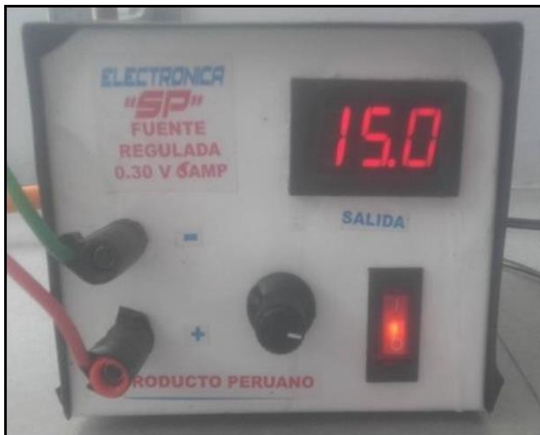
Figura N°13. Calibración del transformador a 15 V
