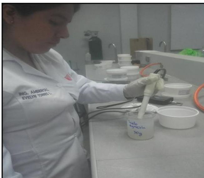
Figura N°26. Medición de conductividad con el equipo del conductímetro
