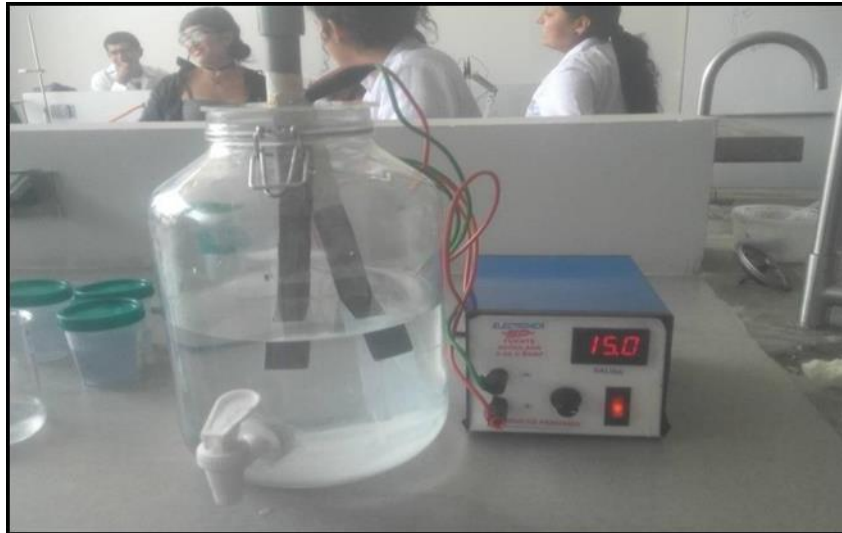
Figura N°11. Proceso de la electrólisis con las placas de plata
