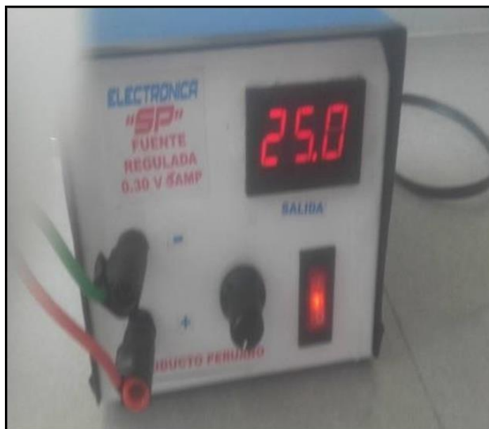
Figura N°15. Calibración del transformador a 25 V
