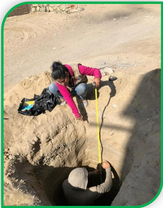
Foto n°29: Se visualiza a nuestro colaborador de apoyo midiendo los estratos encontrados en la Cn°02.
