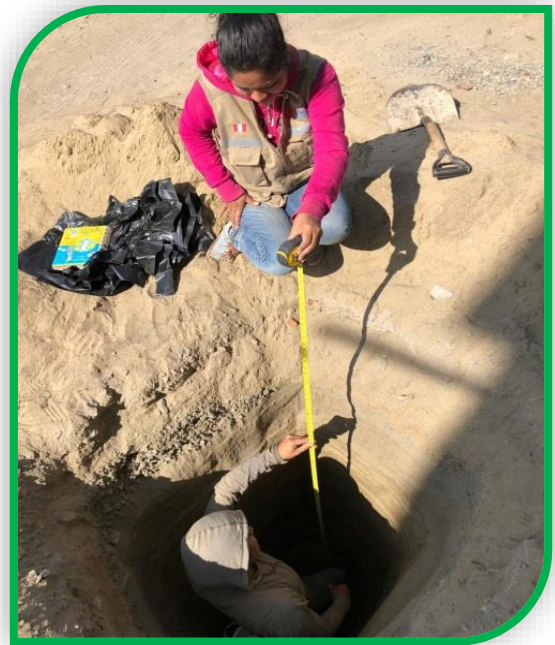
Foto n°33: Se visualiza a la alumna Vásquez Pérez Karen con su colaborador de apoyo midiendo los estratos encontrados en la Cn°02.
