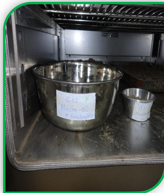
Foto n°51: Se visualiza las muestras secas para granulometría y contenido de humedad luego de ser retiradas del horno para su posterior pesaje.
