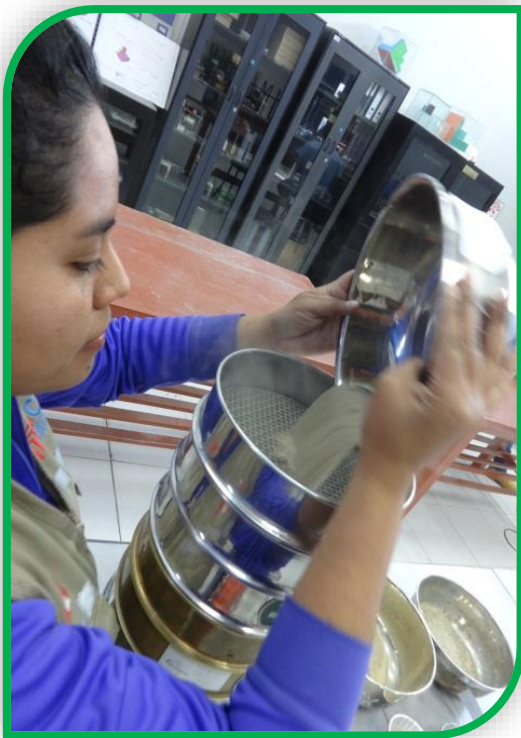
Foto n°77: Se visualiza a la alumna Vásquez Pérez Karen colocando la muestra ya pesada en los tamices para su posterior zarandeo.
