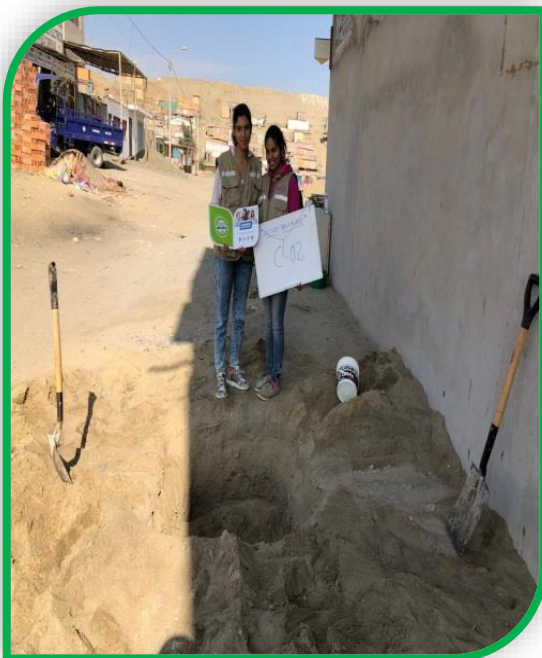
Foto n°35: Se visualiza el interior de la Cn° 02 donde en el proceso de excavación se encontró favorablemente una superficie maciza rocosa a los 2.20 m de profundidad.
