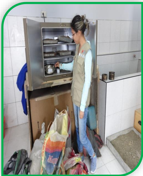
Foto n°50: Se visualiza las muestras húmedas para granulometría y contenido de humedad colocadas en el horno para su posterior secado.
