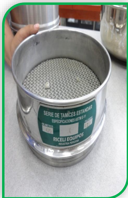
Foto n°77: Se visualiza a la alumna Vásquez Pérez Karen colocando la muestra ya pesada en los tamices para su posterior zarandeo.
