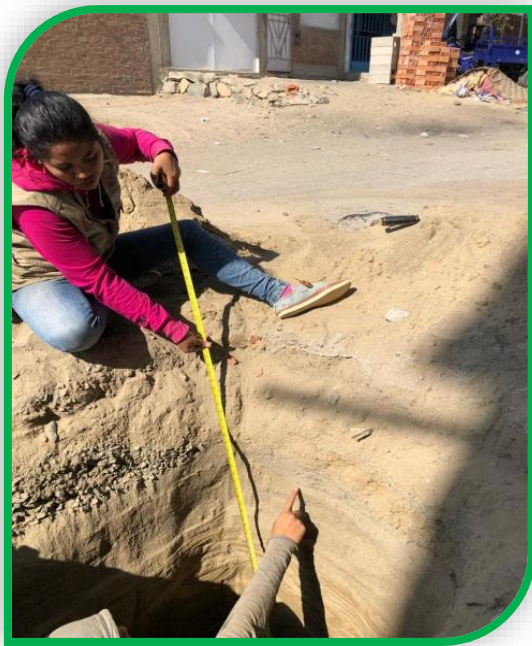
Foto n°32: Se visualiza a la alumna Vásquez Pérez Karen con su colaborador de apoyo midiendo la profundidad de la Cn°02 excavada.
