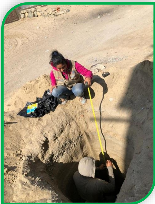
Foto n°29: Se visualiza a nuestro colaborador de apoyo midiendo los estratos encontrados en la Cn°02.
