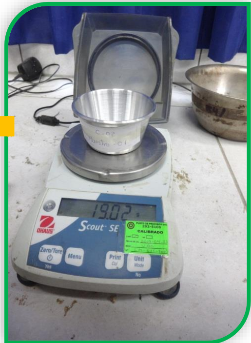
Foto n°57: Se visualiza el pesaje de la pequeña muestra húmeda extraída, el mismo proceso se realiza para las demás muestras obtenidas.
