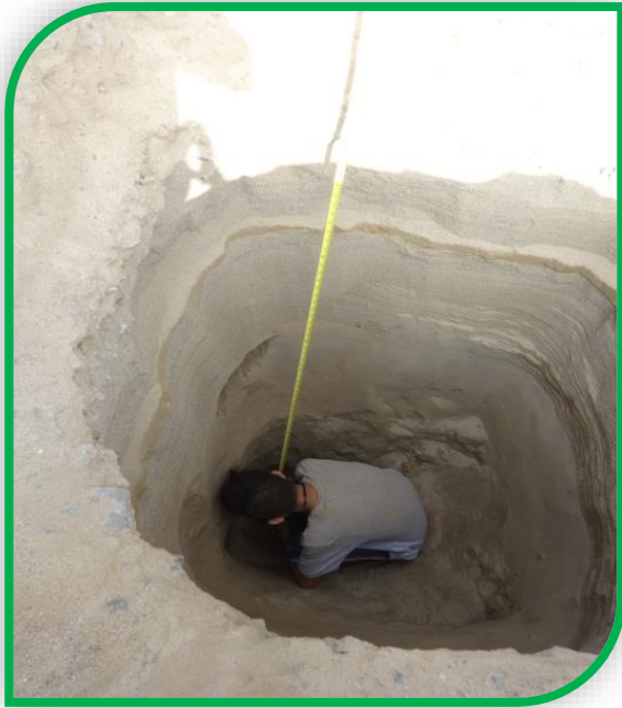
Foto n°11: Se visualiza a nuestro colaborador midiendo los diferentes estratos encontrados dentro de la Cn°01 .
