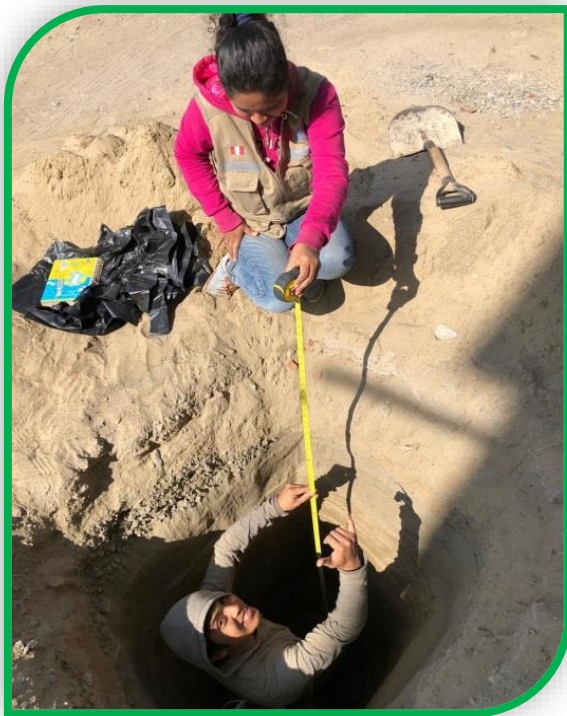
Foto n°35: Se visualiza el interior de la Cn° 02 donde en el proceso de excavación se encontró favorablemente una superficie maciza rocosa a los 2.20 m de profundidad.
