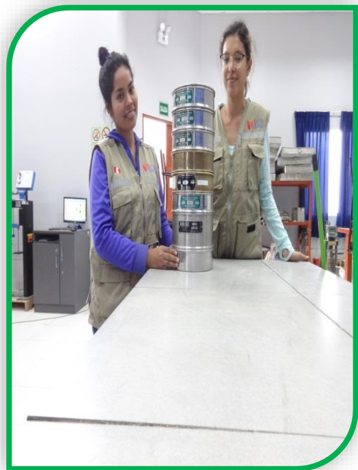
Foto n°75: Se visualiza a la alumna Vásquez Pérez Karen colocando la muestra ya pesada en los tamices para su posterior zarandeo de la muestra.
