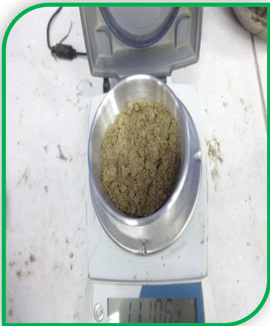
Foto n°59: Se visualiza a la alumna Vásquez Pérez Karen colocando la muestra húmeda en la tara para su posterior cuarteo.
