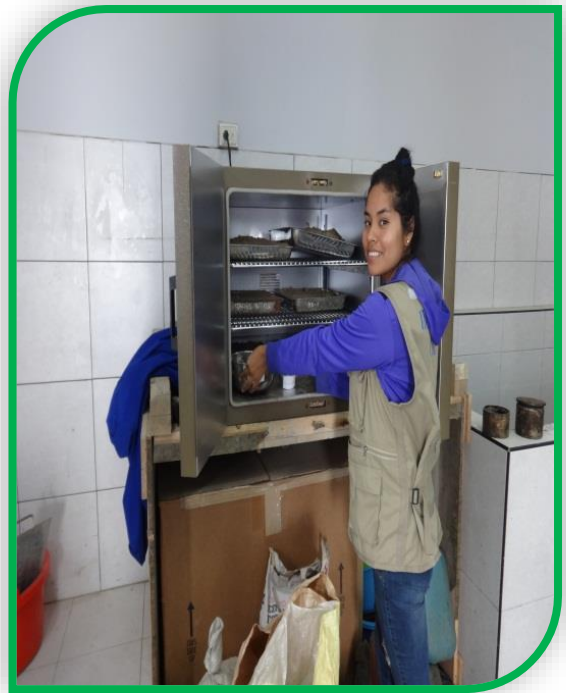
Foto n°54: Se visualiza a la alumna Ortiz Nakamura Alixon ingresando sus muestras húmedas en el horno para su posterior secado.
