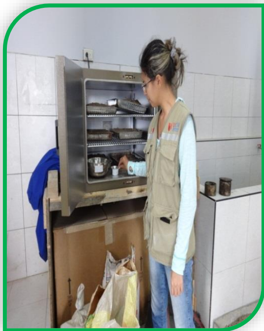
Foto n°53: Se visualiza a la alumna Vásquez Pérez Karen ingresando sus muestras húmedas en el horno para su posterior secado.
