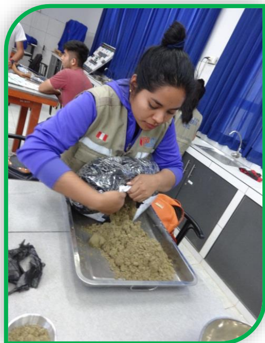
Foto n°60: Se visualiza a la alumna Vásquez Pérez Karen cuarteando la muestra húmeda para seleccionar la muestra a utilizar en el ensayo de granulometría.
