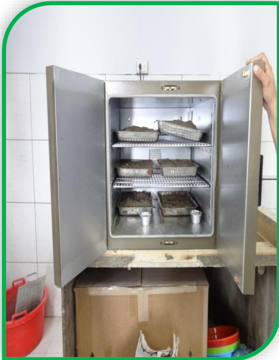
Foto n°47: Se visualiza a la alumna Vásquez Pérez Karen ingresando sus muestras húmedas en el horno para su posterior secado.
