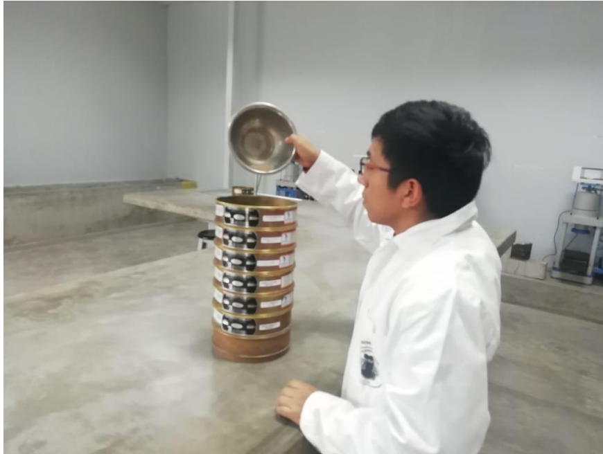
Foto 3. Ensayo de Granulometría en el Lab. De Suelo de la UCV
