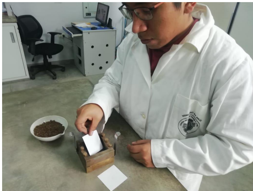
Foto 4. Ensayo de Corte Directo en el Lab. De suelo de la UCV
