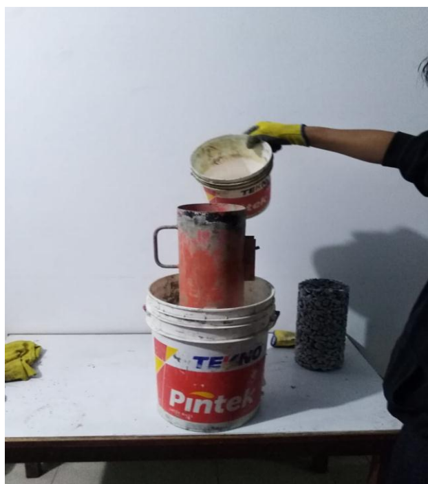
Figura N° 45 Echar agua hasta llenar la capa superior de la probeta y medir el tiempo de filtración.
