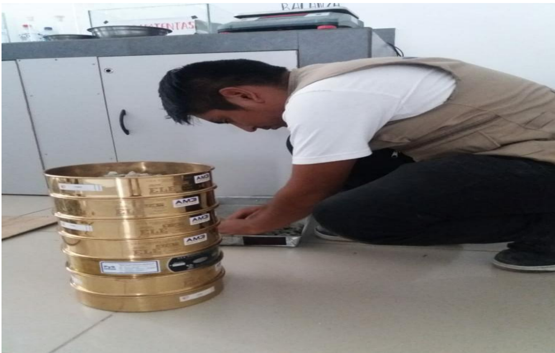
Figura N° 19 Se acomoda los tamices del \frac{3}{4} " hasta el N°4 y fondo.
