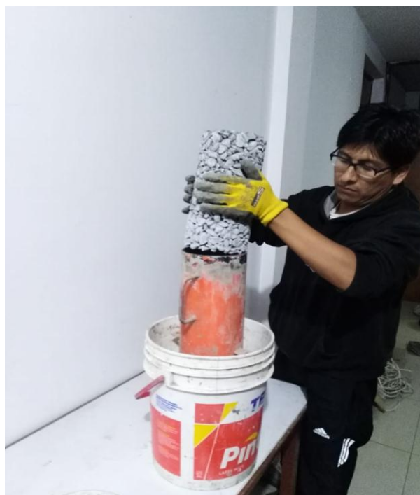
Figura N° 44 Colocar la muestra dentro del molde y los moldes dentro de un balde.
