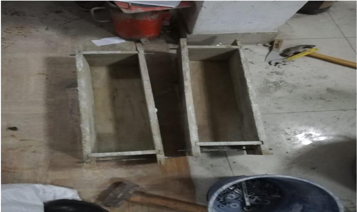
Figura N° 38 Limpieza de moldes con petróleo de dimensiones de (15 cm x 15cm x 50cm).
