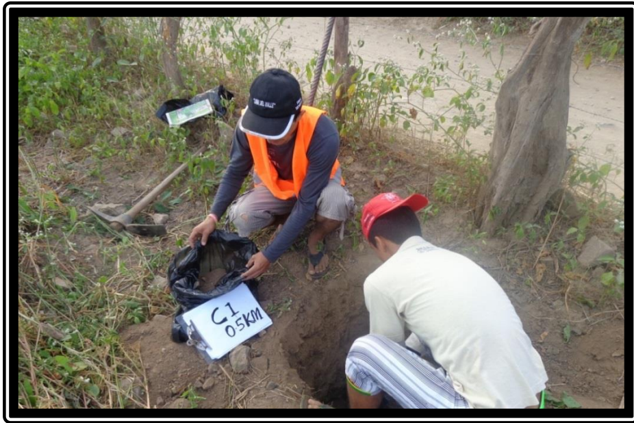
FOTO N° 05 excavación de calicatas para análisis de suelo.
