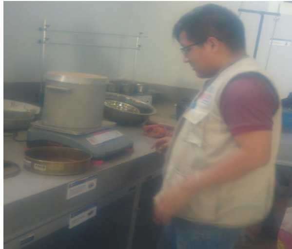
Figura 27. Peso de la muestra del ensayo de Peso Unitario suelto del agregado fino
