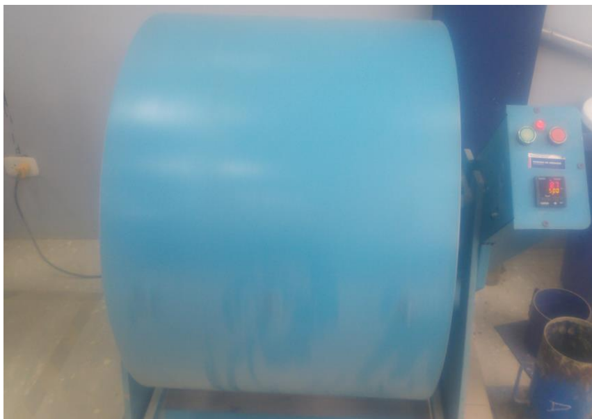
Figura 9. Máquina de Los Ángeles para el ensayo del desgaste por abrasión
