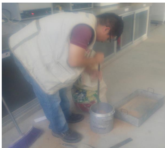
Figura 28. Ensayo de Peso Unitario compactado del agregado fino
