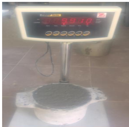
Figura 41. Muestra para el peso unitario de concreto fresco
