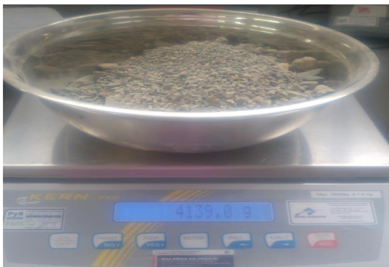
Figura 12. Peso final de la muestra del agregado grueso de la cantera la victoria - Patapo después de realizado el ensayo del desgaste de abrasión
