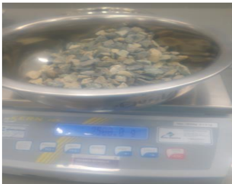
Figura 7. Peso de la muestra del agregado grueso de 1/2" para el ensayo del desgaste de abrasión
