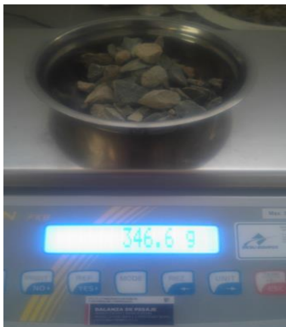
Figura 20. Muestra del peso del ensayo de contenido de humedad del agregado grueso
