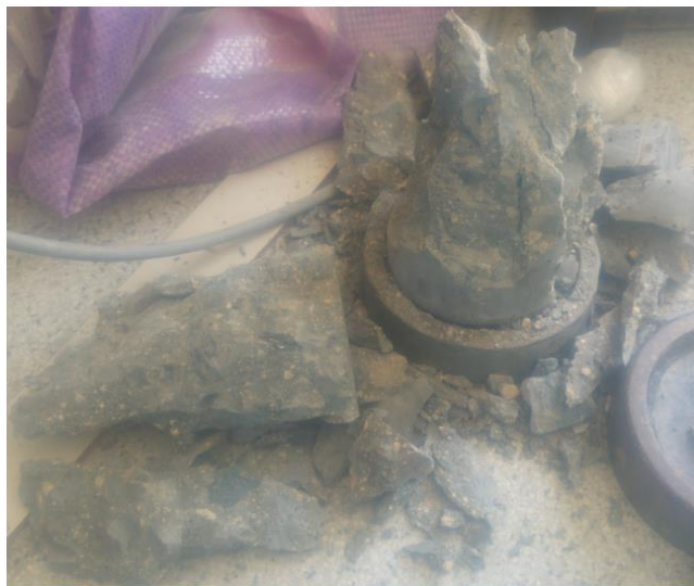
Figura 36. Sección de rotura de un Concreto de Alta Resistencia
