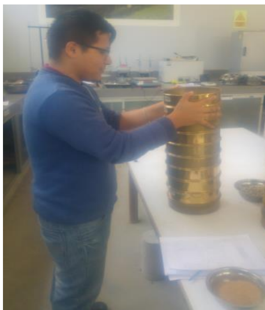
Figura 24. Ensayo granulométrico del agregado fino y grueso por los tamices correspondientes
