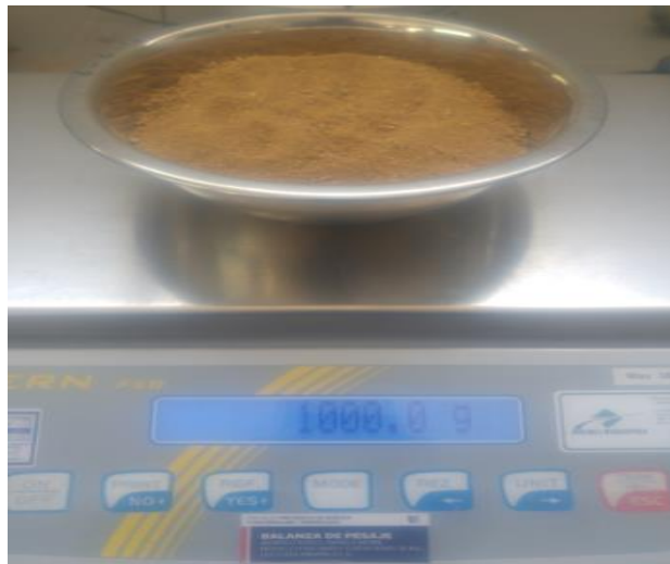
Figura 23. Muestra para la realización del ensayo granulométrico del agregado fino
