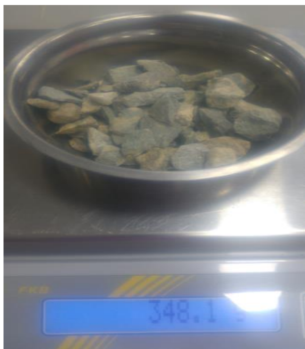
Figura 19. Muestra del peso antes de realizado el ensayo de contenido de humedad del agregado grueso
