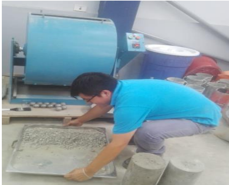
Figura 10. Muestra del agregado grueso después de realizado el ensayo de abrasión
