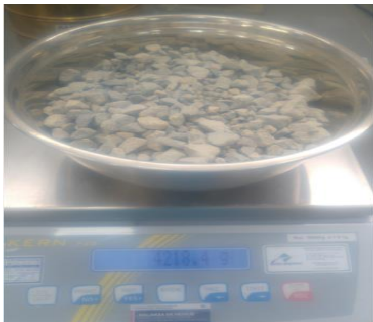
Figura 11. Peso final de la muestra del agregado grueso de la cantera tres tomas – Ferreñafe despues de realizado el ensayo del desgaste por abrasión
