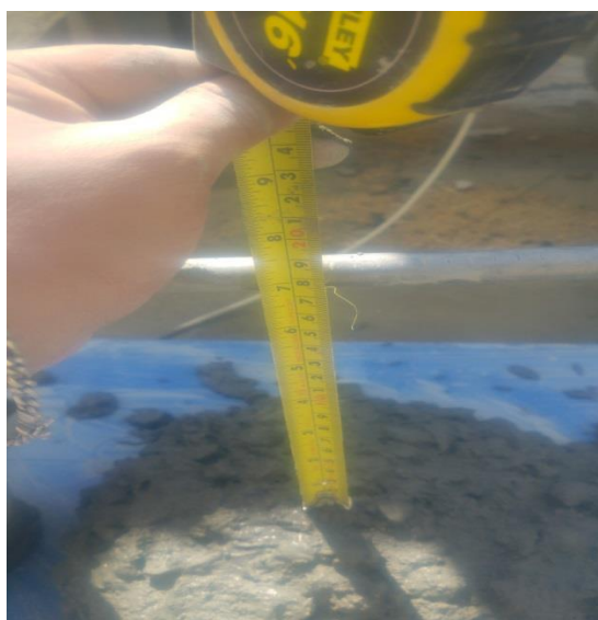
Figura 40. Verificación del asentamiento del diseño de mezcla de un concreto de alta resistencia
