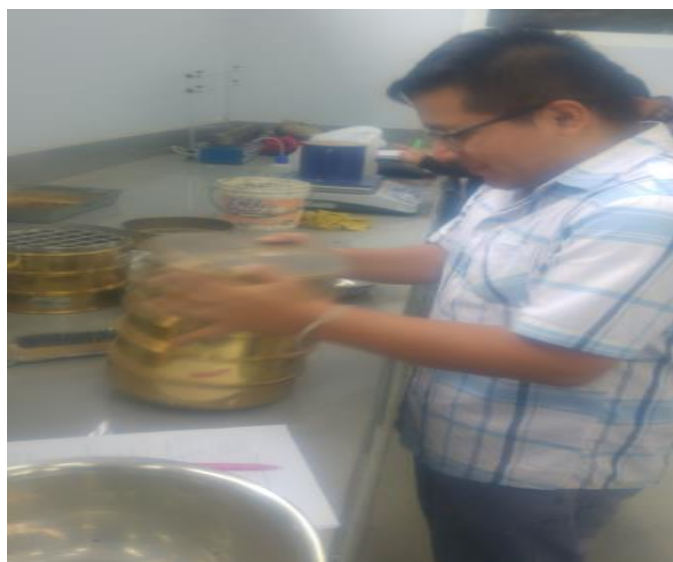
Figura 14. Ensayo granulométrico del agregado fino y grueso por los tamices correspondientes
