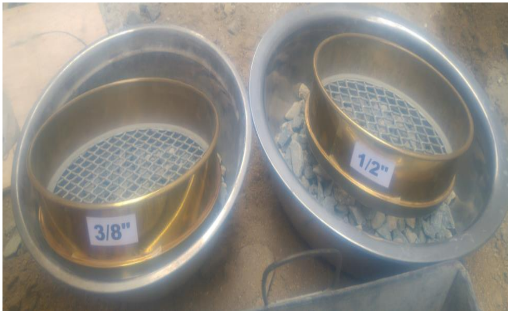
Figura 6. Tamizado de la muestra del agregado grueso de 3/8 y 1/2 para el ensayo del desgaste por abrasión
