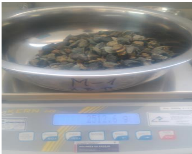
Figura 21. Peso de la muestra luego de estar saturada por 24 horas
