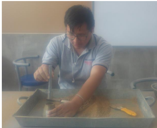
Figura 32. Muestra seca para realizar el ensayo de peso específico y absorción del agregado fino
