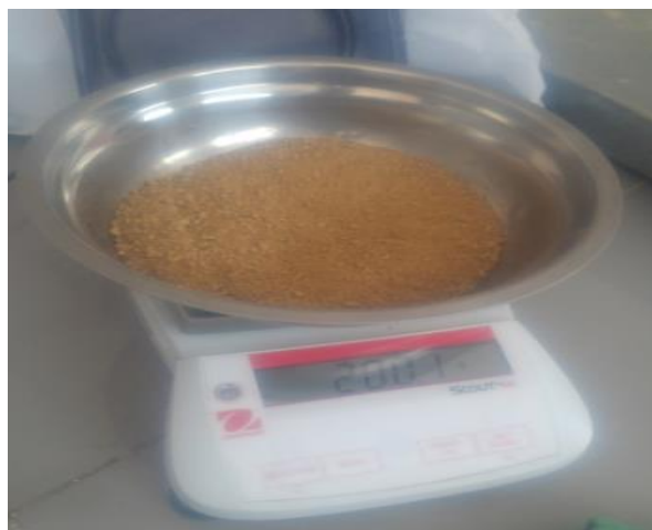
Figura 33. Peso de la muestra para el ensayo de peso específico y absorción del agregado fino
