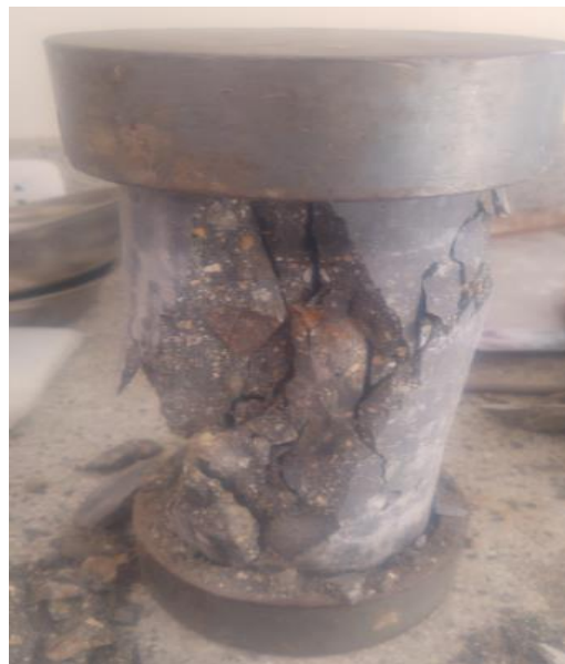
Figura 44. Probeta de 4"x8" luego de ser ensayada
