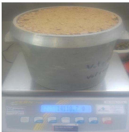
Figura 29. Peso de la muestra del ensayo de Peso Unitario compactado del agregado fino
