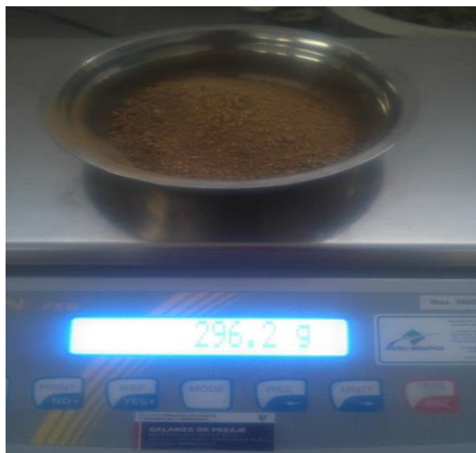
Figura 31. Muestra del peso del ensayo de contenido de humedad del agregado fino
