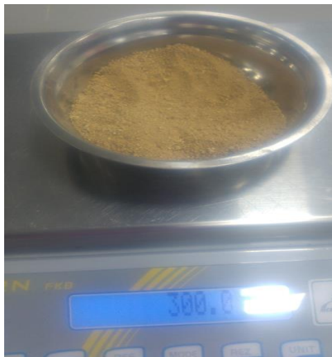
Figura 30. Muestra del peso antes de realizado el ensayo de contenido de humedad del agregado fino
