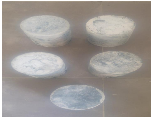
Figura 43. Probetas de 4"x8" secas para ser ensayadas
