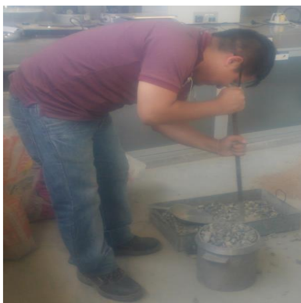
Figura 17. Ensayo de Peso Unitario compactado del agregado grueso
