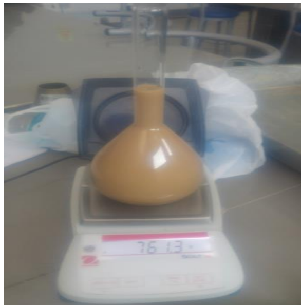
Figura 35. Muestra de la fiola sin aire del ensayo de peso específico y absorción del agregado fino
