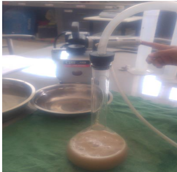
Figura 34. Momento del retiro del contenido de aire de la fiola
