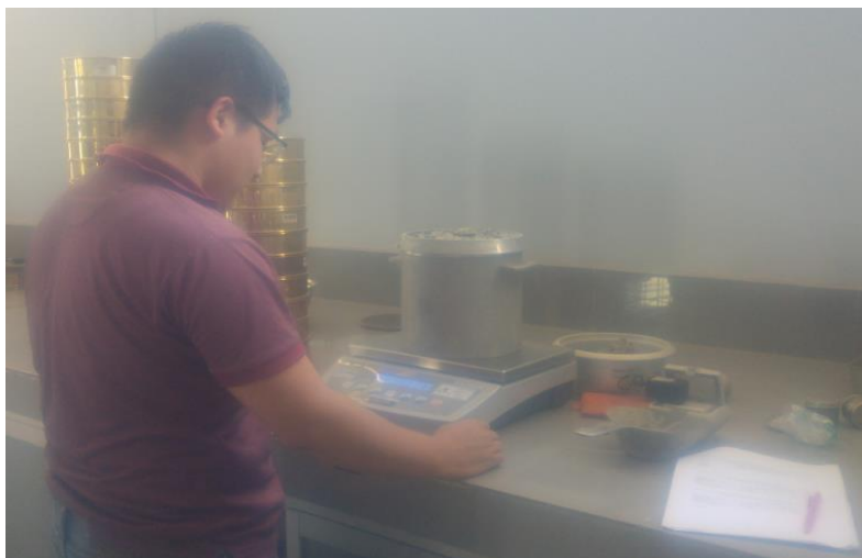
Figura 16. Muestra del ensayo de Peso Unitario suelto del agregado grueso
