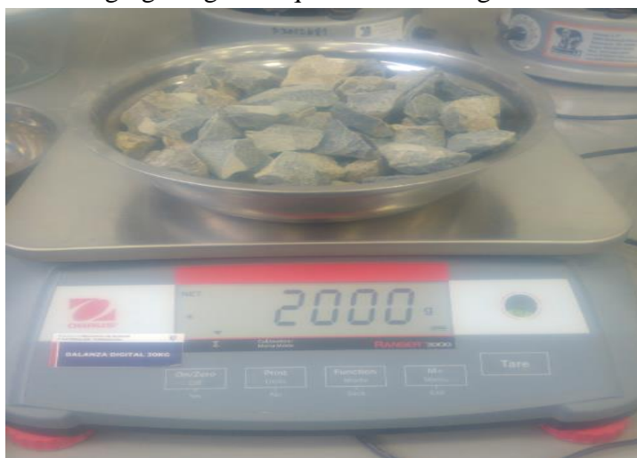
Figura 13. Muestra para la realización del ensayo granulométrico del agregado grueso
