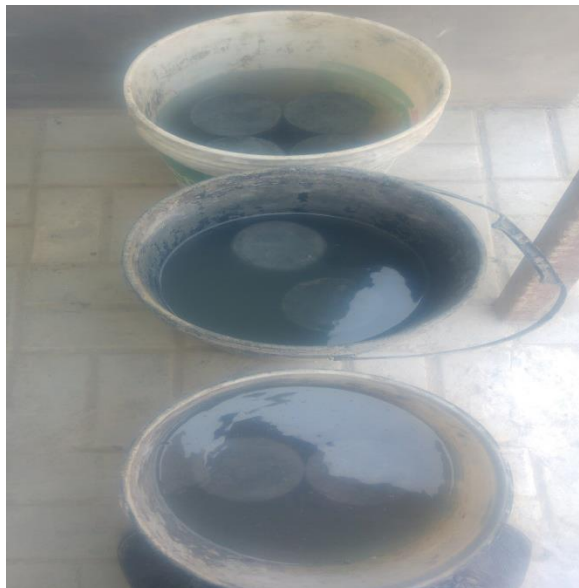
Figura 42. Curado de probetas
