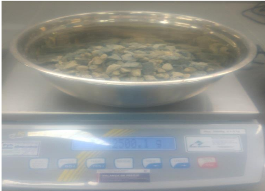
Figura 8. Peso de la muestra del agregado grueso de 3/8" para el ensayo del desgaste de abrasión
