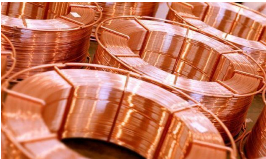
Figura 13: Soldadura de alambre Misfil N° 1.2 mm
