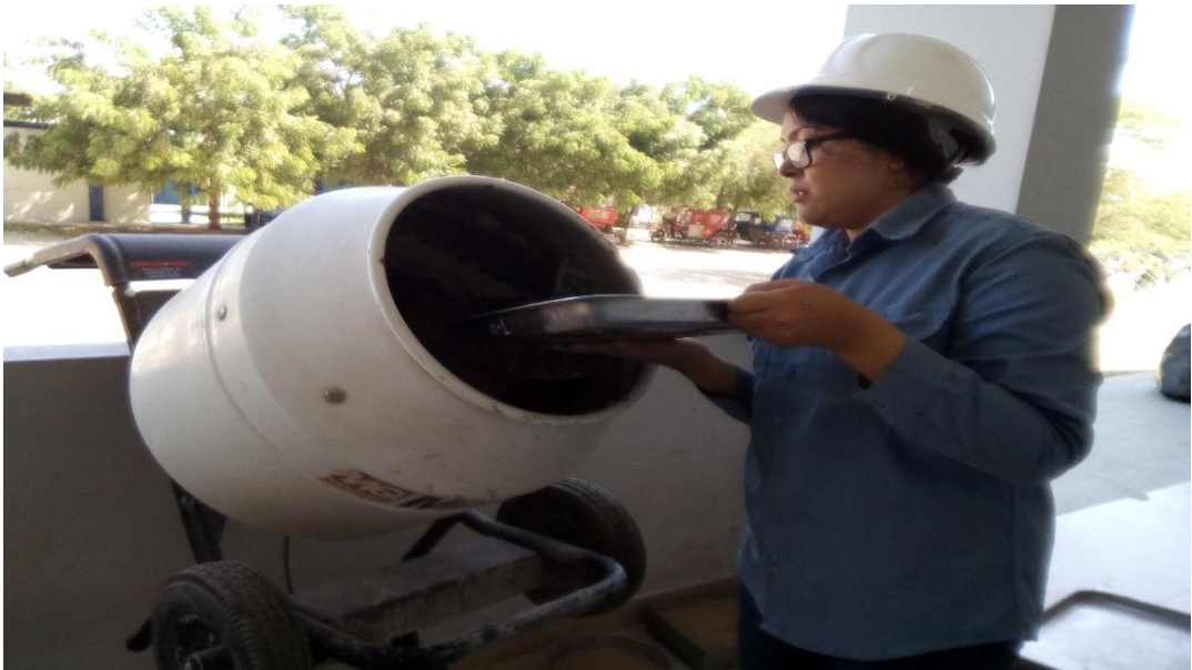
Fotografía N°14: Elaboración del concreto a base de papel reciclado.
