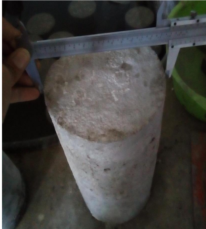
Fotografía N°21: Midiendo el diámetro del testigo de concreto a base de papel reciclado (Papercrete).
