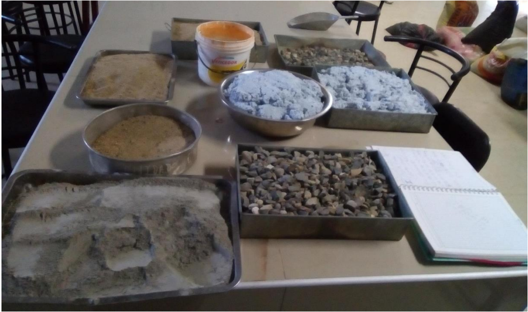
Fotografía N°13: Materiales para elaborar el concreto a base de papel reciclado (Papercrete).
