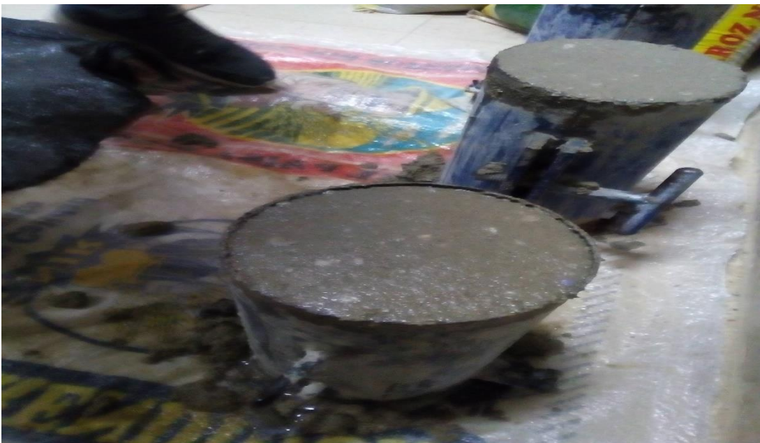
Fotografía N°18: Llenado de moldes con concreto a base de papel reciclado (Papercrete).
