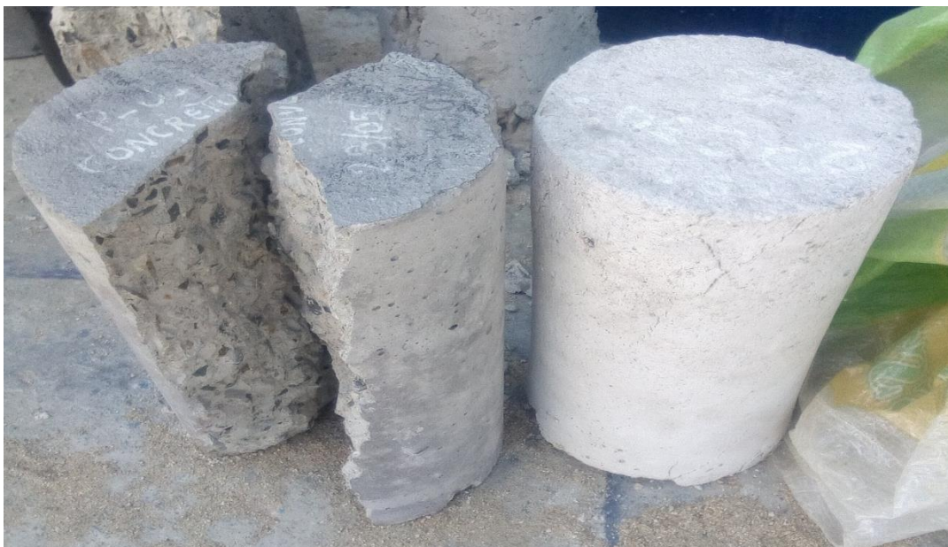
Fotografía N°24: Testigo de concreto a base de papel reciclado (Papercrete) comparado con uno de concreto convencional, ambos después de la rotura.
