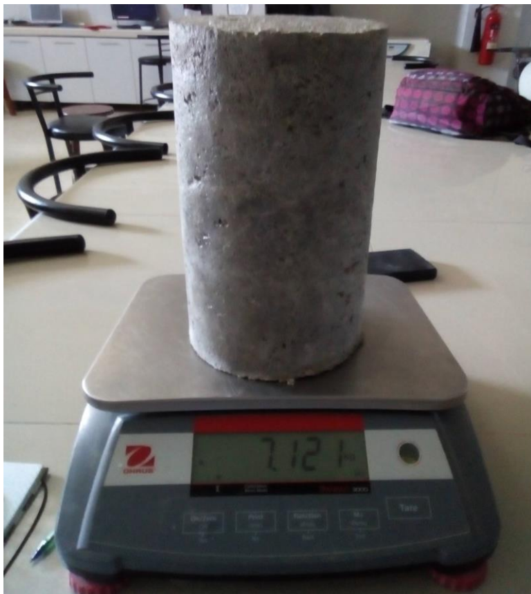
Fotografía N°20: Pesaje del testigo de concreto a base de papel reciclado (Papercrete).
