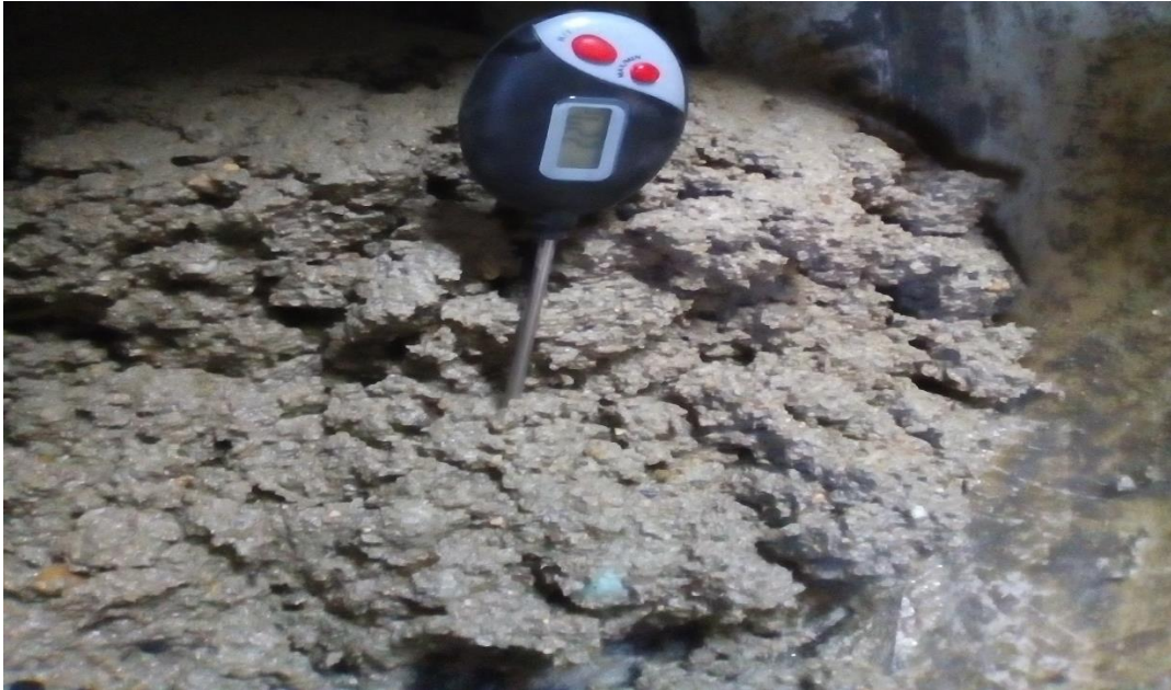
Fotografía N°17: Temperatura del concreto a base de papel reciclado (Papercrete).
