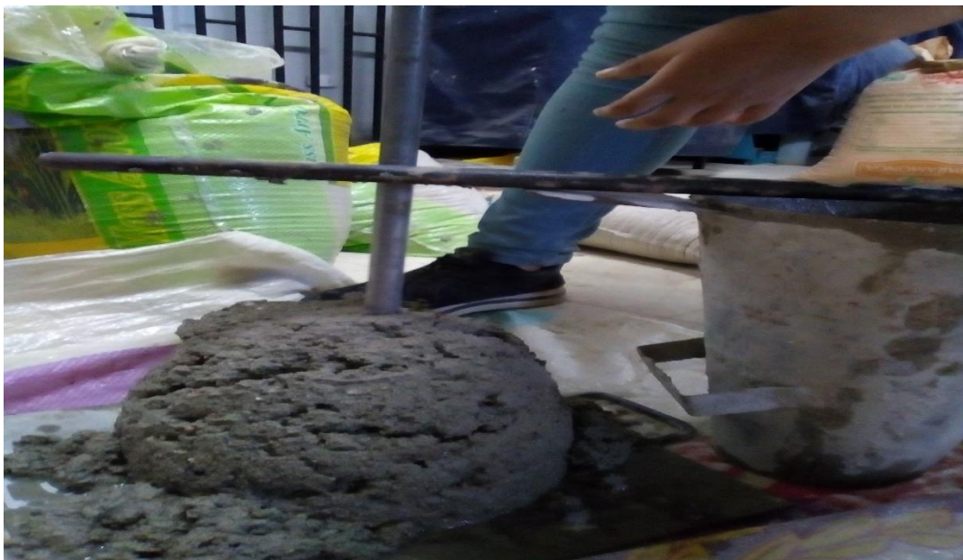
Fotografía N°16: Asentamiento del concreto a base de papel reciclado (Papercrete).
