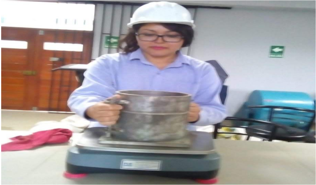
Fotografía N°09: Pesaje del molde junto con el agregado fino para el ensayo de peso unitario.
