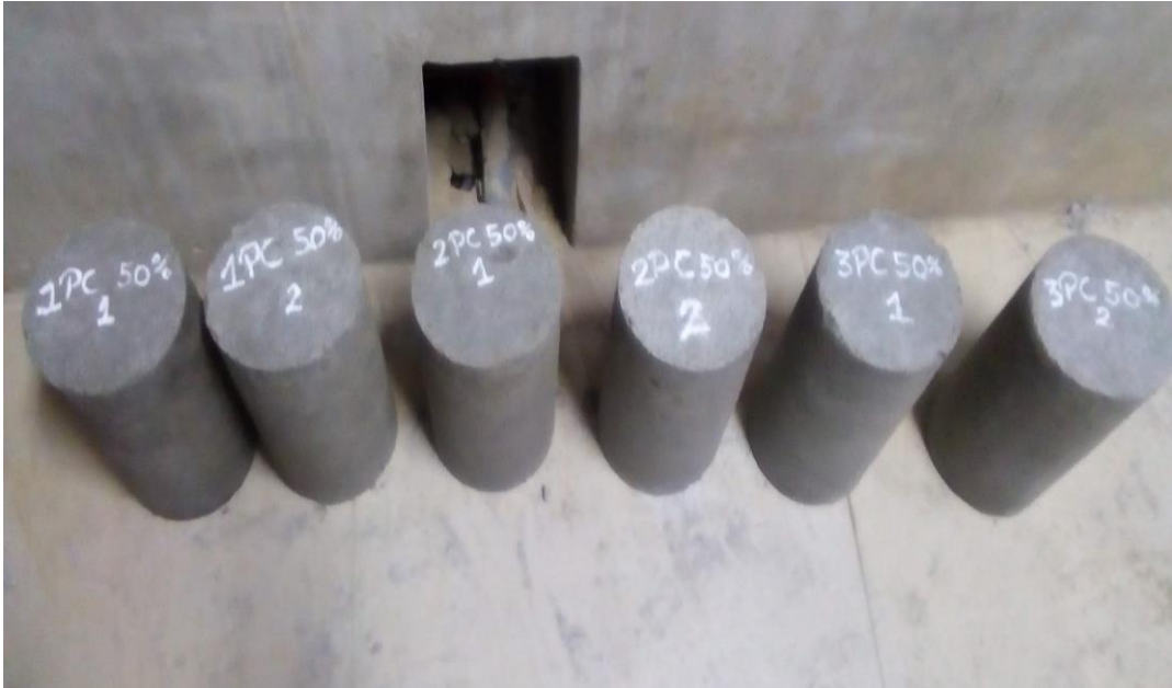
Fotografía N°19: Testigos de concreto a base de papel reciclado (Papercrete).
