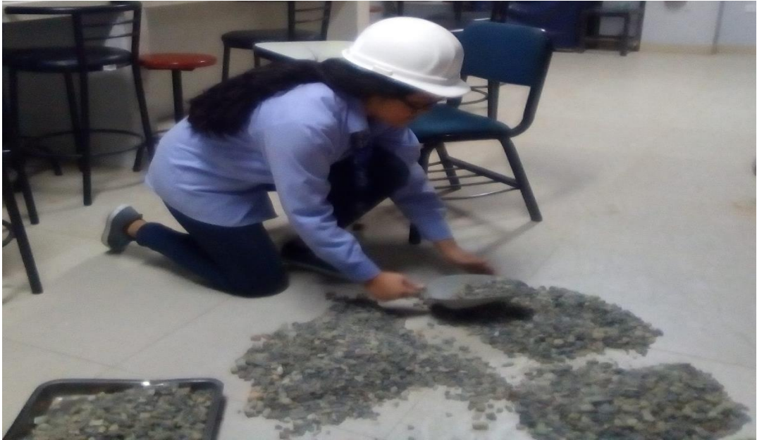
Fotografía N°03: Realizando el cuarteo del agregado grueso.
