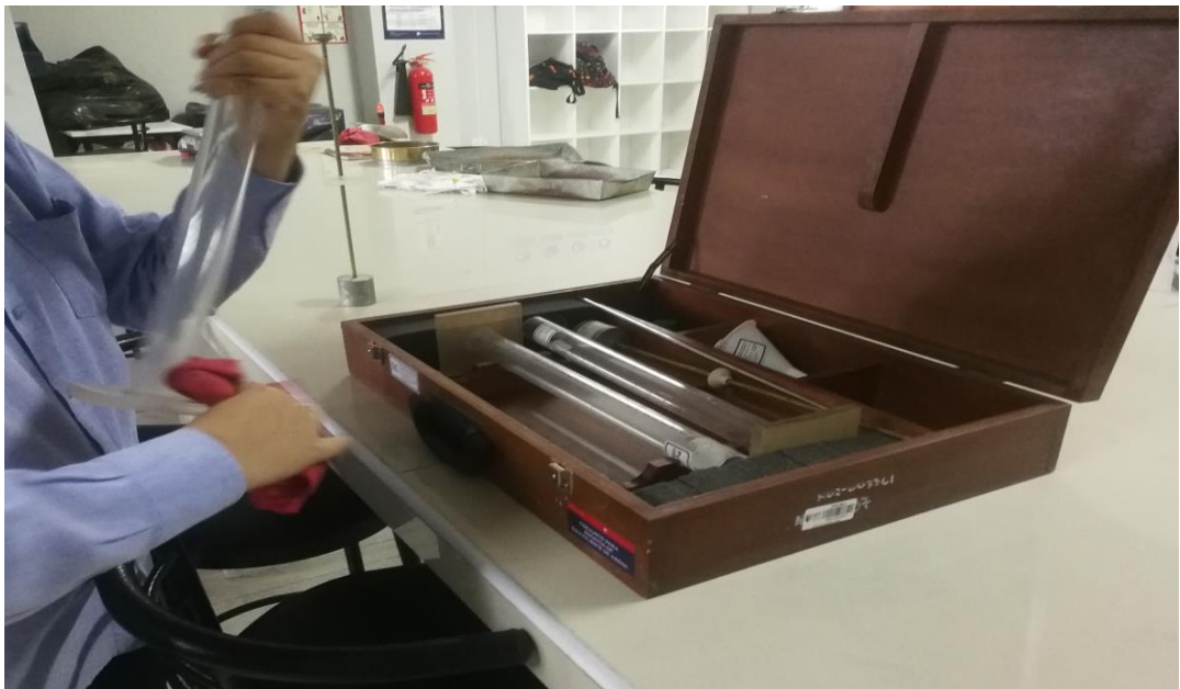
Fotografía N°10: Equipo para el ensayo de equivalente de arena.
