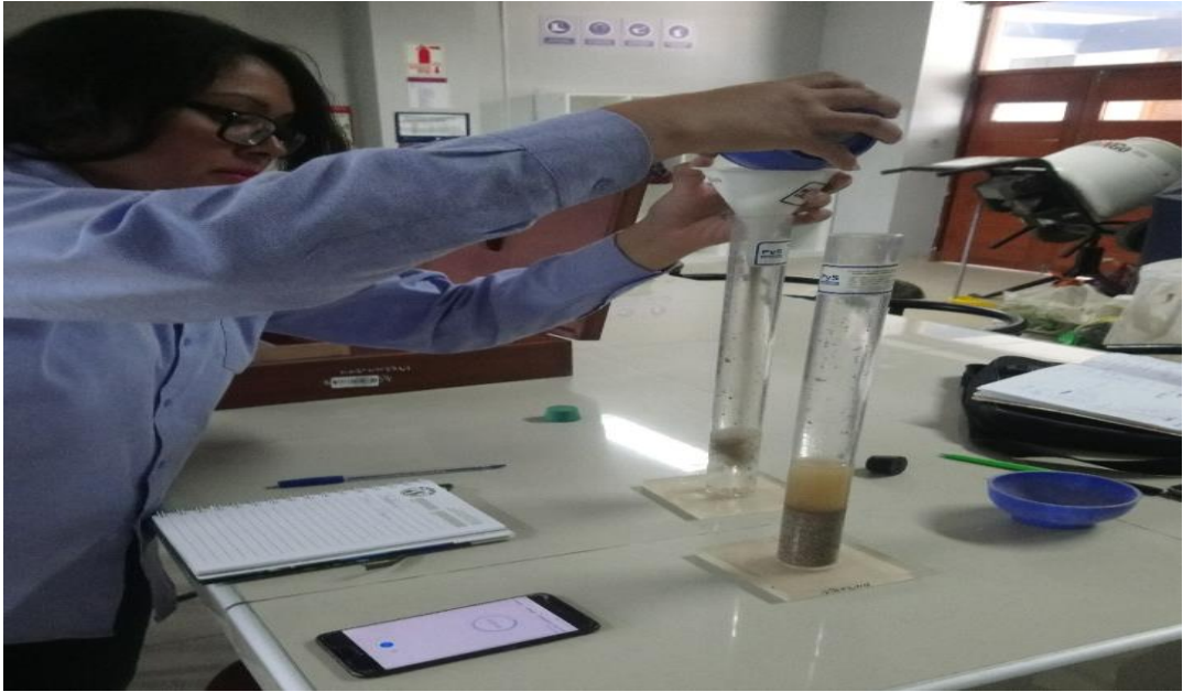
Fotografía N°11: Ensayo de equivalente de arena.
