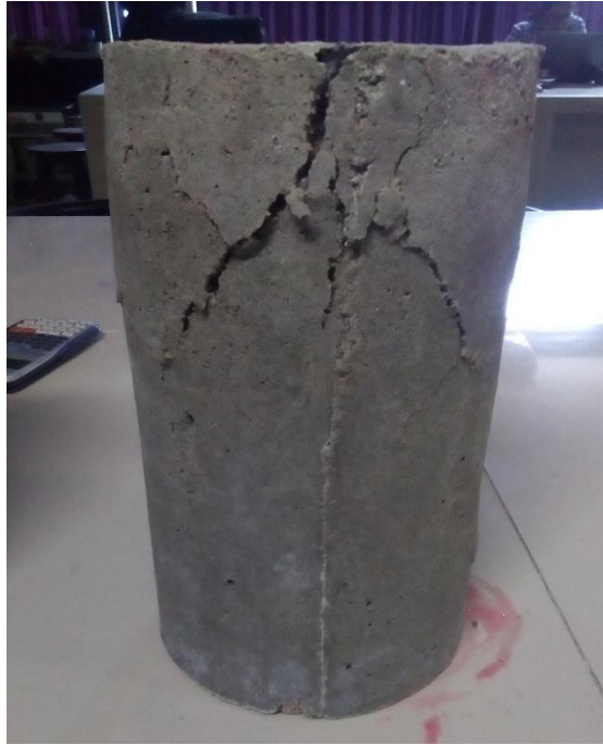
Fotografía N°23: Testigo de concreto a base de papel reciclado (Papercrete) después de la rotura.
