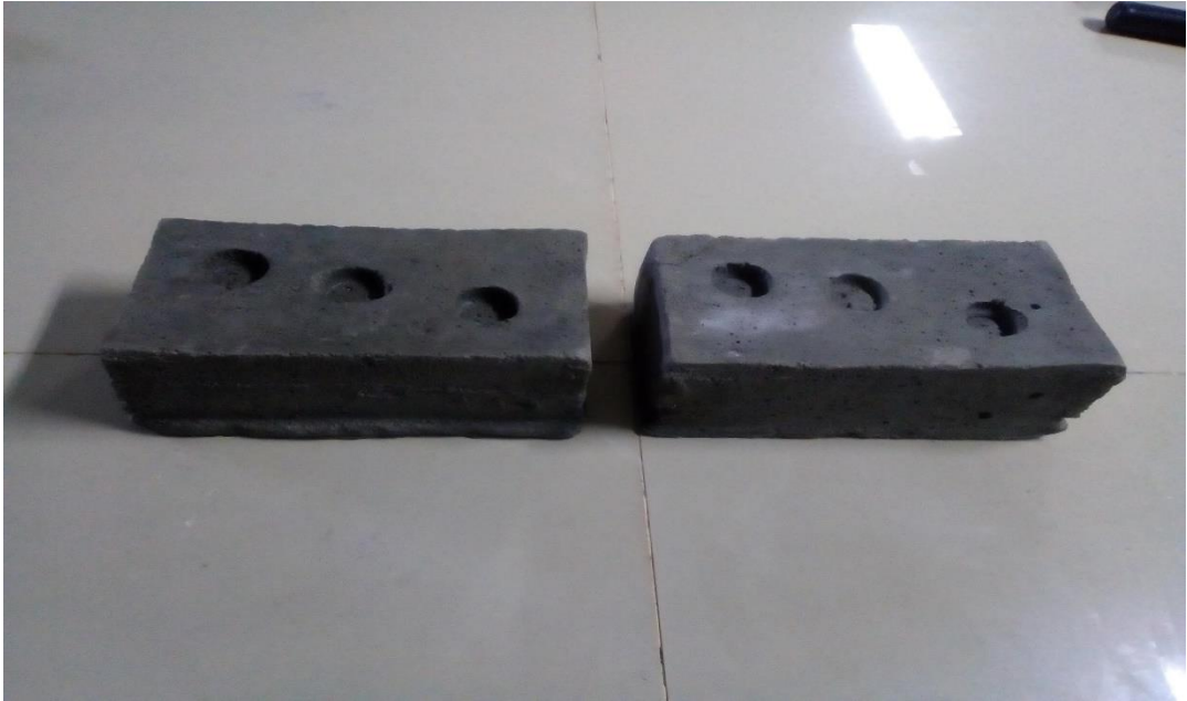
Fotografía N°25: Bloques de concreto a base de papel reciclado (Papercrete).
