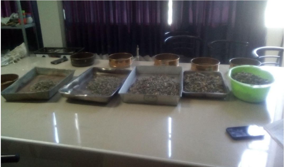
Fotografía N°05: Agregado grueso después del ensayo granulométrico.
