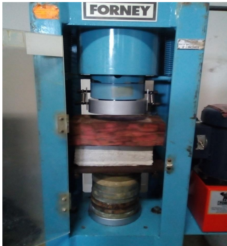
Fotografía N°26: Rotura de bloques de concreto a base de papel reciclado (Papercrete).
