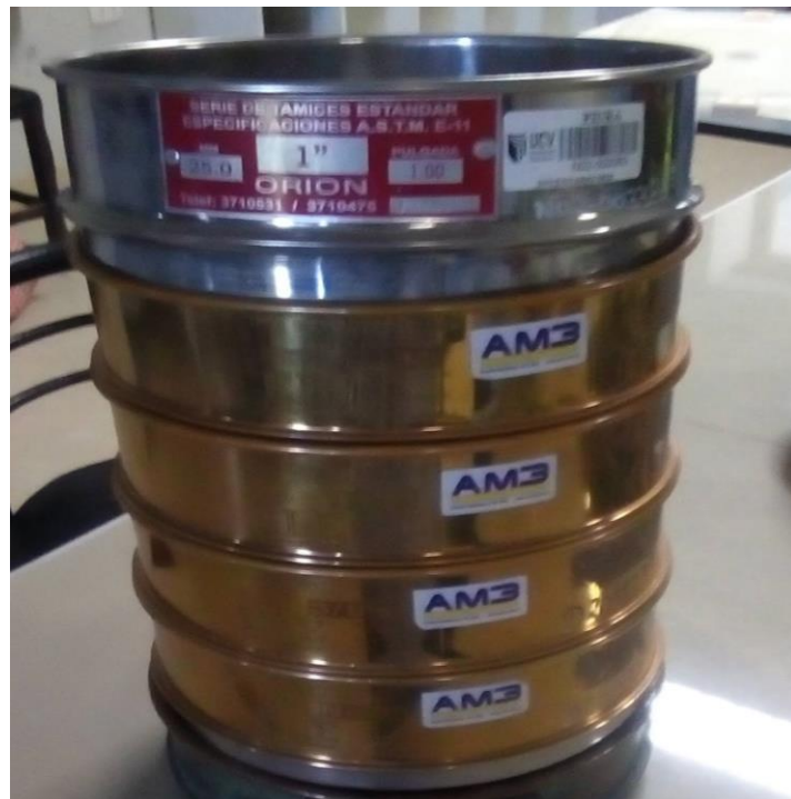
Fotografía N°04: Tamices utilizados para el ensayo granulométrico.
