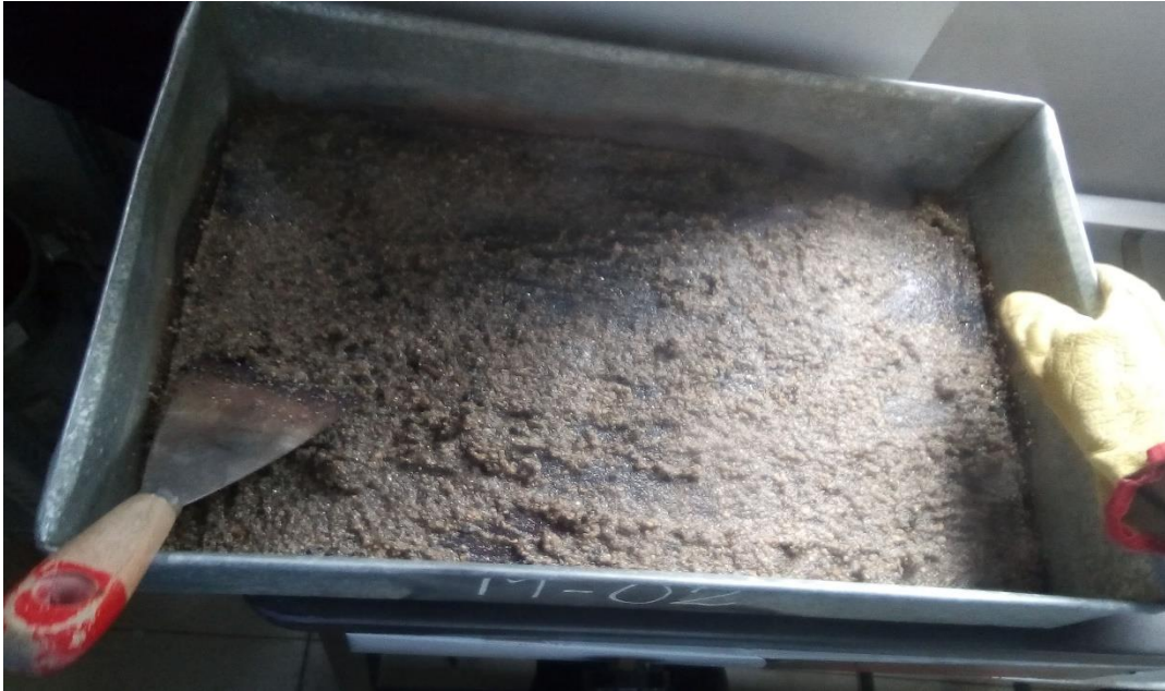
Fotografía N°07: Secado de la muestra en la estufa para el ensayo de humedad natural.
