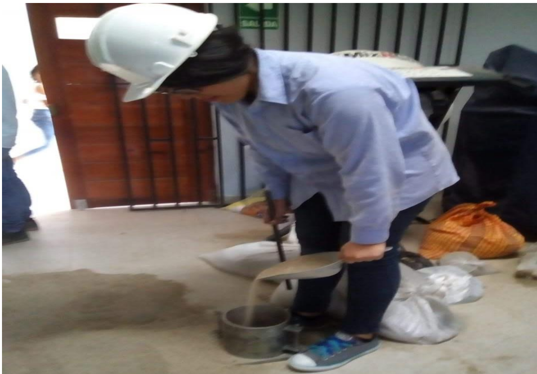
Fotografía N°08: Ensayo de peso unitario del agregado fino.
