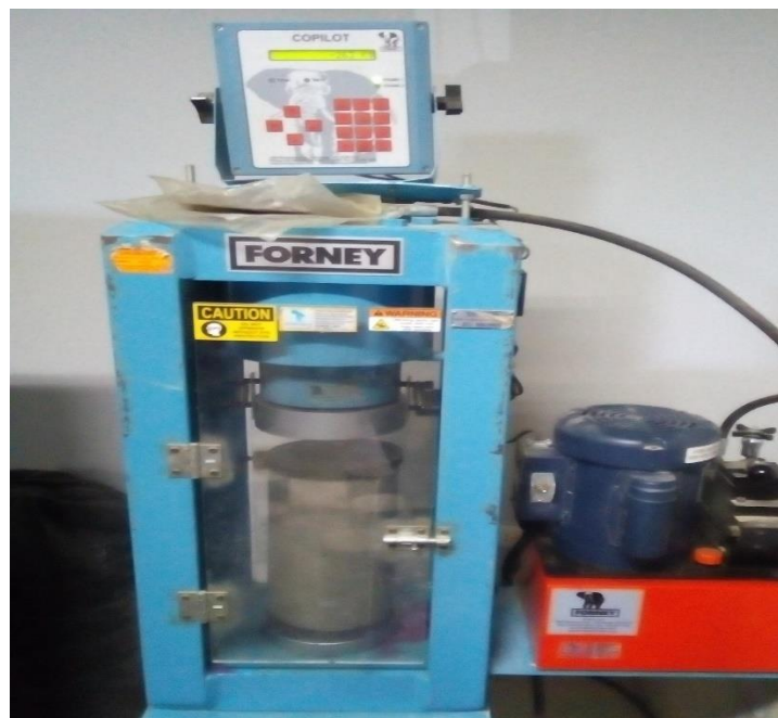
Fotografía N°22: Rotura de testigos de concreto a base de papel reciclado (Papercrete).
