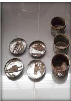
*Figura 4. Laboratorio UCV: Muestra seca después de 24 hrs en el horno.*
