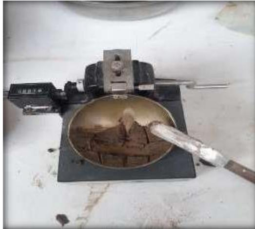
Figura 3. Laboratorio UCV: Extracción de la muestra del instrumento de Casagrande.
