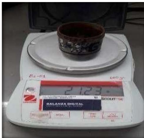
*Figura 5. Laboratorio UCV Pesado de la muestra seca.*
