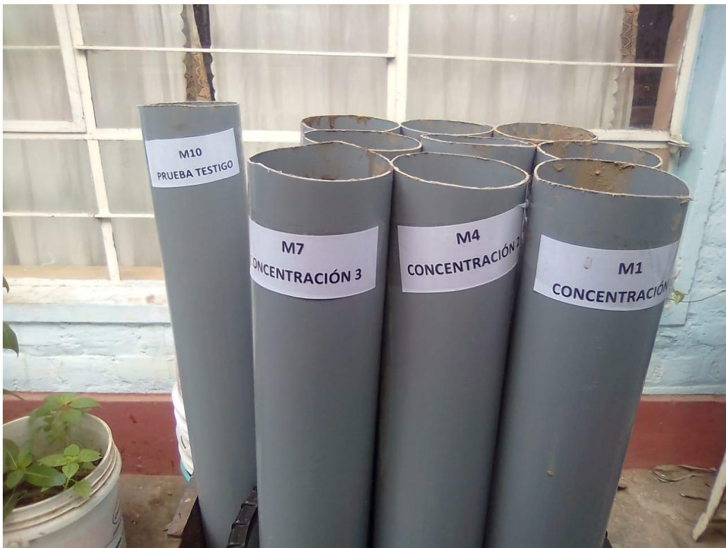
Figura 11: Columnas de tubo de PVC.
