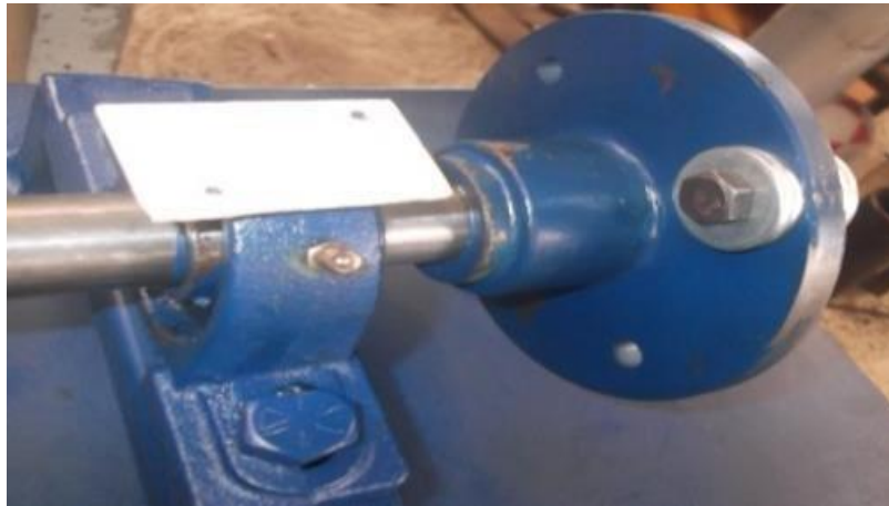
Figura 54. Calibración y balanceo de árbol de transmisión acoplado a chumaceras del separador de dos tiempos.
