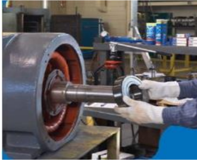
Figura 56. Cambio de rodamiento de rodillos de enfriador industrial.
