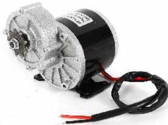
Figura 11. Motor eléctrico de reducción de engranajes 24V 350 W MY1016Z3 con piñón de 9 dientes
