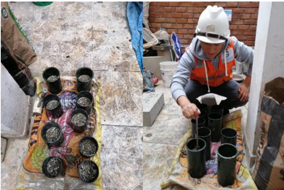
Figura: Llenado de las probetas concreto patrón
