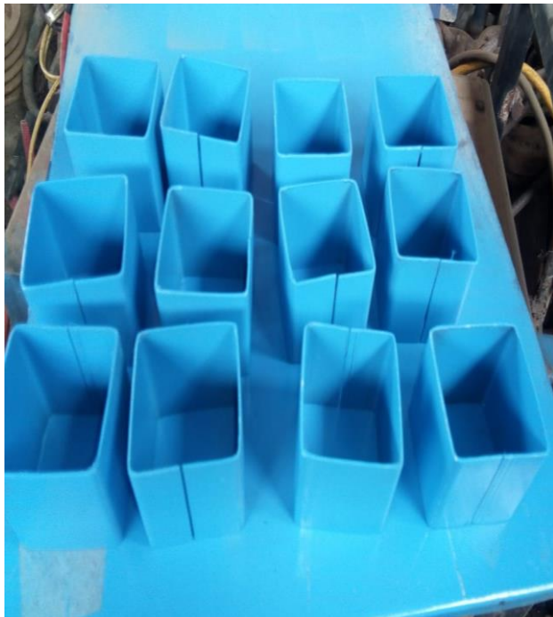
Moldes metálicos para especímenes (laboratorio Moche-Trujillo UCV)
