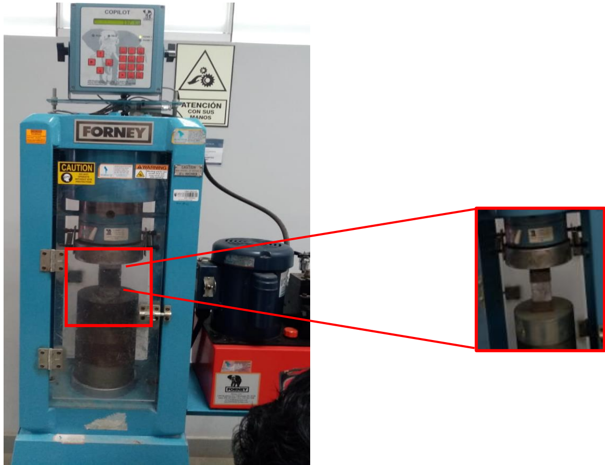
Figura 4: Máquina para pruebas de compresión de concretos.
