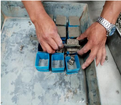
Elaboración de especímenes (laboratorio Moche- Trujillo UCV)
