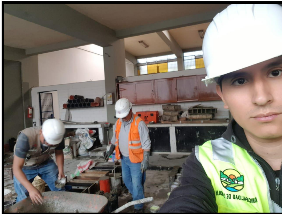
Figura 27. Fotografía del vaciado de concreto en probetas
