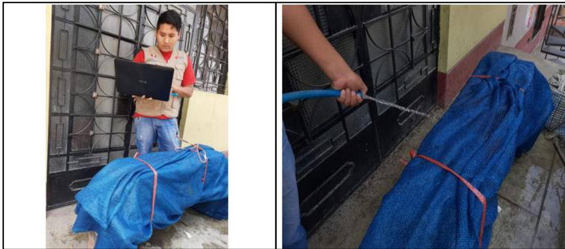
Figura 59. Registro de temperatura y curado de la viga patrón + 1.5% aditivo acelerante Fuente: Elaboración propia
