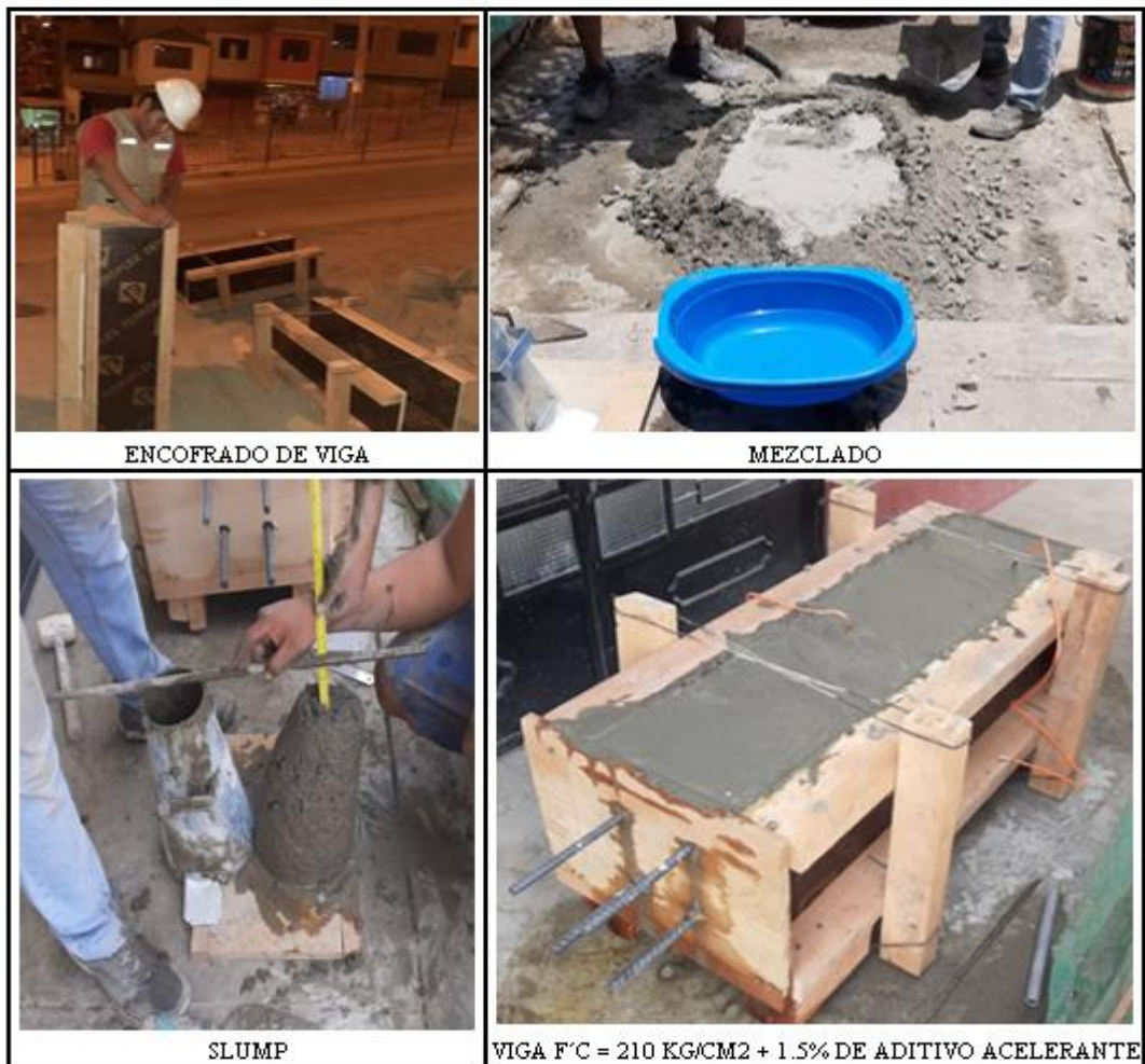
Figura 56. Elaboración de la viga patrón + 1.5 % aditivo acelerante Fuente: Elaboración propia
