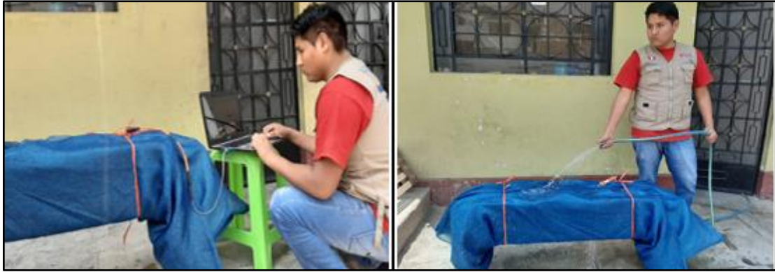
Figura 58. Registro de temperatura y curado de la viga patrón + 1% aditivo acelerante Fuente: Elaboración propia
