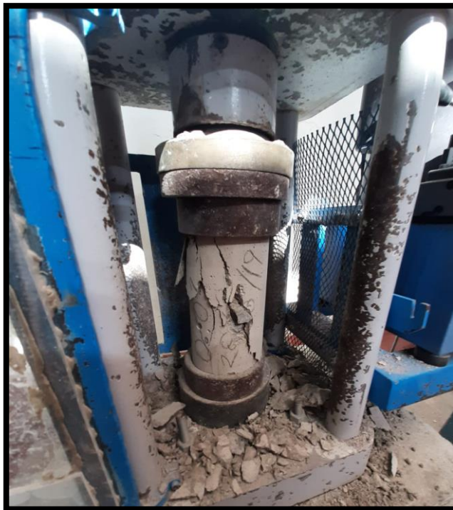
Figura 32. Fotografía de la rotura de las probetas al 1, 3, 7, 14 y 28 días
