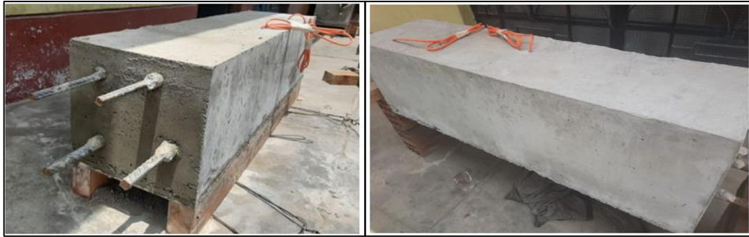
Figura 78. Desencofrado de la viga patrón + 1.5% de aditivo acelerante Fuente: Elaboración propia -Command center2.0
