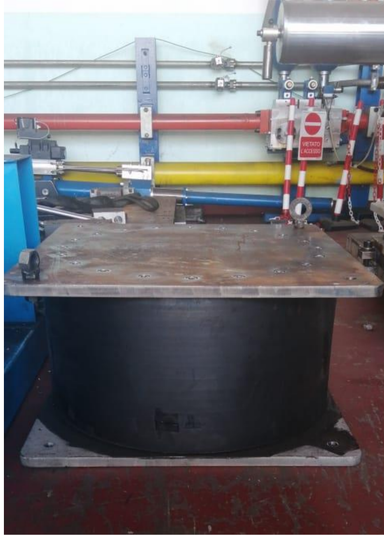
AISLADOR CON NÚCLEO DE PLOMO LISTO PARA PASAR EL ENSAYO
