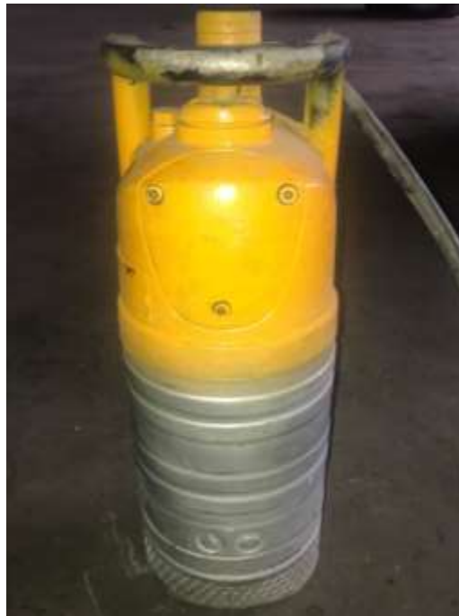
Figura 15. Electrobomba Sumergible Fuente: Elaboración propia
