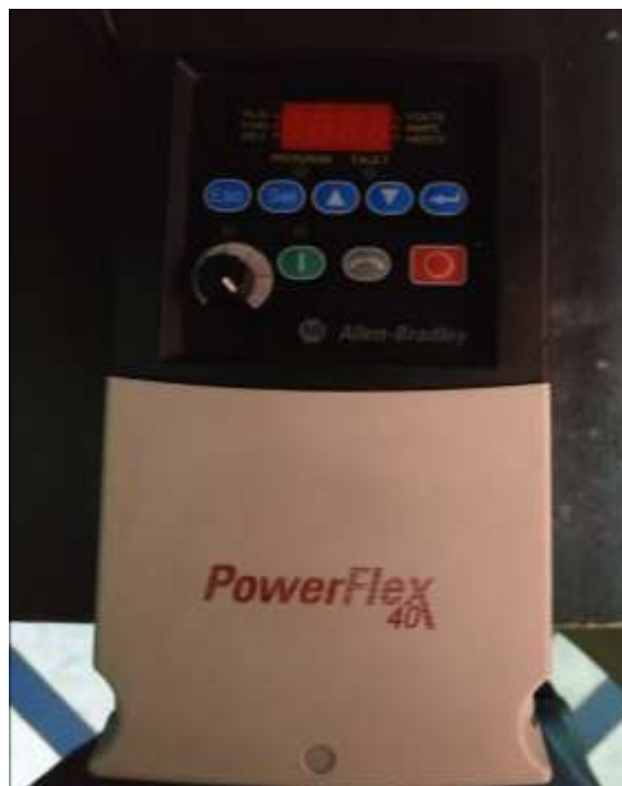
Figura 34. Variador de frecuencia Fuente: Elaboración propia
