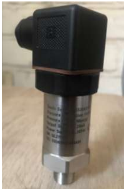
Figura 32. Sensor de presión Fuente: Elaboración propia
