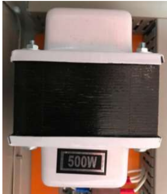
Figura 36. Transformador 440 V – 220 V AUDAX Fuente: Elaboración propia
