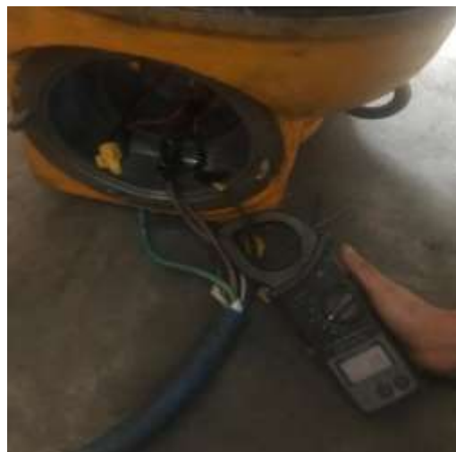
Figura 10. Medición de amperaje Fuente: Elaboración propia
