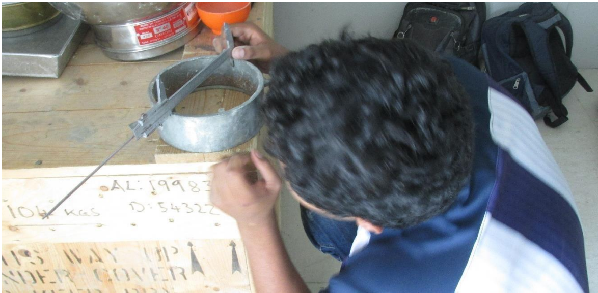
Figura 67: Posterior a los ensayos, se miden los moldes utilizados para los ensayos de peso unitario, cabe mencionar que los moldes son diferentes para cada agregado.
