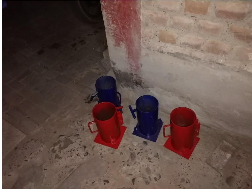
Figura 47: Se muestra las probetas donde se vaciará el concreto para formar los testigos.
