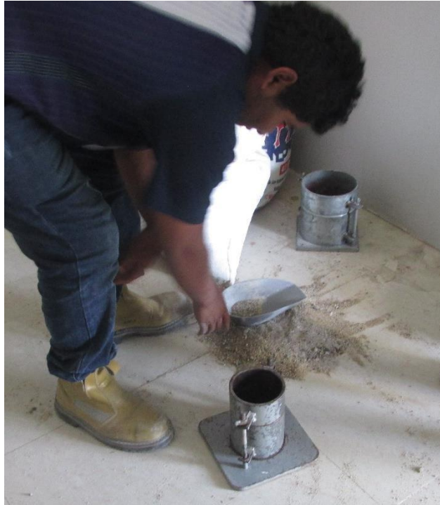
Figura 59: Peso unitario compactado del agregado fino.
