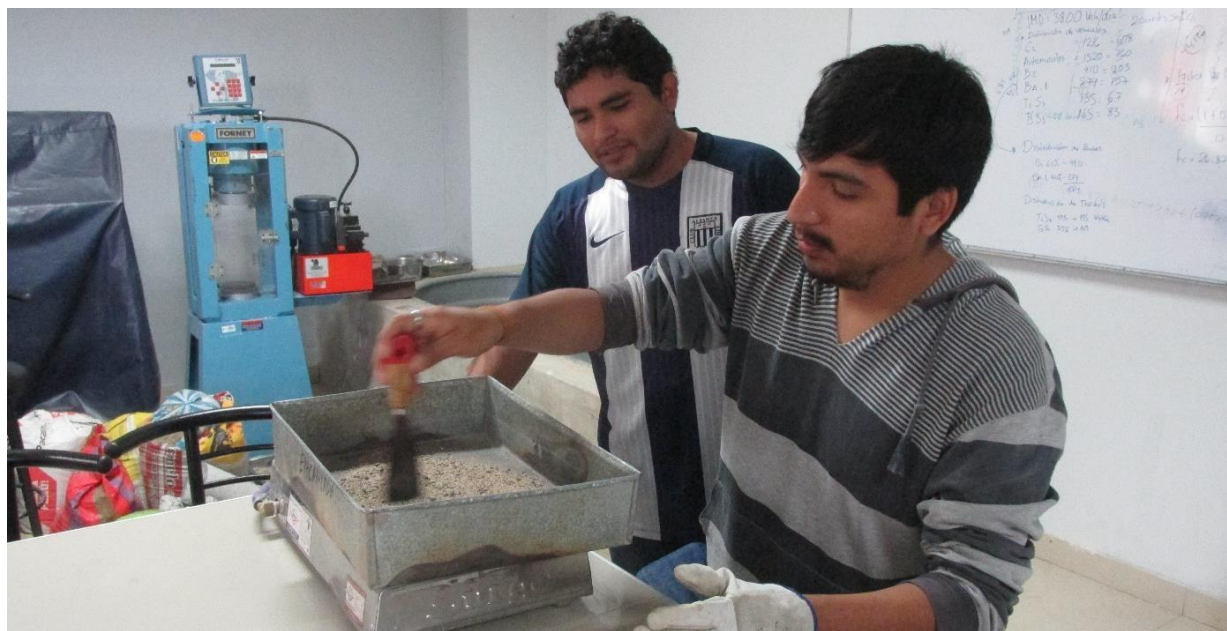
Figura 54: Contenido de humedad natural del agregado fino.
