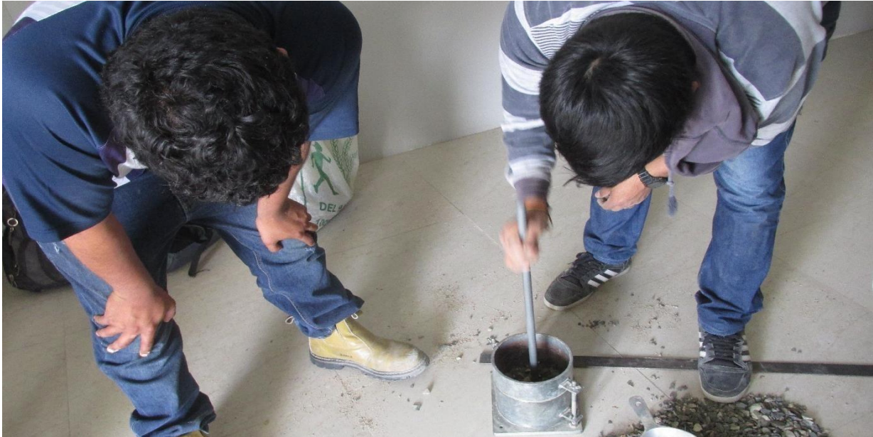
Figura 63: Peso unitario compactado del agregado grueso. Se varilla 25 veces, el mismo procedimiento se realiza para el agregado fino.
