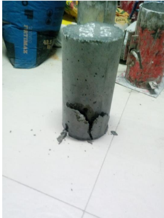
Figura 77: Se muestra rotura por corte en parte inferior del testigo.
