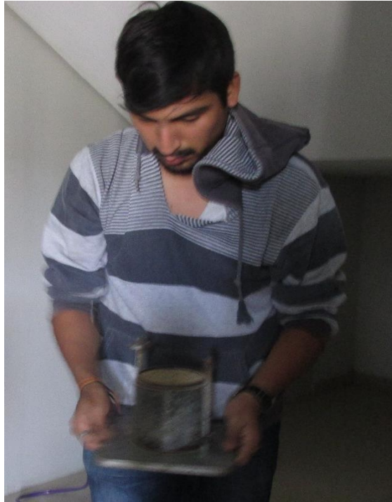
Figura 57: Peso unitario suelto del agregado fino.
