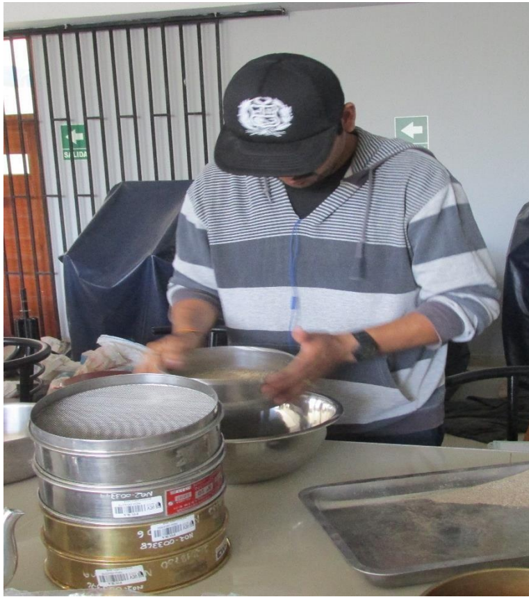
Figura 51: Tamizado del agregado fino.
