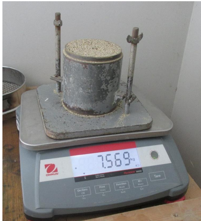
Figura 58: Peso unitario suelto del agregado fino, se sacan 3 muestras diferentes.
