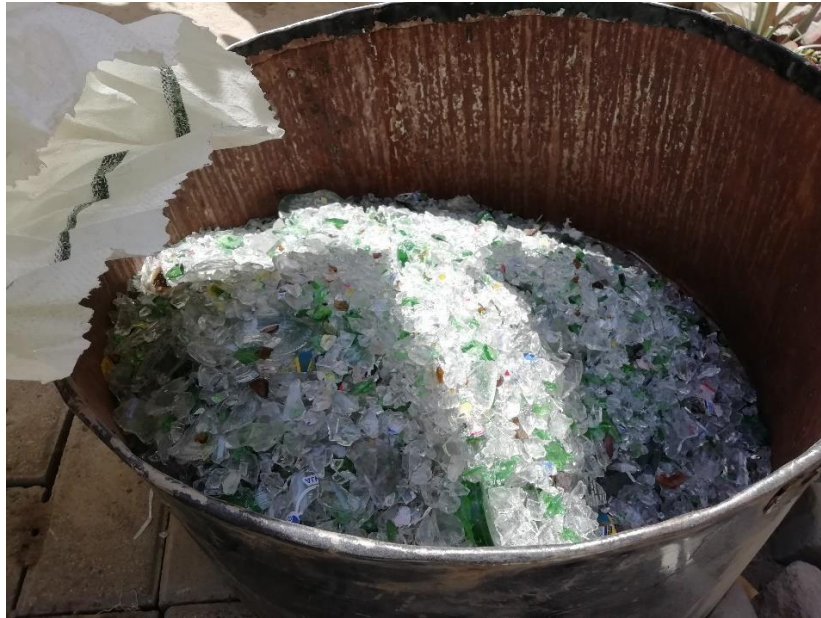
Figura 45: Se separa las partículas más grandes a través de la malla n°4 que separa agregado del fino al grueso.
