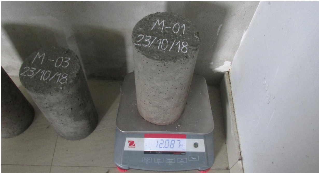
Figura 72: Colocación de nombres y pesaje de testigos.
