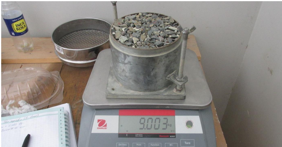
Figura 62: Peso unitario suelto del agregado grueso, se sacan 3 muestras diferentes.
