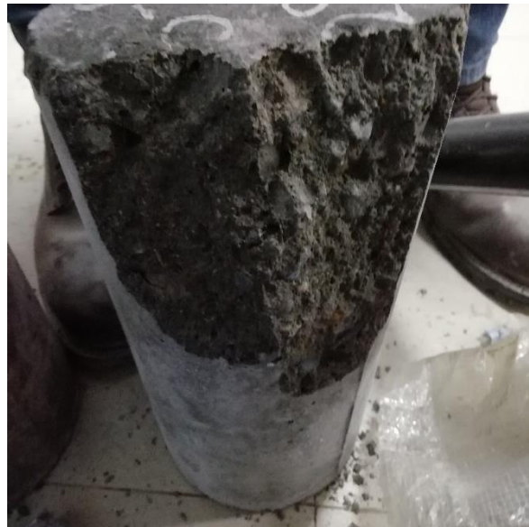
Figura 74: Se muestra rotura por desprendimiento en testigo sometido a compresión.
