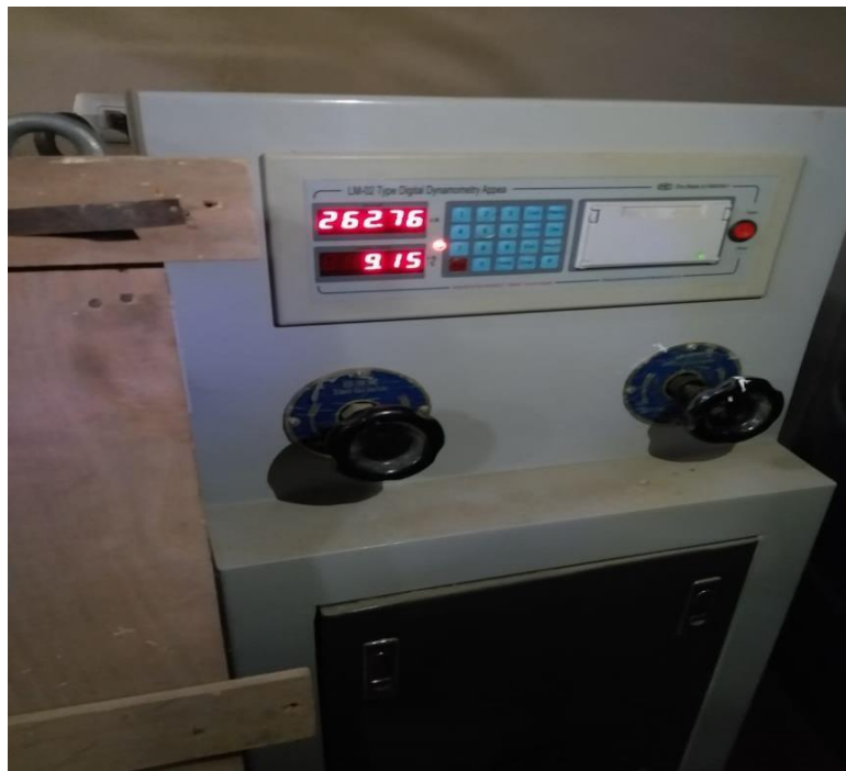
Figura 80: Se procede a realizar ruptura de testigos en la compresora del Laboratorio Mesa Ingenieros S.A.C.
