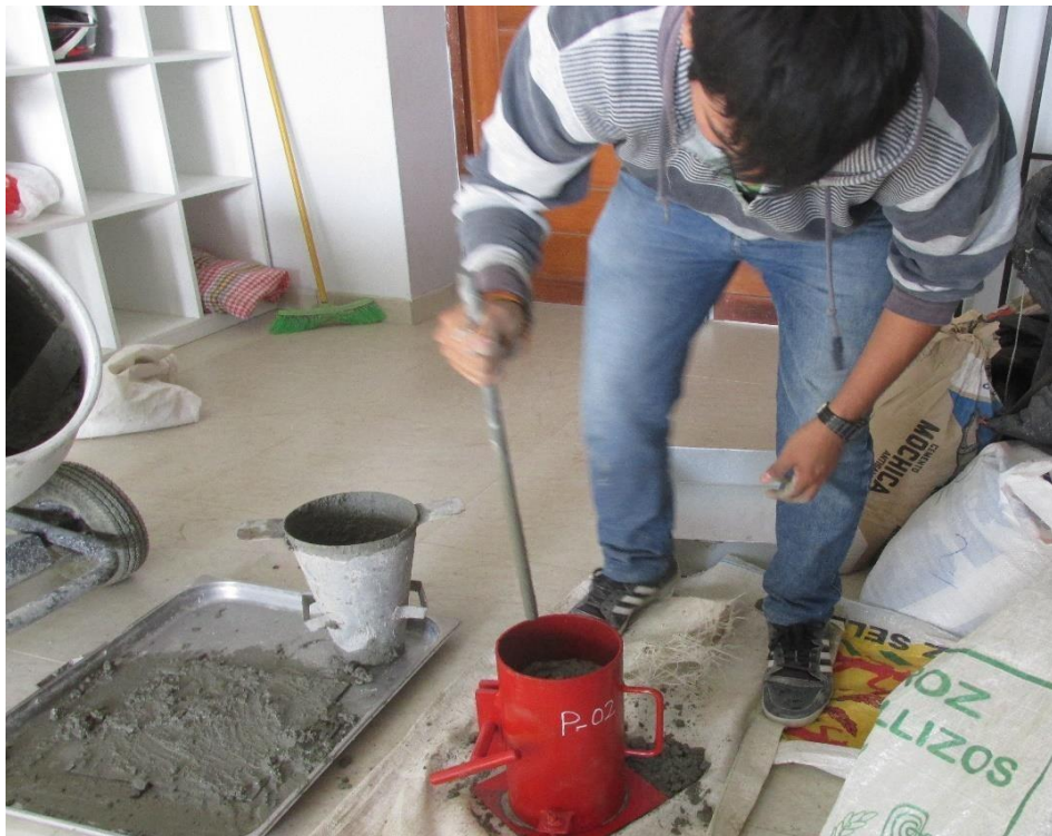
Figura 70: Llenado de probetas, diseño de mezcla al 50% de vidrio realizado en laboratorio de la Universidad Cesar Vallejo Piura
