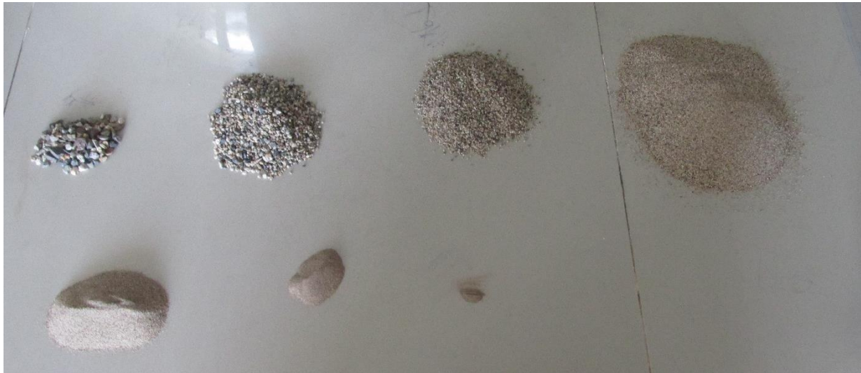
Figura 52: Distribución por tamices del agregado fino.
