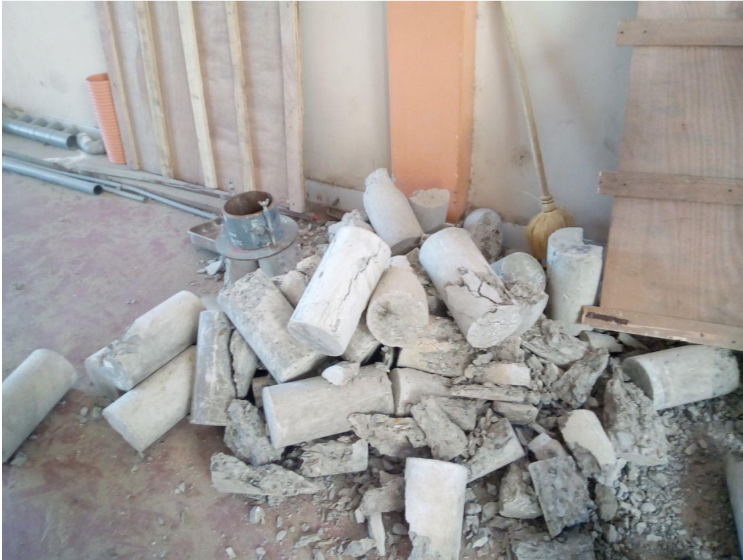
Figura 81: Se muestra la totalidad de testigos sometidos a rotura.
