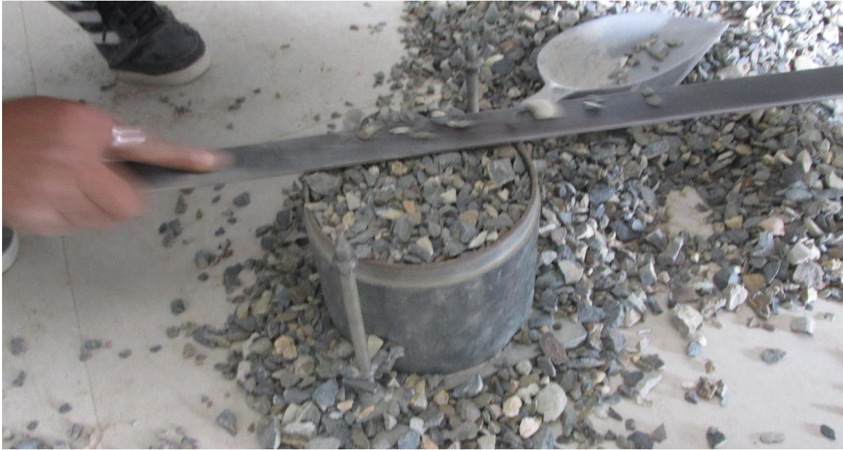
Figura 65: Después se retira la parte superior del molde y se nivela con la regla de metal. Este mismo procedimiento se realiza para el agregado fino.
