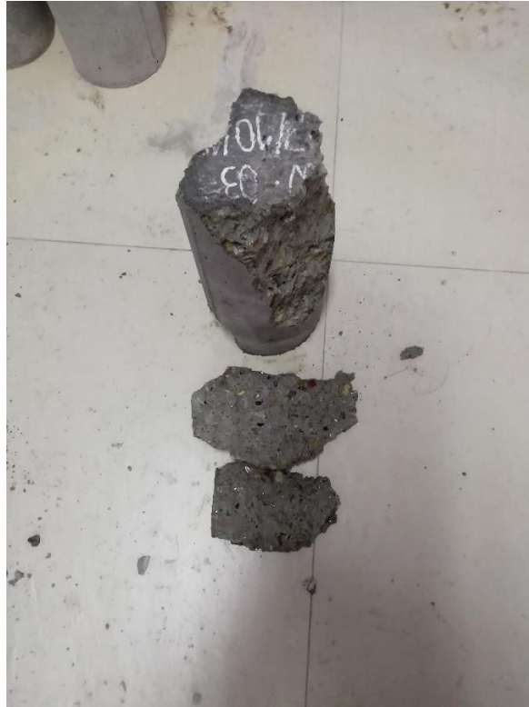
Figura 75: Se muestra rotura por desprendimiento en ambos lados en testigo sometido a compresión.
