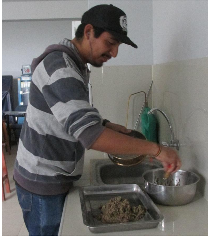
Figura 55: Removiendo finos y limos para ensayo de Peso Específico.
