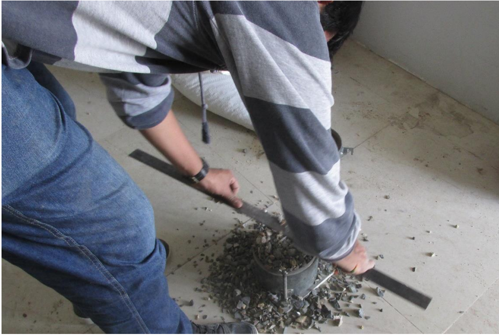
Figura 61: Peso unitario suelto, agregado grueso.
