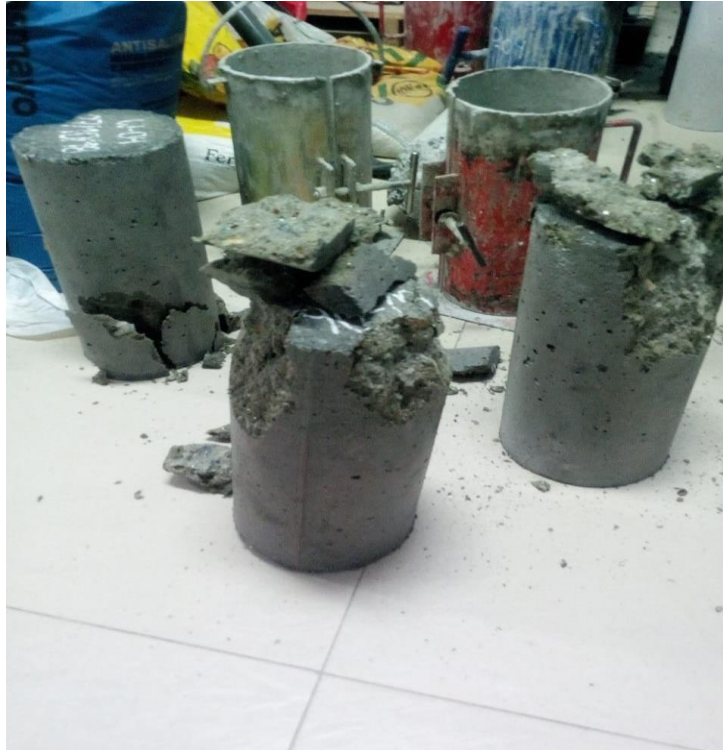
Figura 78: Se muestra la cantidad de testigos ensayados por edad, 3 a los 7, 14 y 28 días.
