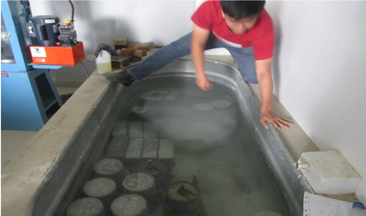
Figura 73: Colocación de los testigos de concreto en la tina de agua para su curado.
