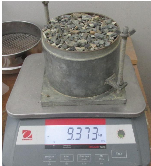
Figura 66: Peso unitario compactado del agregado grueso, se sacan 3 muestras diferentes.
