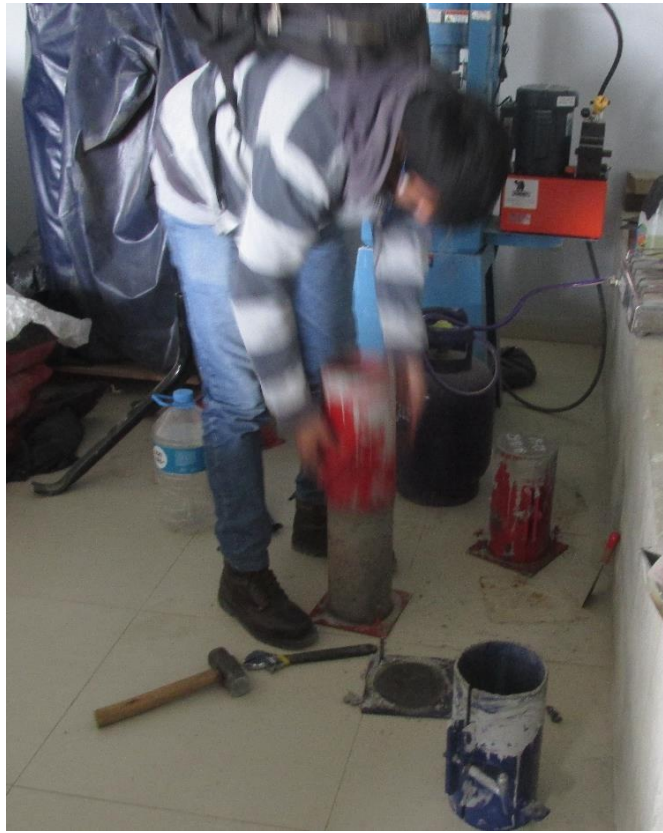
Figura 71: Desencofrado de testigos de concreto.
