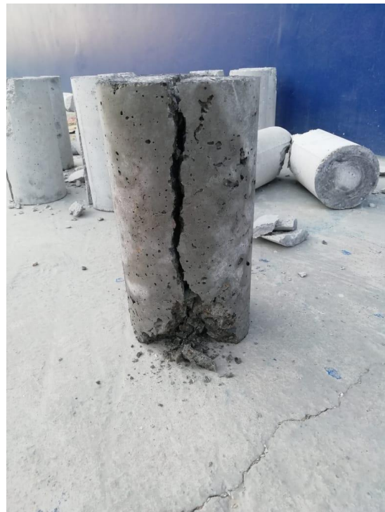
Figura 76: Se muestra rotura por corte vertical céntrica en testigo sometido a compresión.
