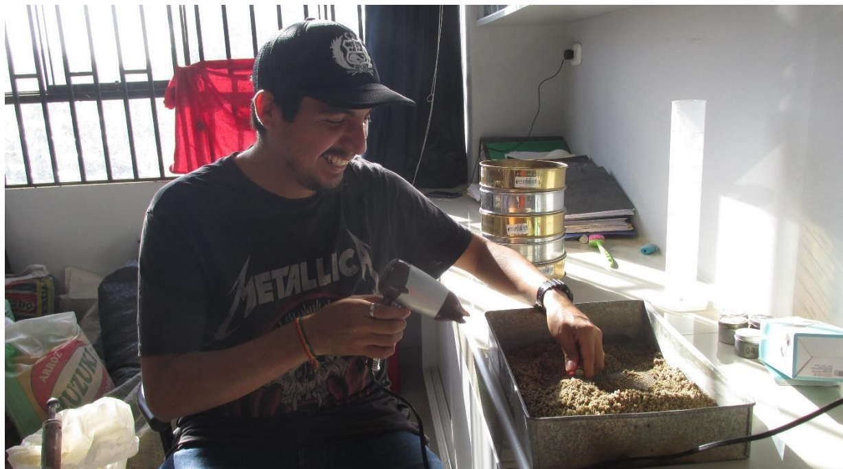
Figura 53: Peso específico y absorción del agregado fino, secado con aire caliente.
