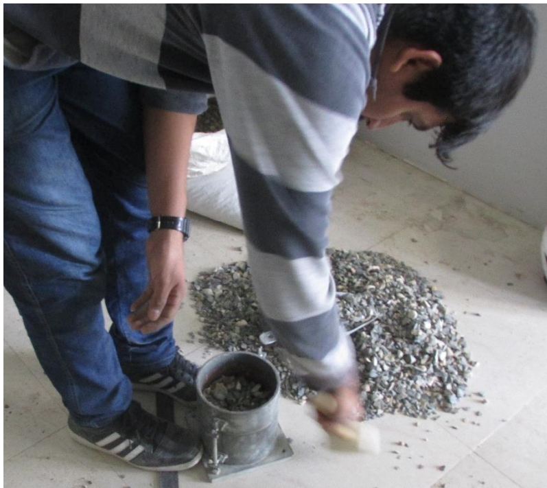
Figura 64: Luego se golpea 15 veces con un martillo de goma para quitar el aire y acomodar mejor el material en el molde.
