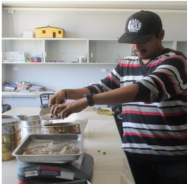
Figura 50: Se pesa 1 kg de agregado fino para el análisis granulométrico.
