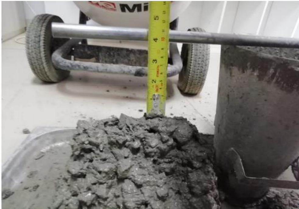
Figura 69: Slump de 4' en la prueba del cono de Abrams. Indica que la mezcla es plástica.
