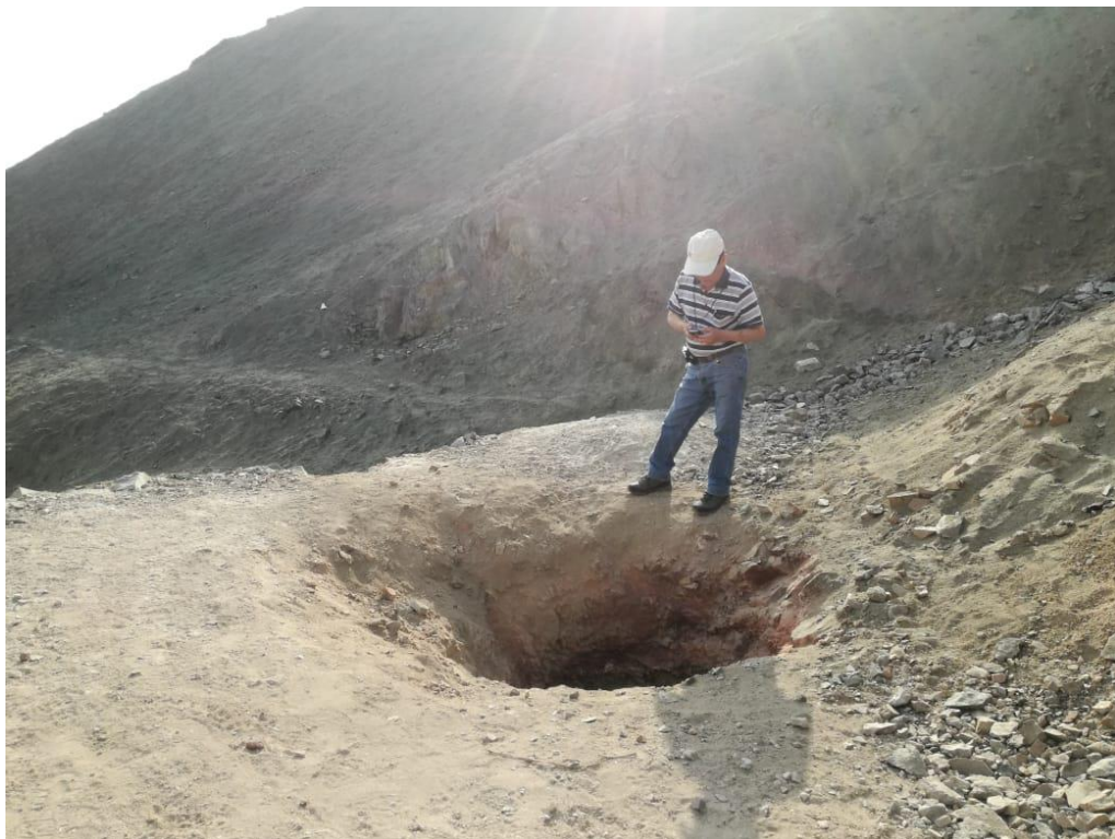
Figura 25. Toma de muestras para Estudio de Suelos (Fuente: Propia)
