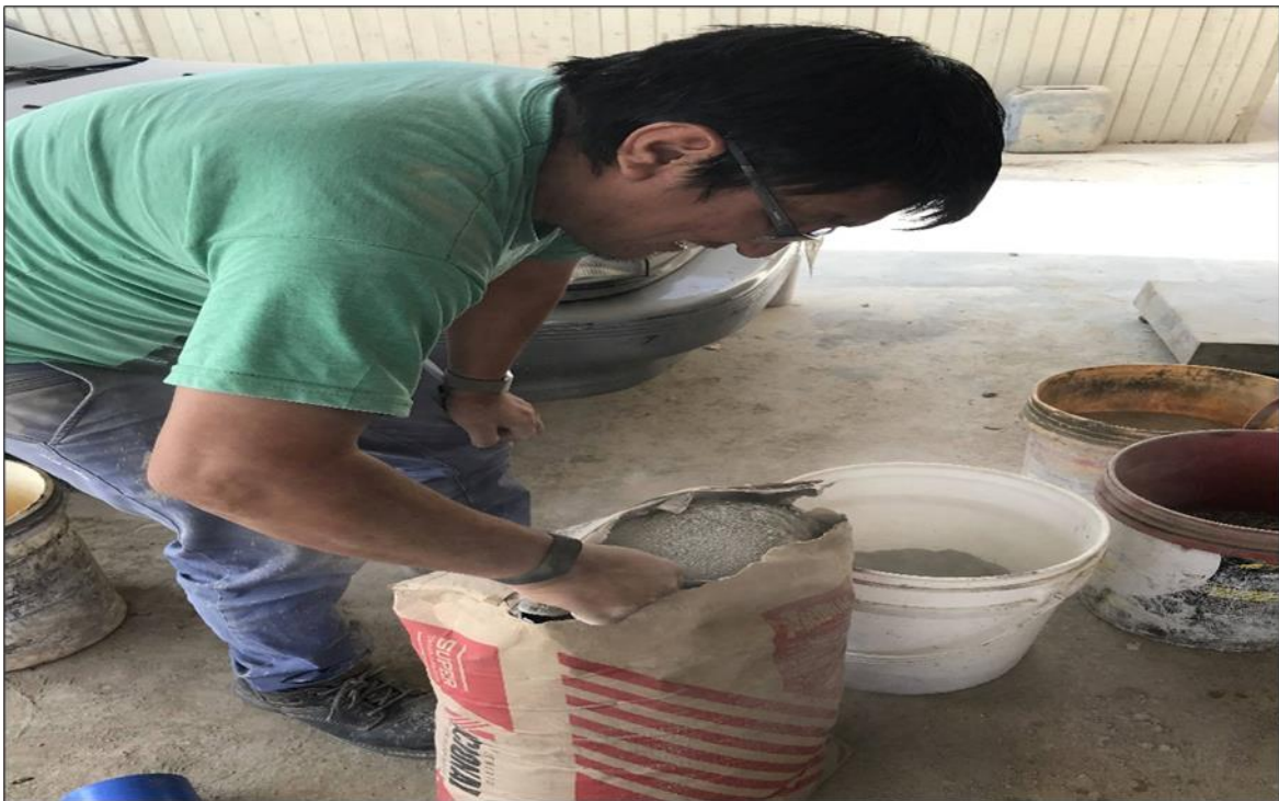
Figura 71. Peso y tarado del cemento
