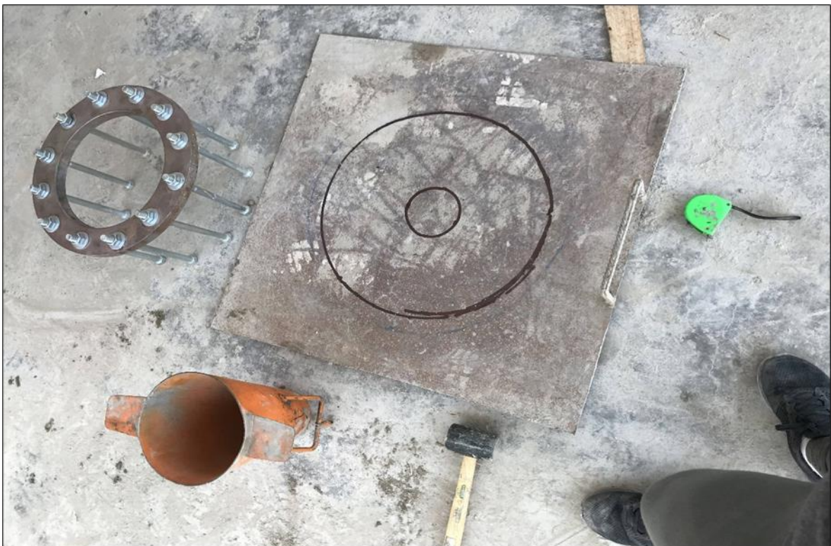
Figura 33. Herramientas para el ensayo de anillo J para ver la capacidad de paso
