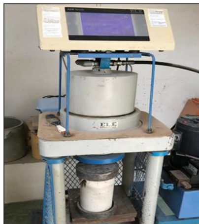
Figura 22. Realizando el ensayo a la Compresión
