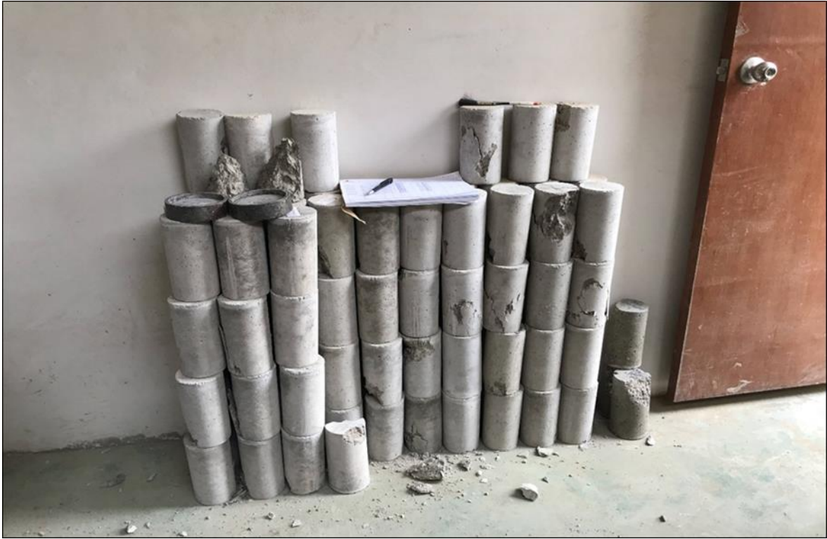
Figura 100. Probetas ensayadas a la compresión
