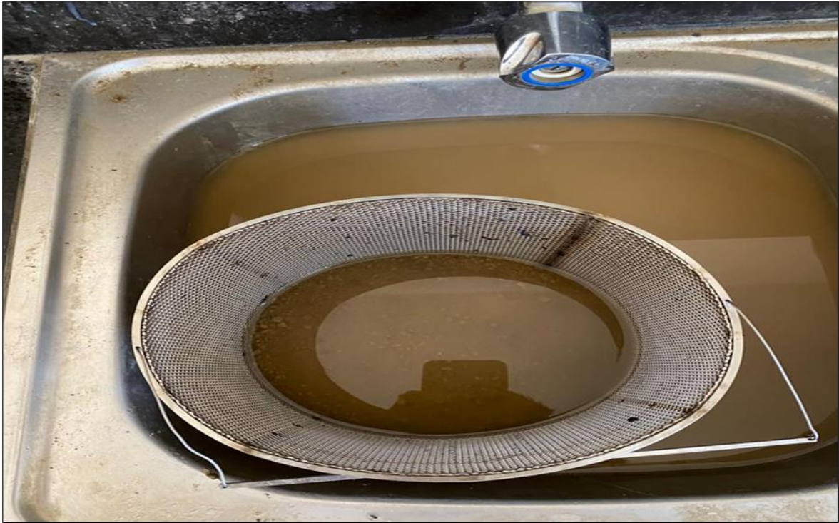
Figura 54. Agregado fino sumergido en agua
