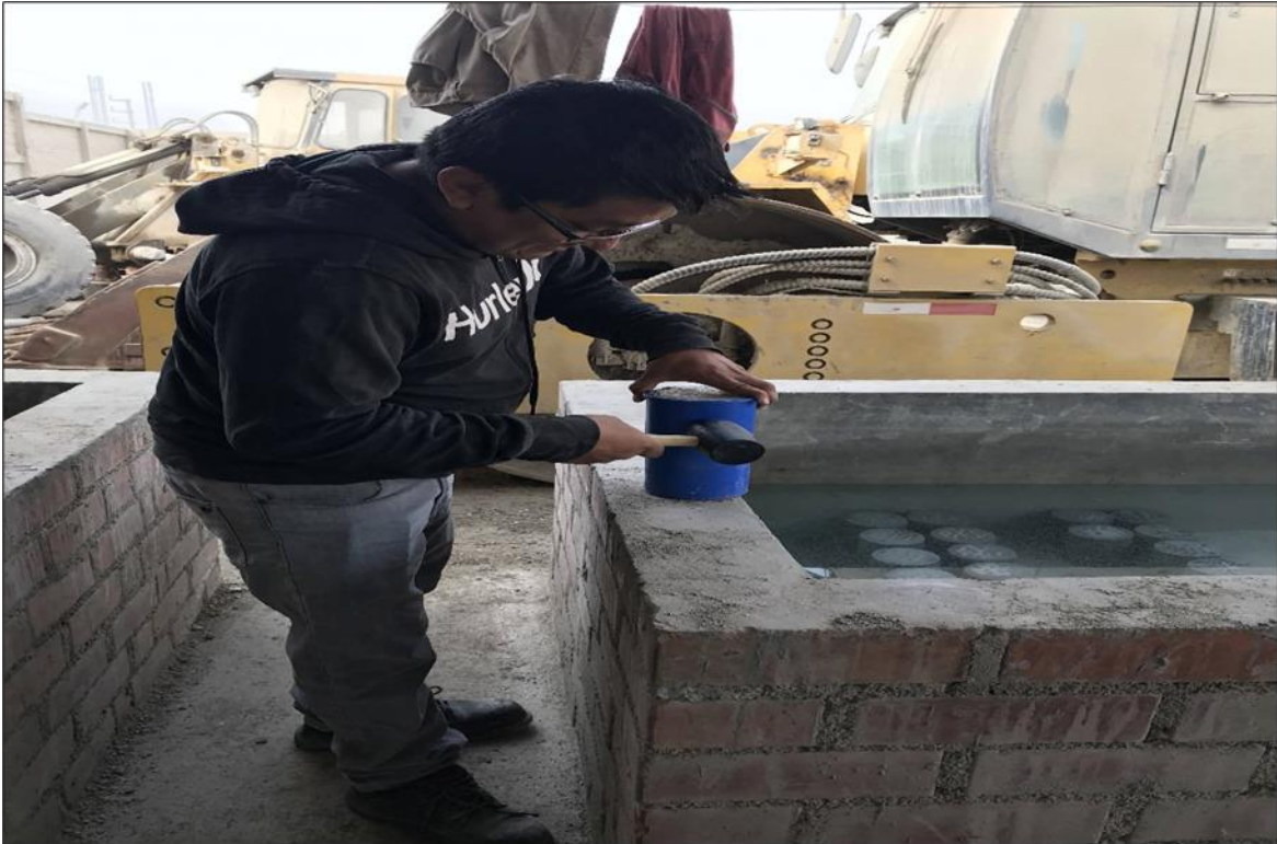
Figura 95. Desmoldando especímenes de concreto de las probetas
