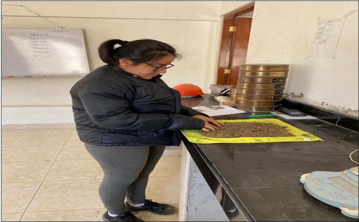
Figura 56. Secado de la arena con una franela absorbente para hallar el Saturado Superficialmente Seco (SSS) del agregado fino
