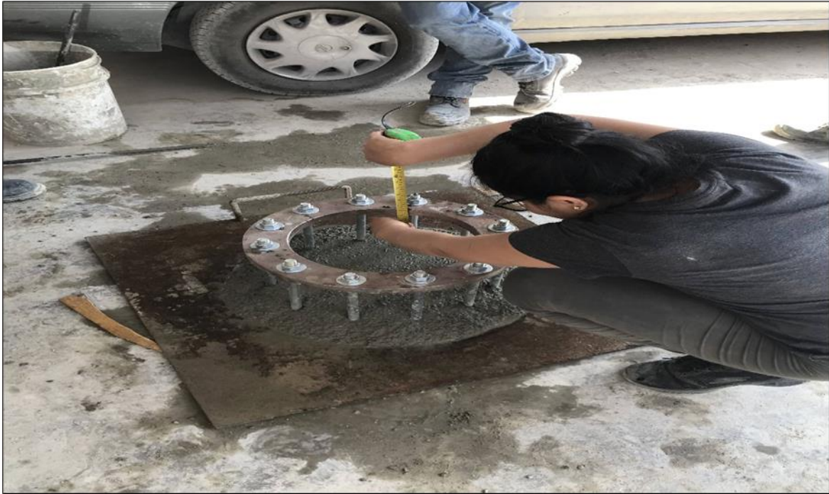
Figura 36. Midiendo altura del escurrimiento hacia el anillo
