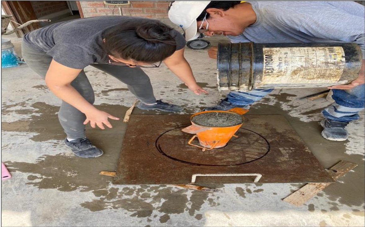
Figura 78. Ensayo del cono invertido para hallar la extensibilidad
