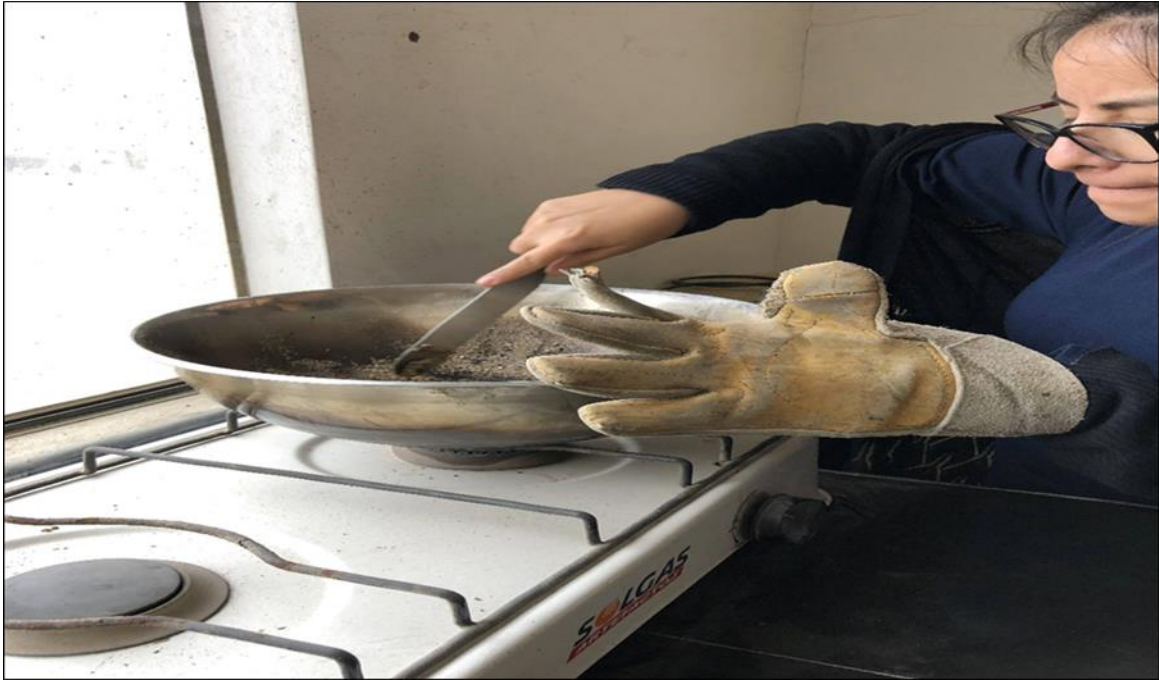
Figura 44. Secado del agregado fino mojado en la estufa
