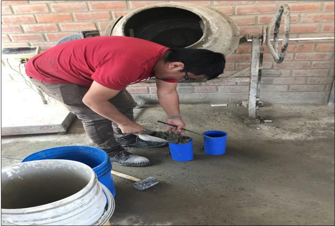
Figura 90. Elaboración de especímenes de concreto
