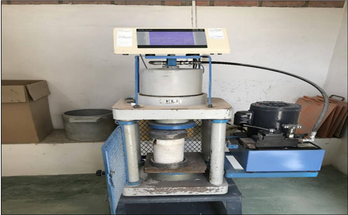
Figura 98. Ensayo a la compresión de espécimen de concreto
