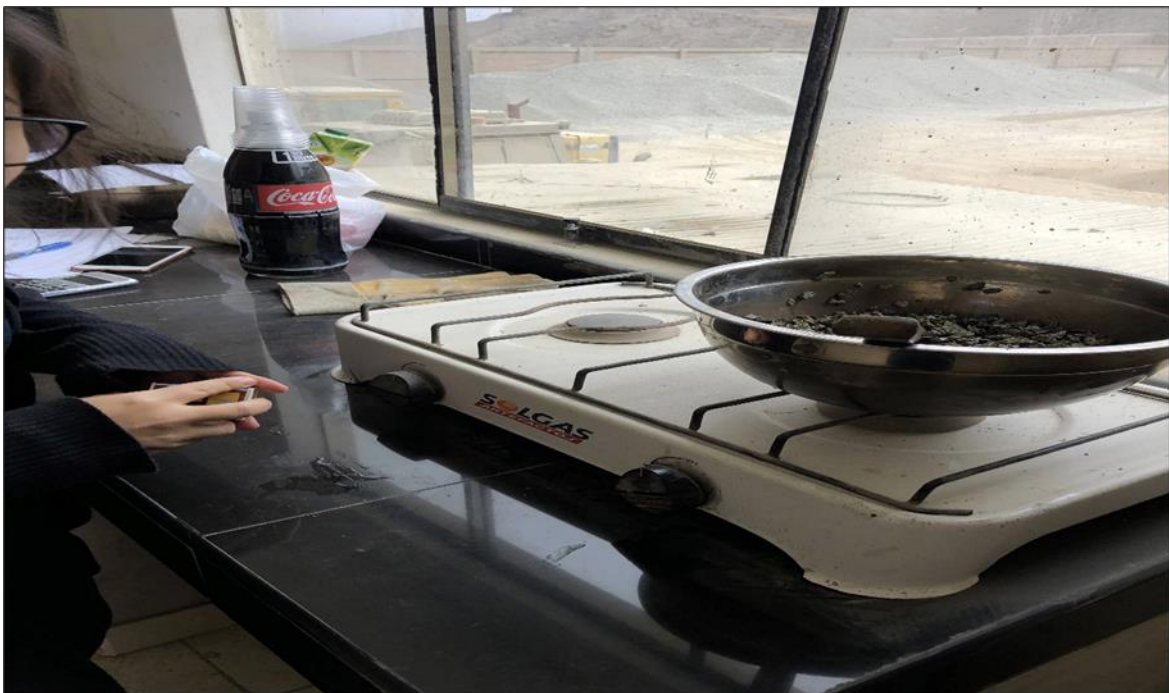
Figura 51. Secado del agregado grueso en estufa
