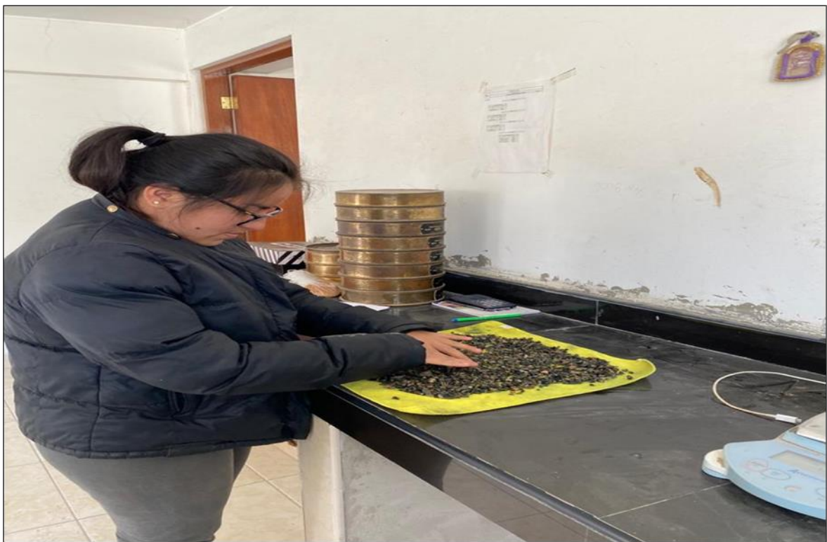
Figura 61. Secado de la arena con una franela absorbente para hallar Saturado Superficial Seco (SSS)
