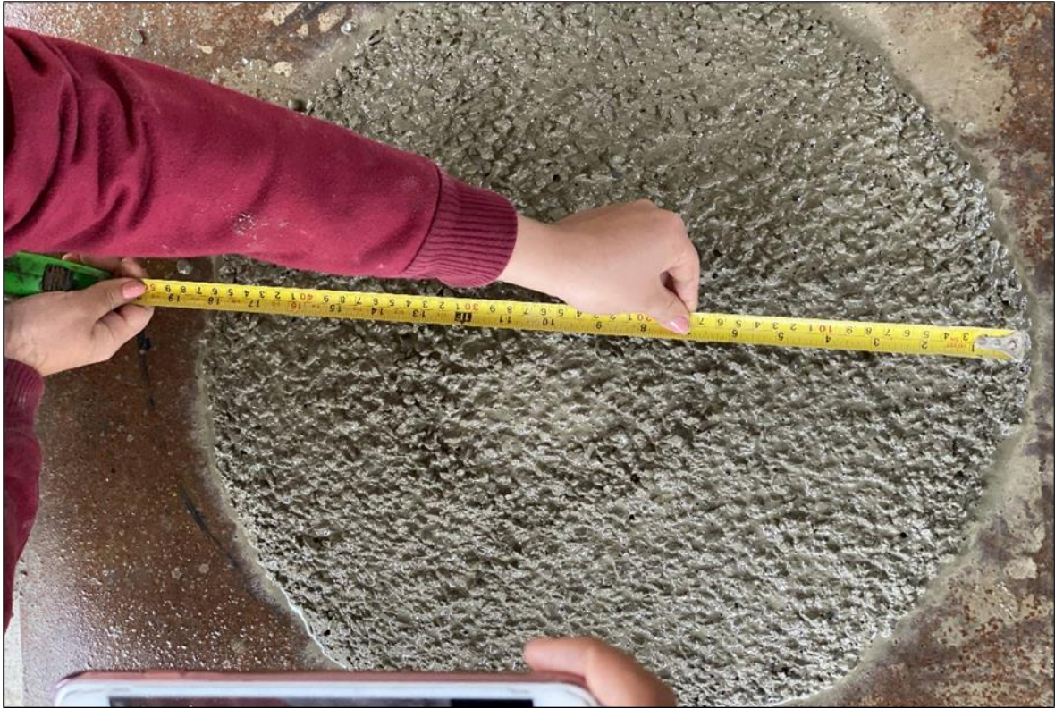
Figura 80. Medición de la extensibilidad del concreto
