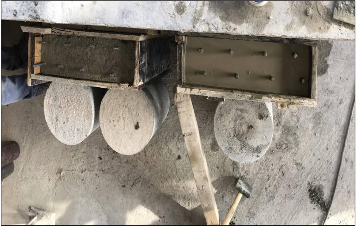
Figura 43. Llenado de concreto en placas con concreto convencional y autocompactante
