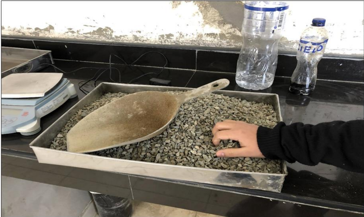
Figura 46. Selección del agregado grueso para su análisis granulométrico
