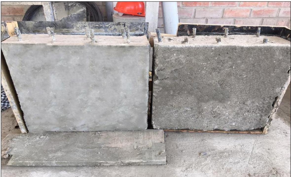
Figura 44. Comparación de las placas con concreto (autocompactante) derecha y convencional (izquierda)
