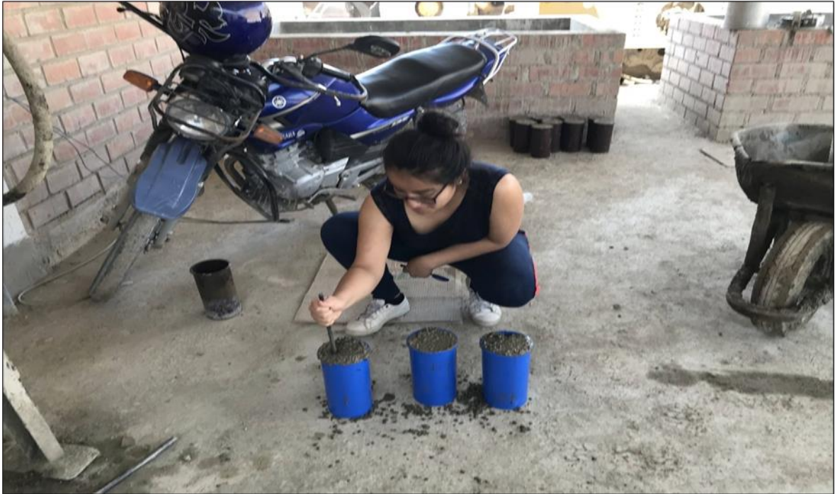
Figura 92. Elaboración de especímenes de concreto
