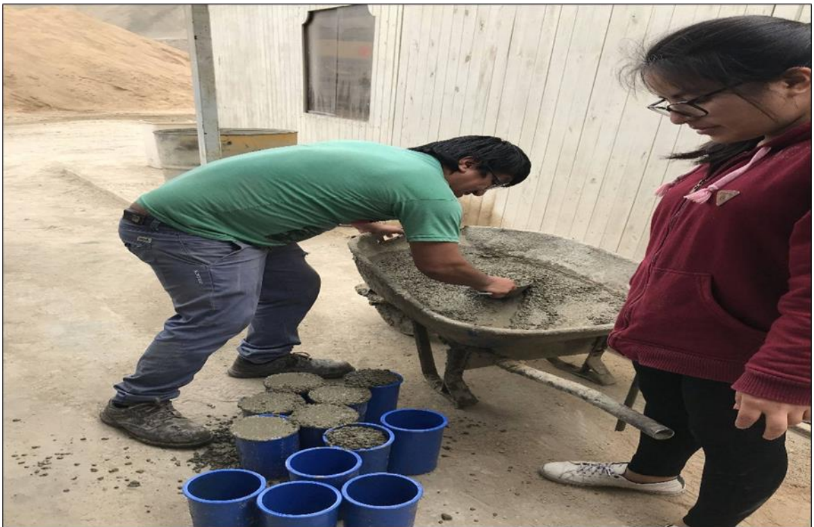
Figura 41. Elaboración de especímenes de concreto
