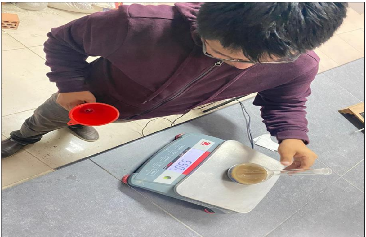
Figura 59. Pesado del picnómetro + agregado fino + agua
