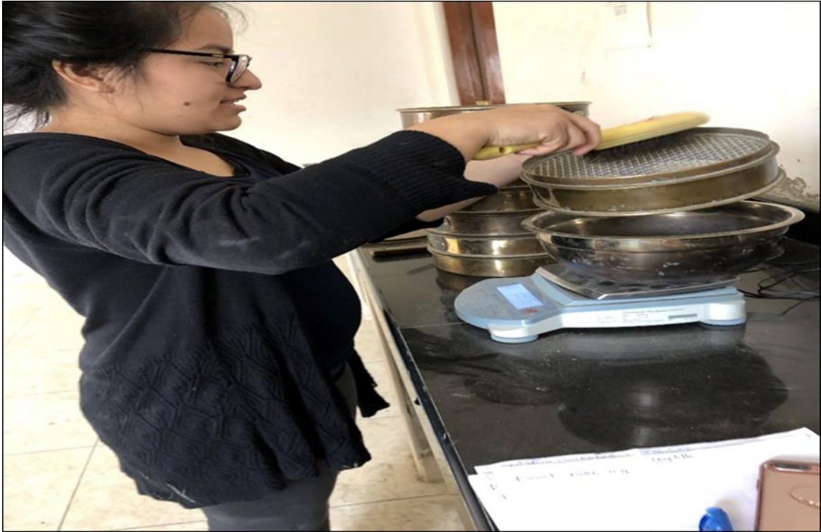
Figura 30. Peso del agregado grueso retenido en cada tamiz
