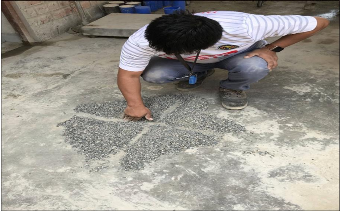
Figura 52. Cuarteo del agregado grueso para hallar el peso suelto del agregado grueso
