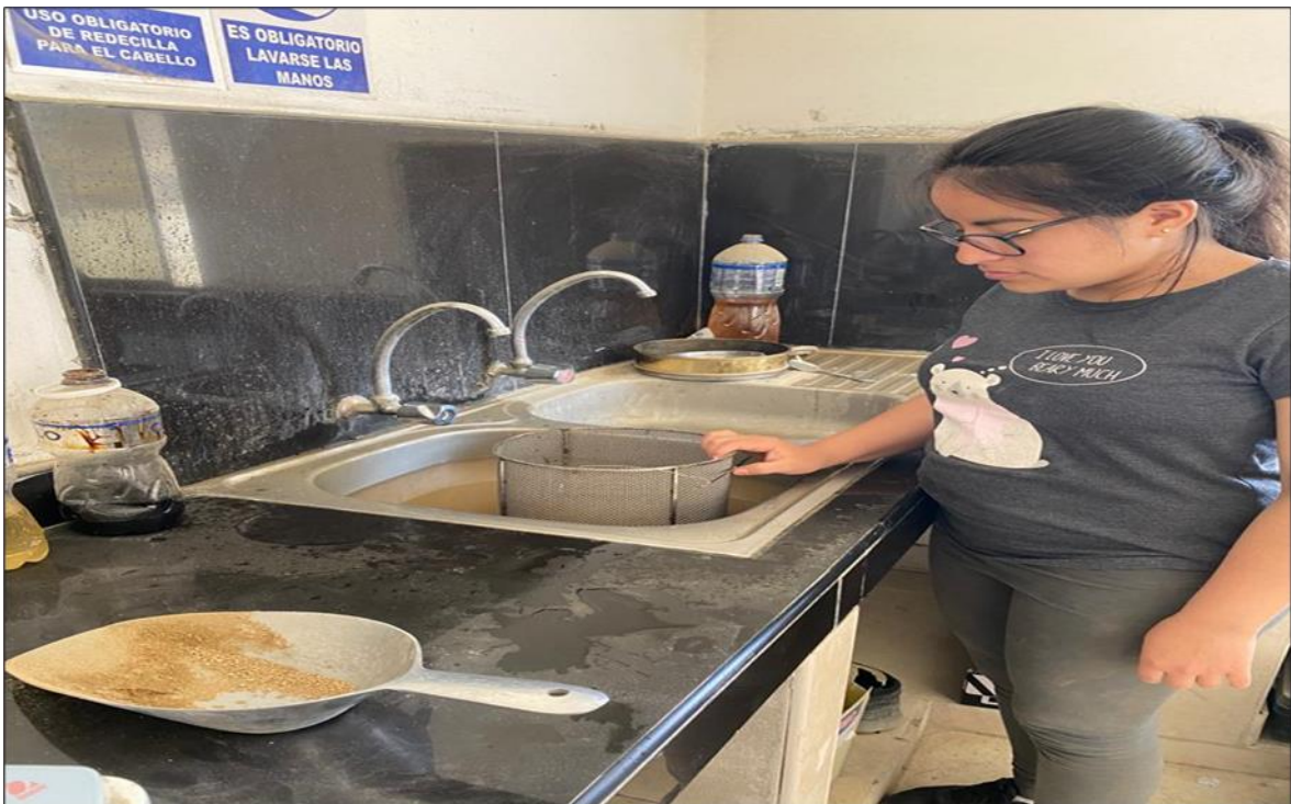
Figura 55. Agregado fino en canastilla y sumergido en agua para hallar el peso específico y porcentaje de absorción
