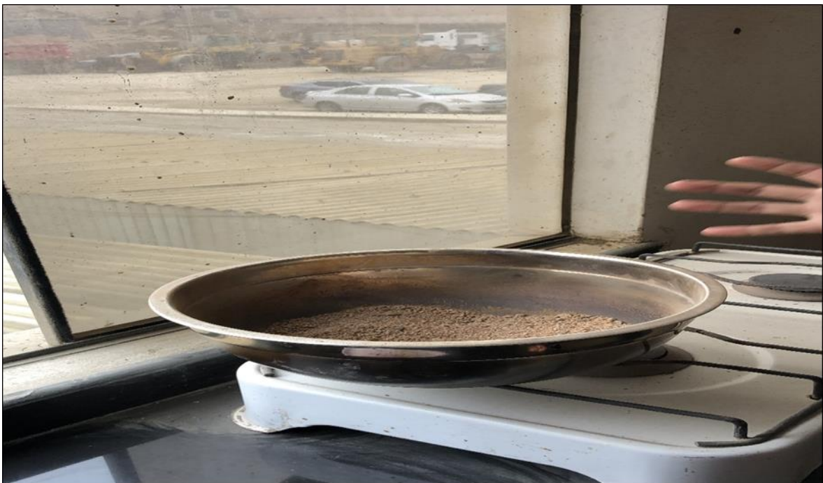
Figura 43. Lavado del agregado fino para hallar peso seco lavado
