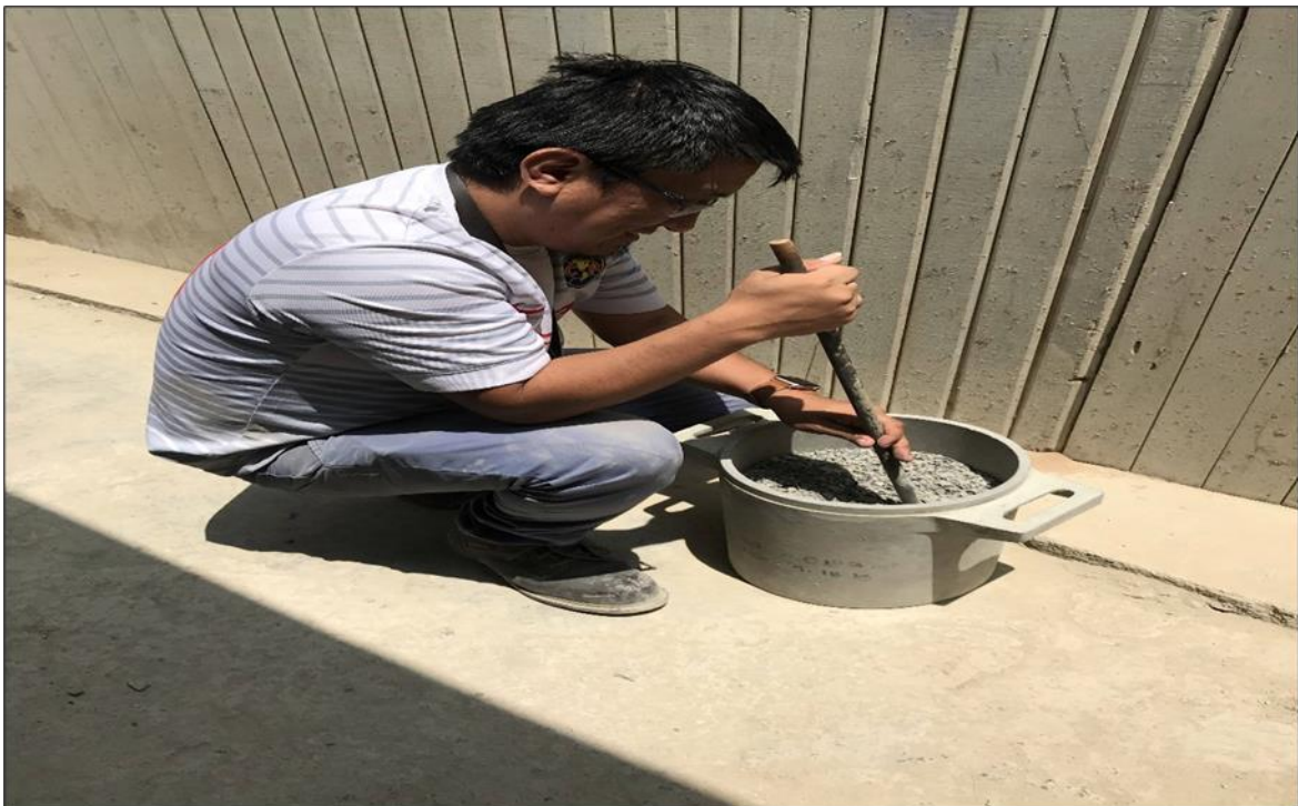
Figura 53. Peso compactado del agregado grueso
