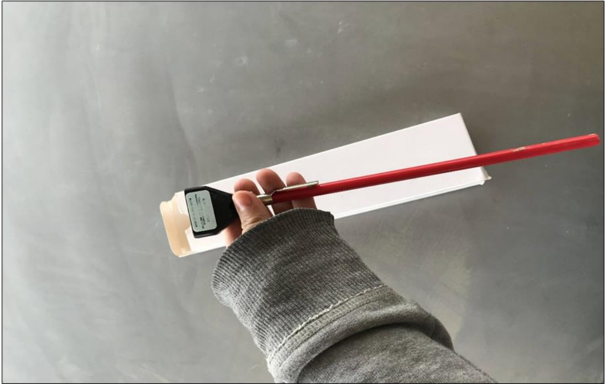
Figura 66. Termómetro para medir temperatura de los materiales
