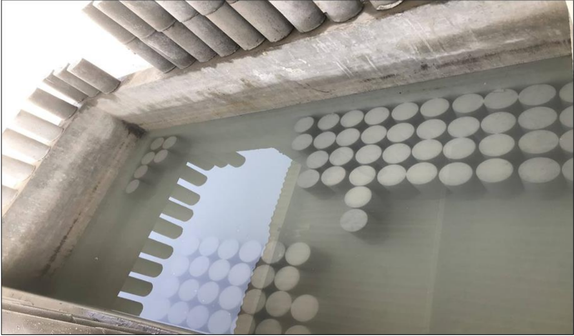
Ilustración 94. Curado de especímenes de concreto en una poza de agua con cal
