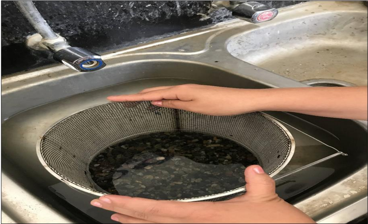
Figura 60. Agregado grueso en canastilla sumergido en agua
