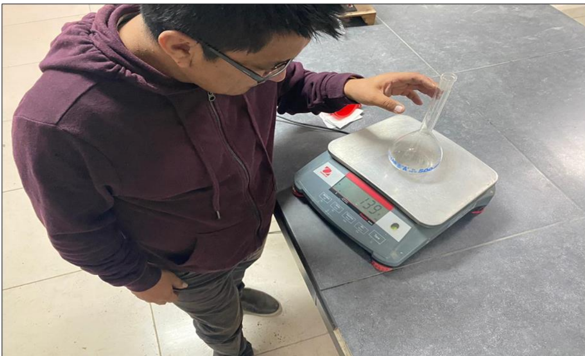
Figura 57. Pesado del picnómetro para hallar el peso específico del agregado fino
