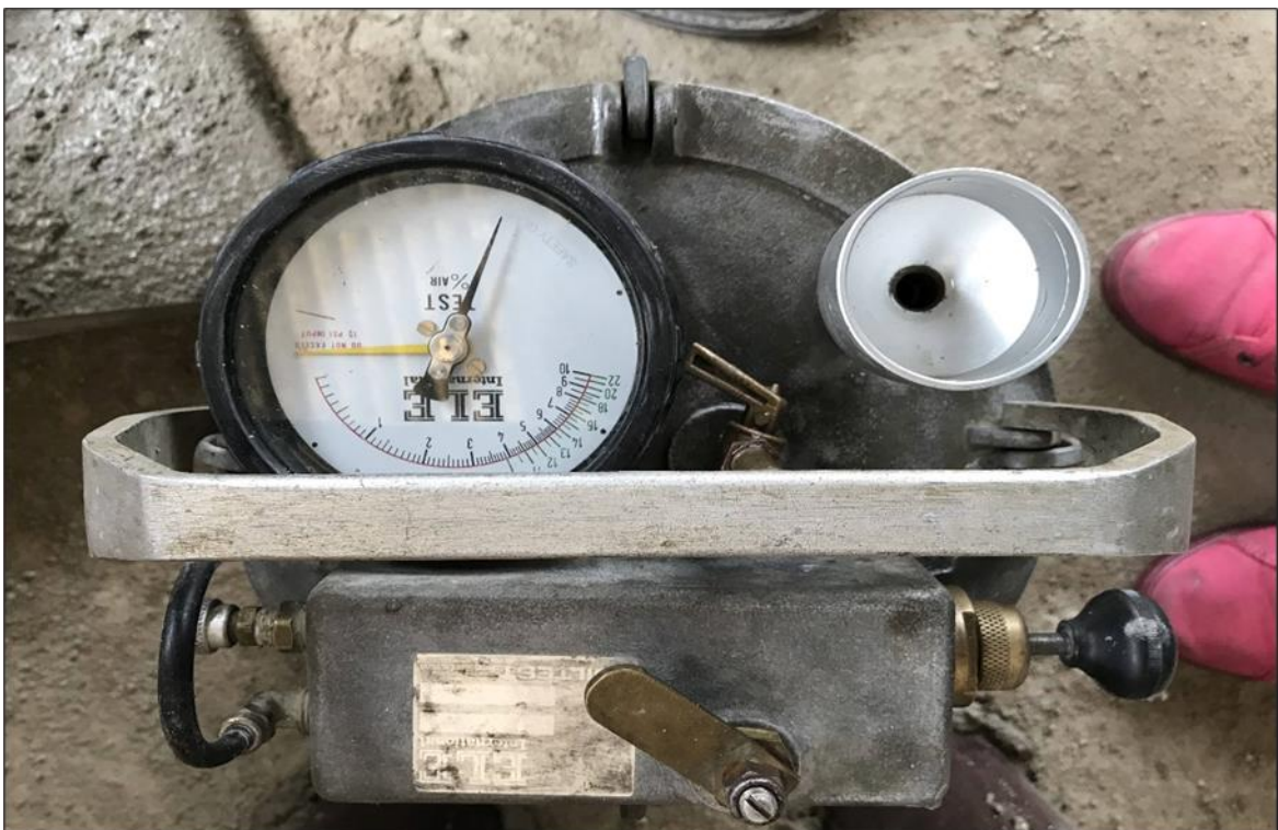
Figura 38. Olla de Washington para hallar el contenido de aire
