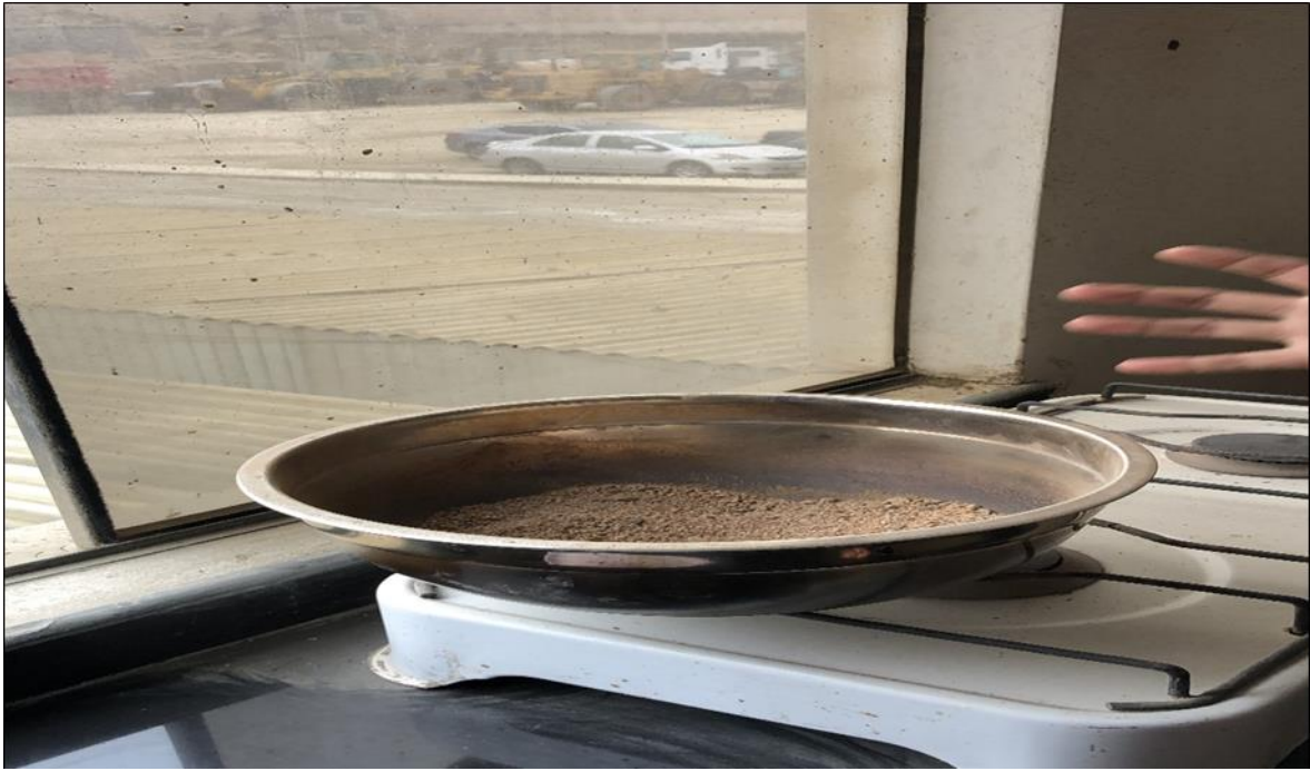
Figura 42. Secado del agregado fino en estufa
