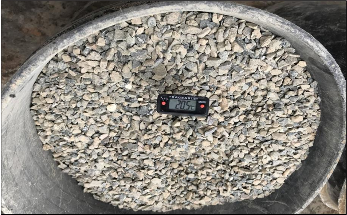
Figura 68. Temperatura del agregado grueso
