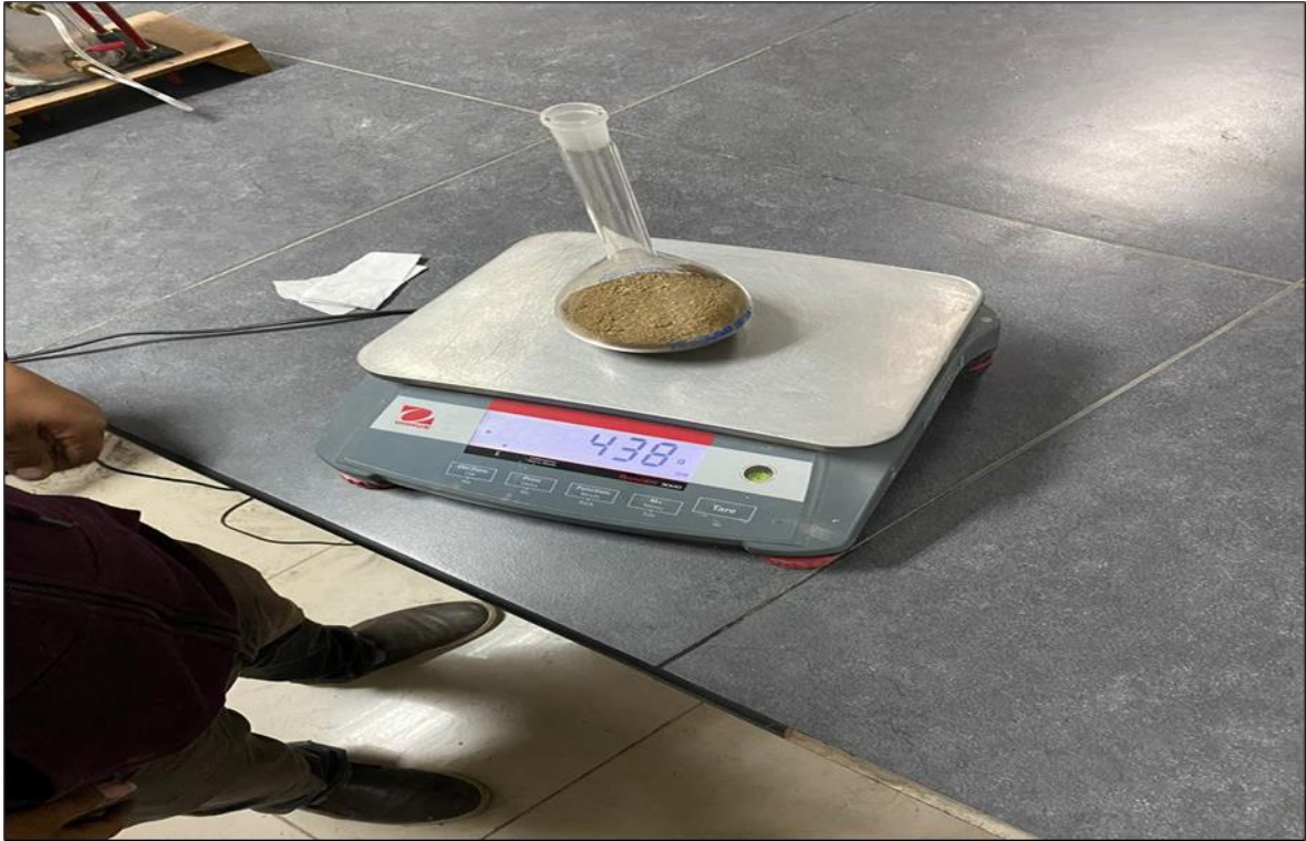
Figura 58. Pesado del picnómetro + agregado fino- ensayo para peso específico
