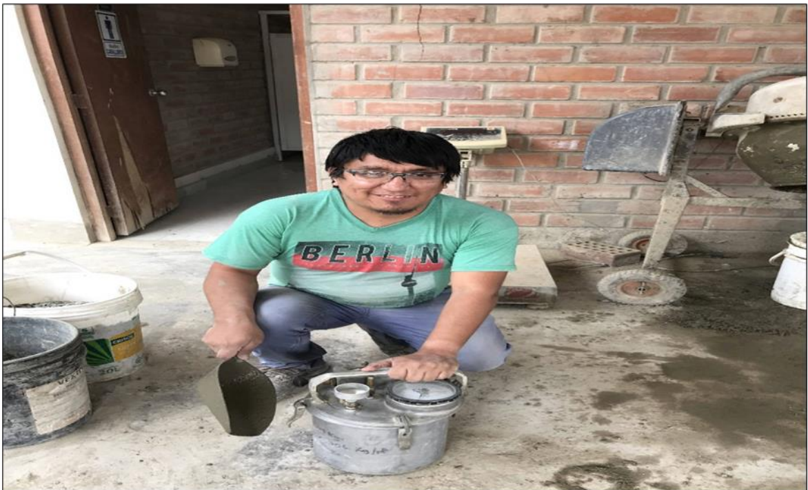
Figura 40. Hallando el porcentaje de aire en el concreto
