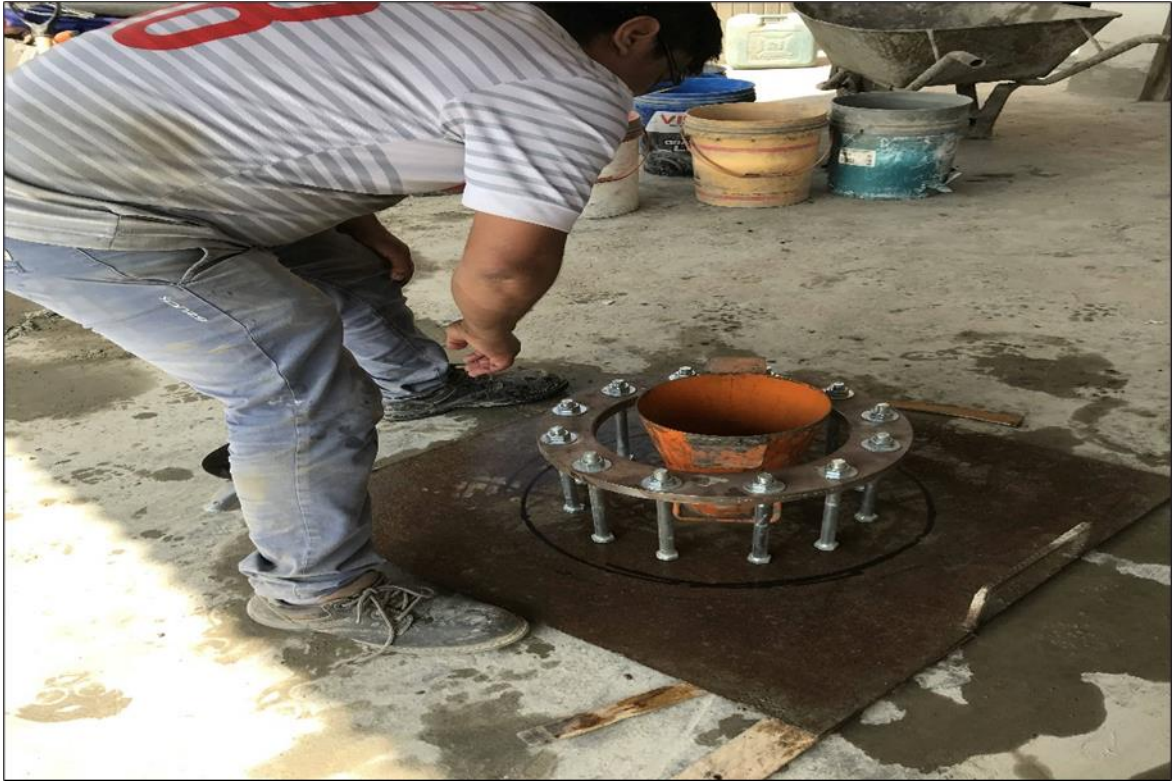
Figura 34. Ensayo del anillo J para la capacidad de paso
