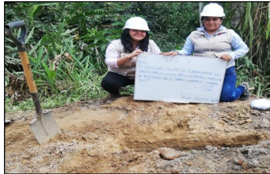
Imagen 03: Excavación de la calicata N°02 en la carretera Cacatachi – Chirapa
