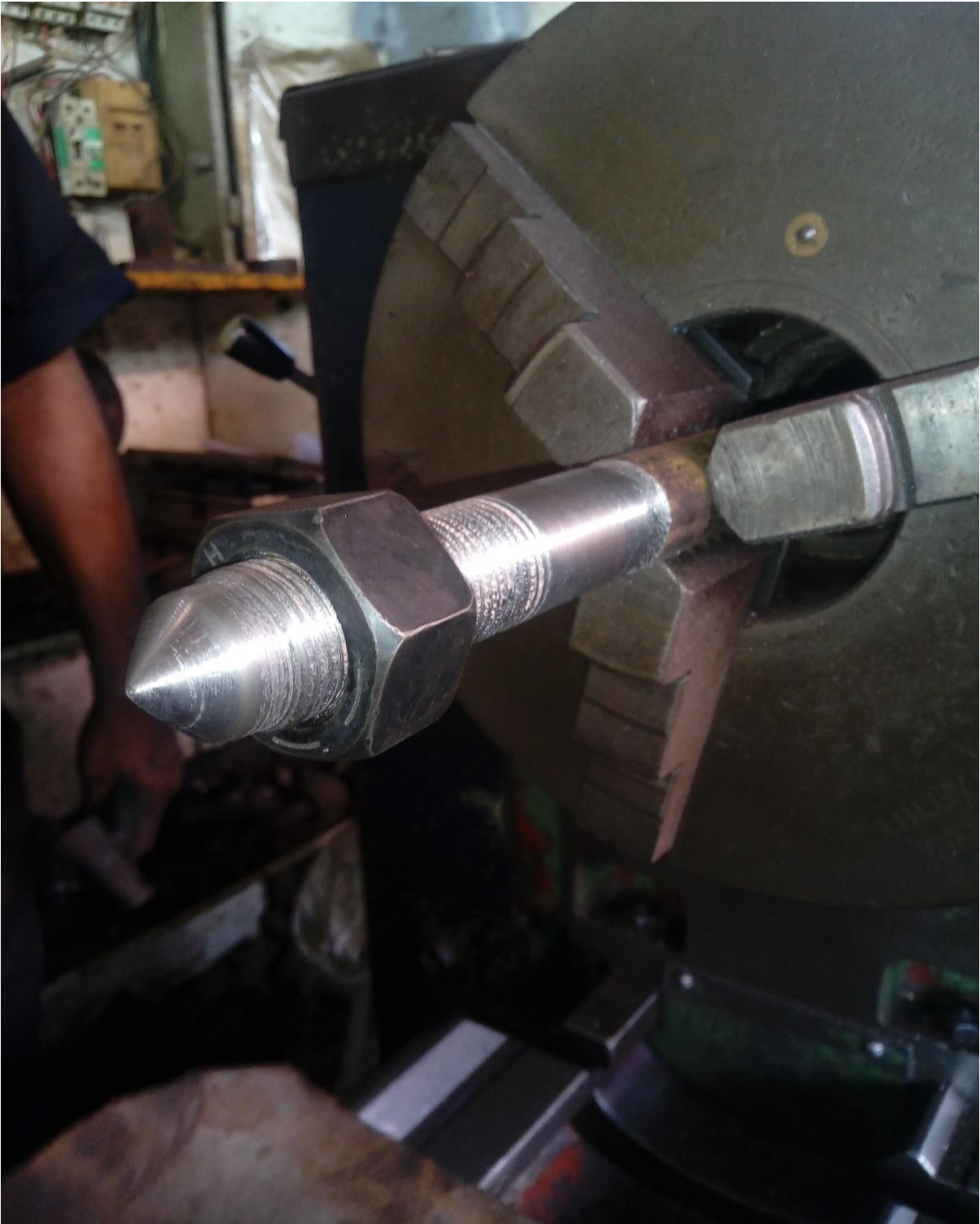
Figura N°05 Mecanizado de rosca métrica del eje central
