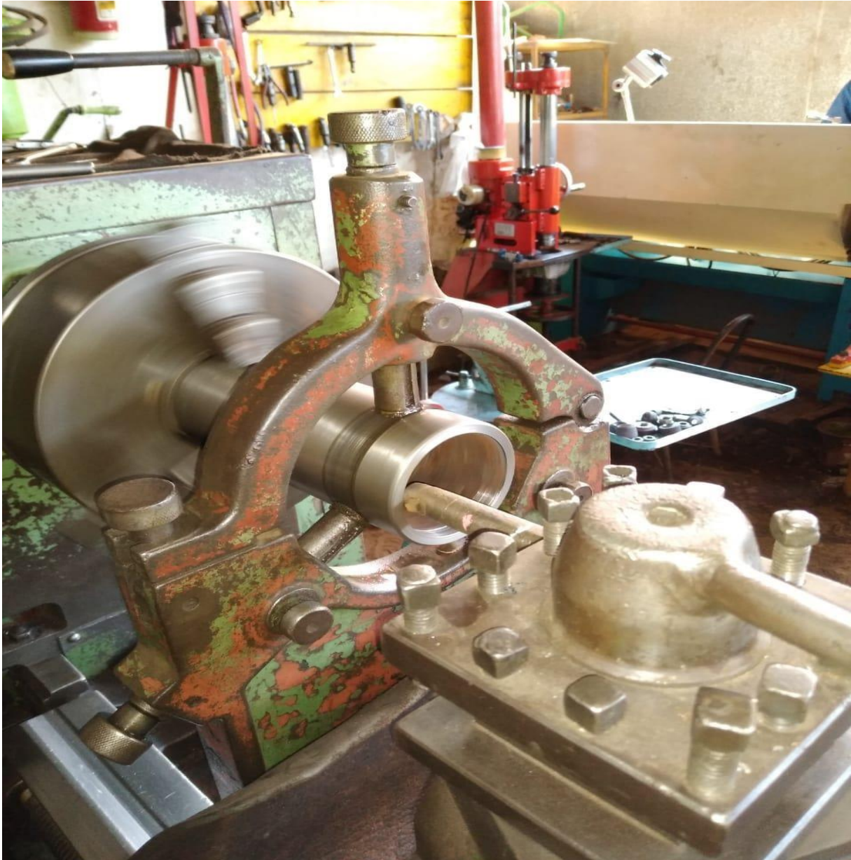
Figura N°03 Mecanizado de estructura central cilíndrica
