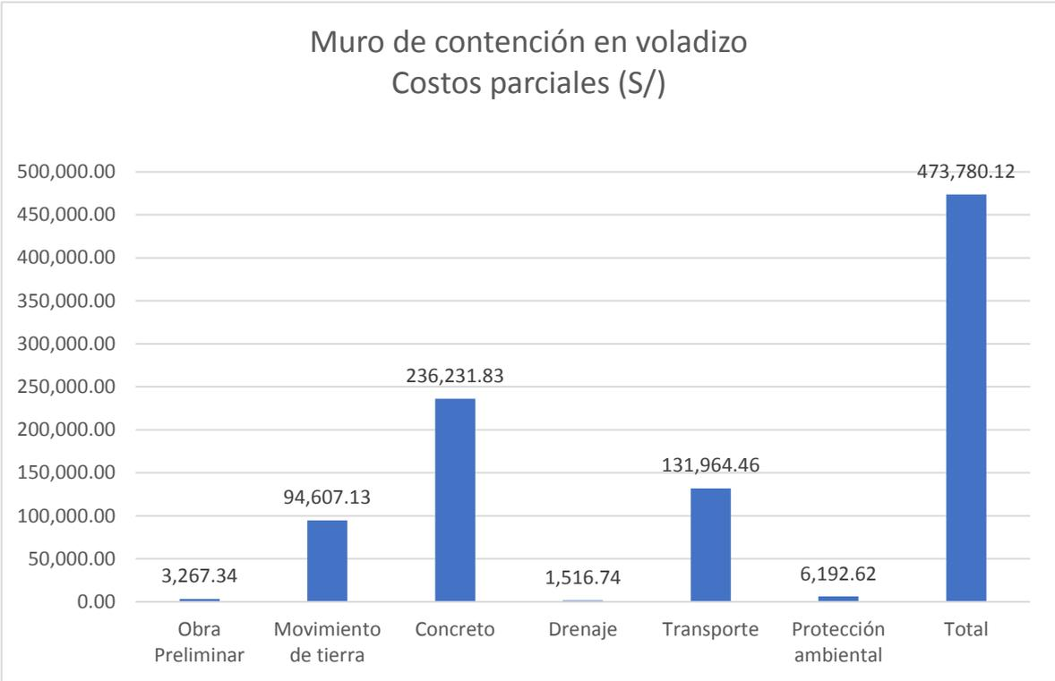
Figura 44 Evaluación de muros de contención en voladizo en % costos parciales
