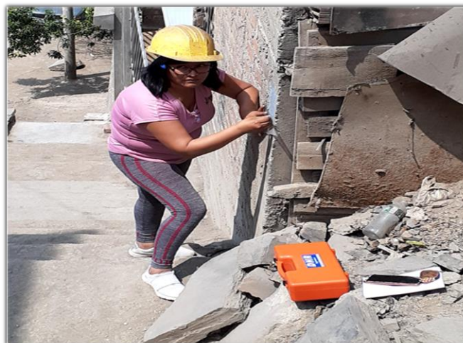
Foto N°11: trazado del rectángulo en la columna del Lote N°1
