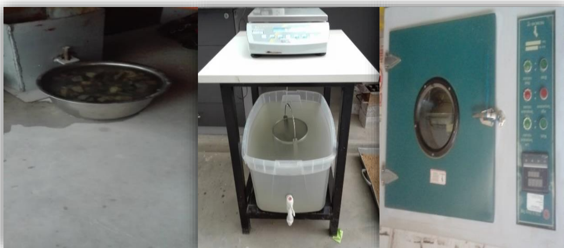
Figura 32. Proceso de ensayo de peso específico y absorción.
