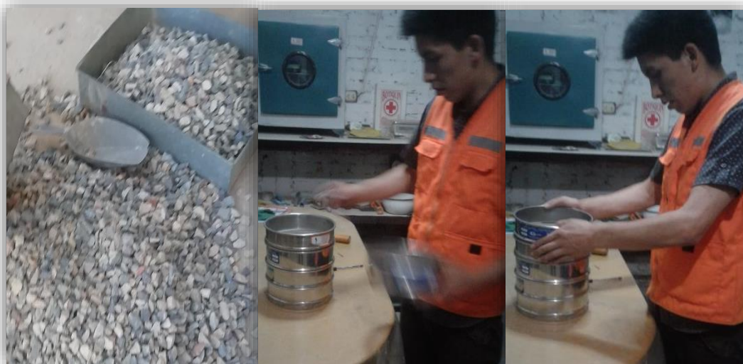
Figura 33. Proceso de ensayo de granulometría de piedra chancada.
