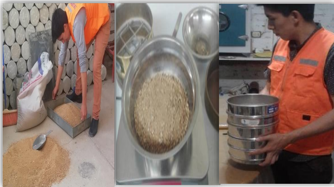
Figura 36. Proceso de ensayo de granulometría.
