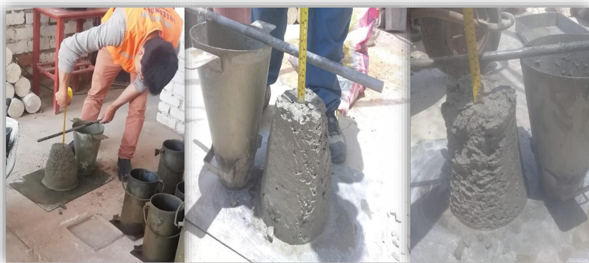
Figura 43. Proceso de elaboración del ensayo de SLUMP
