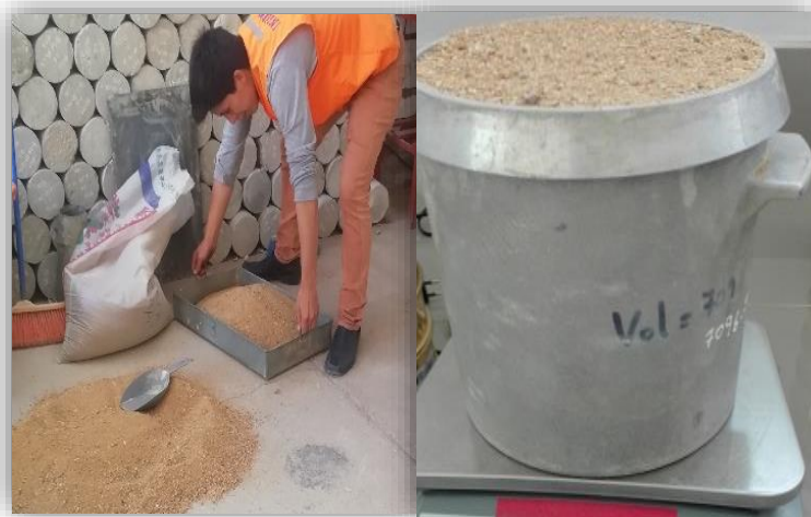
Figura 34. Proceso de ensayo de peso unitario del agregado fino.
