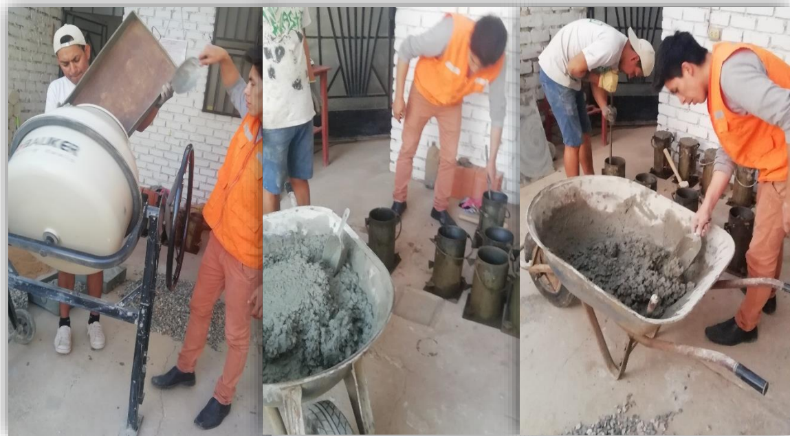
Figura 40. Proceso de elaboración de probetas.
