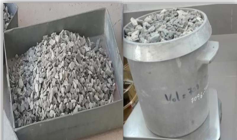
Figura 31. Ensayo de peso unitario del agregado grueso.
