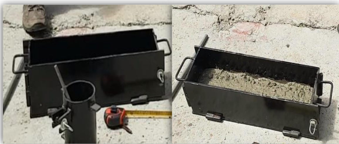
Figura 41. Moldes de viguetas, para ensayo a flexión.
