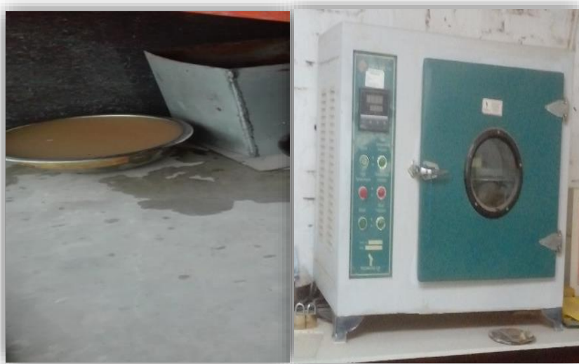
Figura 35. Proceso de ensayo de peso específico y absorción.
