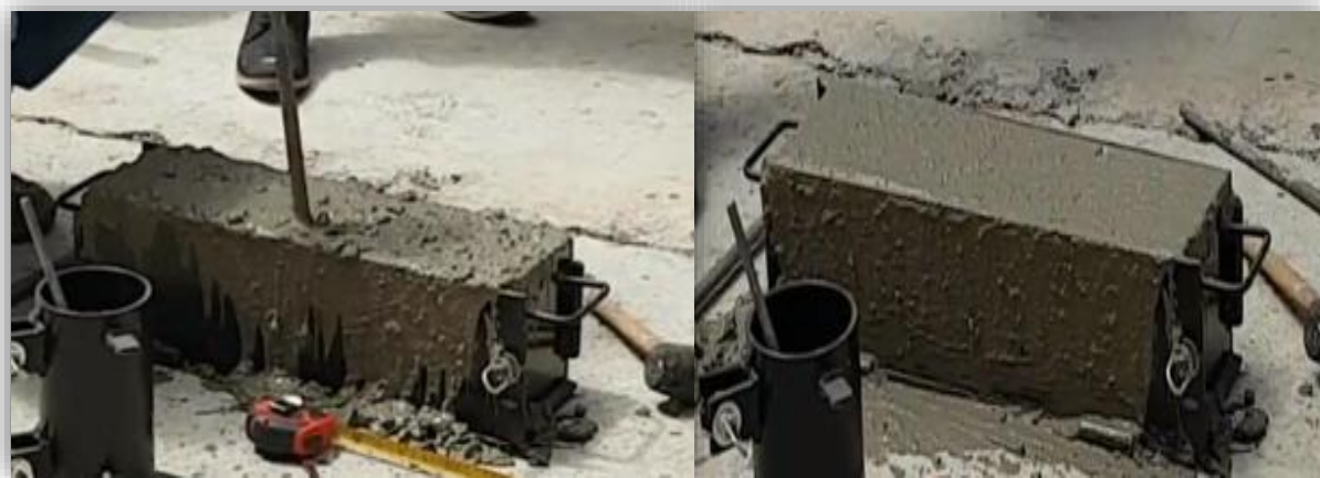
Figura 42. Proceso de elaboración de vigueta
