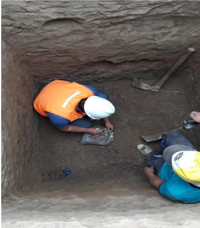
Figura 16: Extracción de muestras del último estrato
