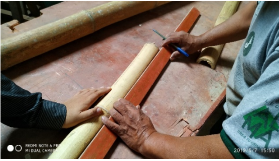
En esta imagen se visualiza el dimensionamiento de las probetas de bambú antes de ser cortadas.
