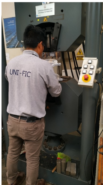
En esta imagen se visualiza al técnico colocando los accesorios necesarios para el ensayo de corte.
