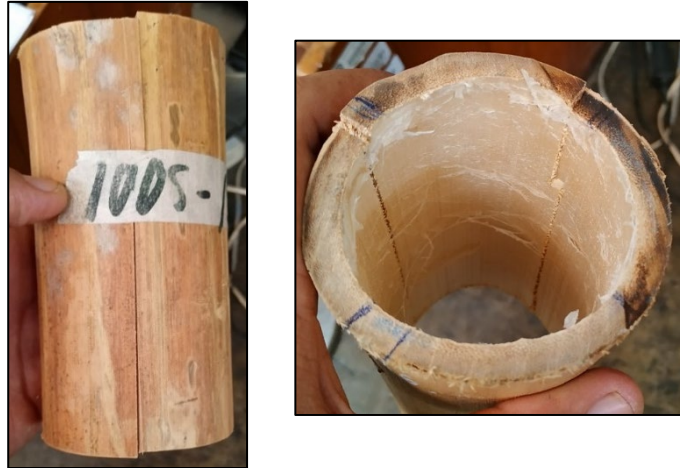
Figura 15: Fallas típicas del ensayo de corte paralelo a la fibra
