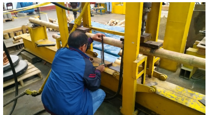
En esta imagen se visualiza al técnico midiendo la deflexión de la caña de bambú durante el ensayo a flexión.
