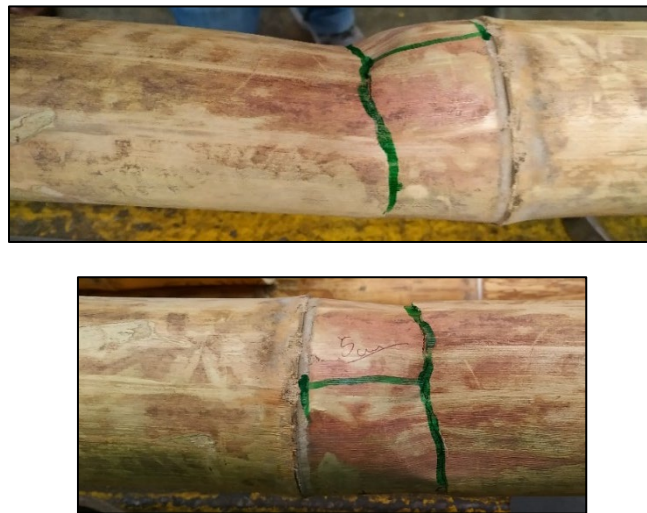
Figura 21: Falla típica de la probeta en el ensayo a flexión estática
