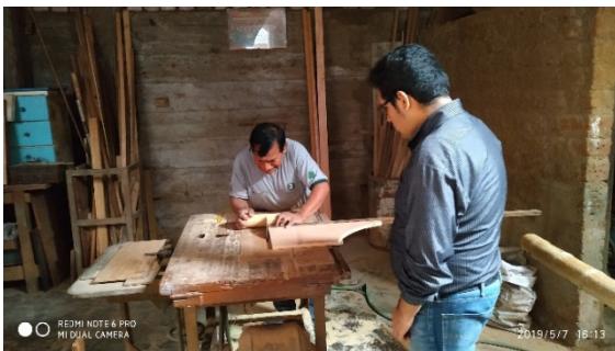
En esta imagen se visualiza el cortado de las probetas de bambú.
