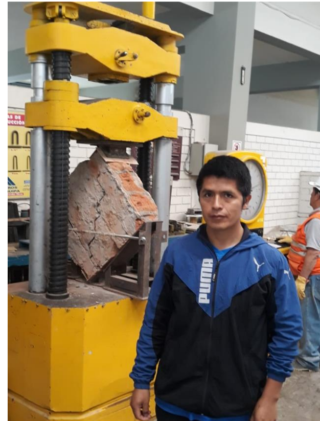
Murete A: Falla por corte diagonal
