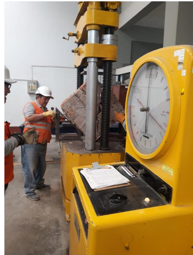
Murete A: Equipos de ensayo y murete fallado.
