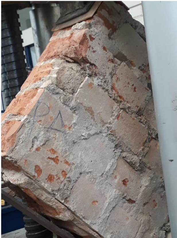
Murete A: Colocado en el equipo compresor
