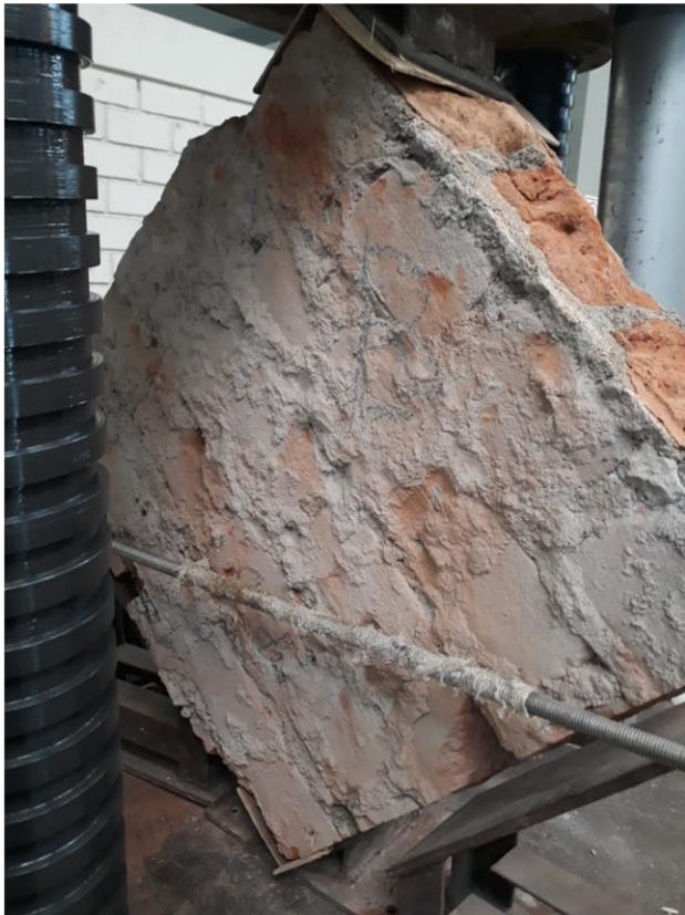
Murete B: Colocado en el equipo compresor
