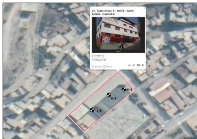
Figura 14: Ubicación de las calicatas en la I.E Túpac Amaru II -20825
