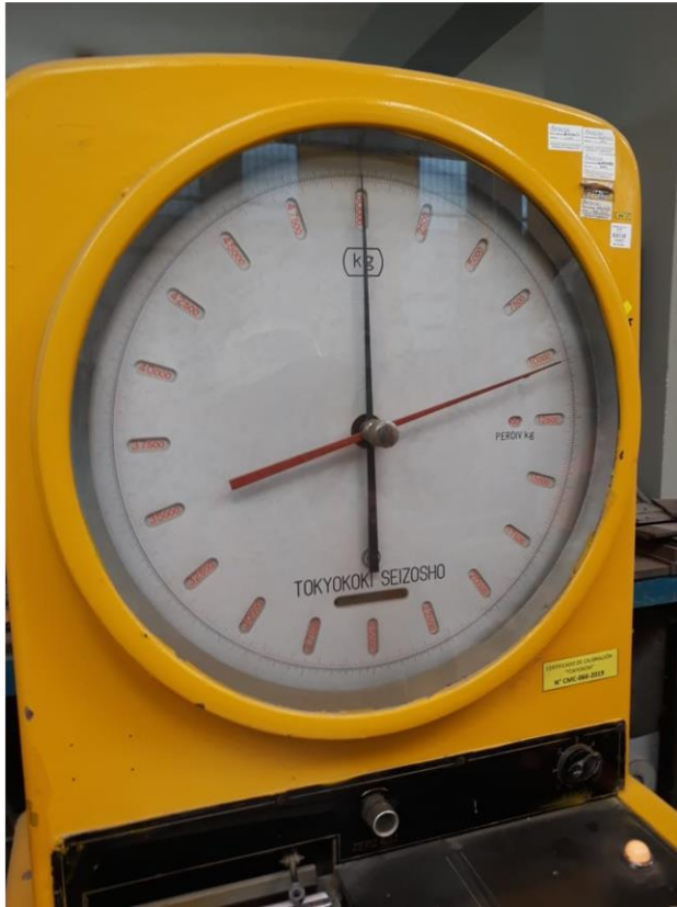
Murete B: La carga de falla por corte diagonal.
