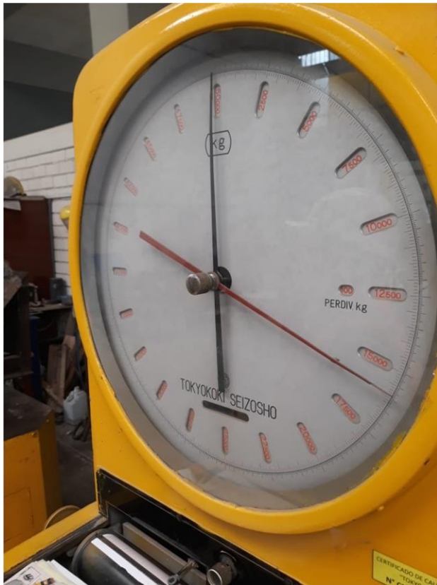
Murete A: La carga de falla por corte diagonal.
