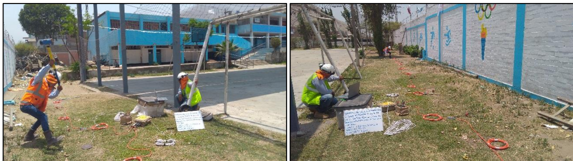
Figura. 33 Estudio Geofísico Mediante el Método de Refracción Sísmica y MASW.
