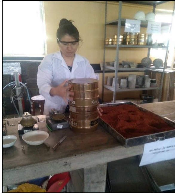
Figura 111. Se inició a realizar el ensayo de granulometría.
