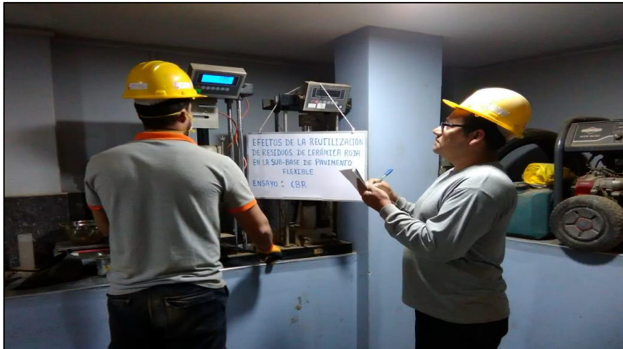
Figura 119. Recolección de los datos por los encargados del lab al haber pasado los 4 días para conocer su expansión, y obtener su curva de CBR correspondiente.
