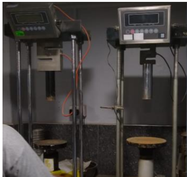
Figura 118. Equipo de CBR empleó para conocer los datos y la penetración por pulgadas.
