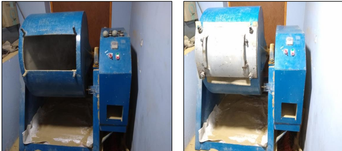
Figura 120. Máquina de los Ángeles que se empleó para el método D con 6 esferas.
