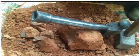
Figura 102. Luego de que el residuo ha sido pasado por el agua facilitara en el proceso de ser triturado.
