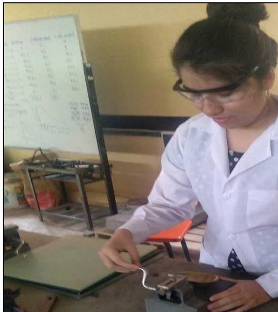
Figura 112. Ensayo de limite liquido con los materiales llevado al lab. dando un total de 25 golpes con la copa de Casagrande.
