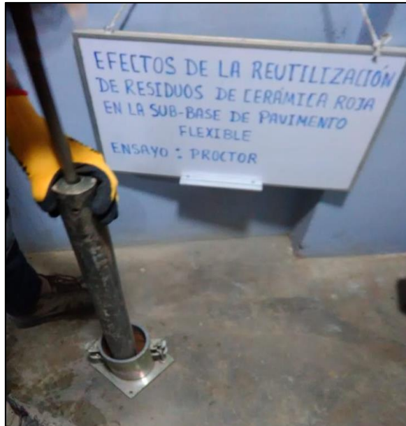
Figura 117. Ensayo de compactación con el Próctor modificado Método A, 50% suelo + 50% R.C.R.
