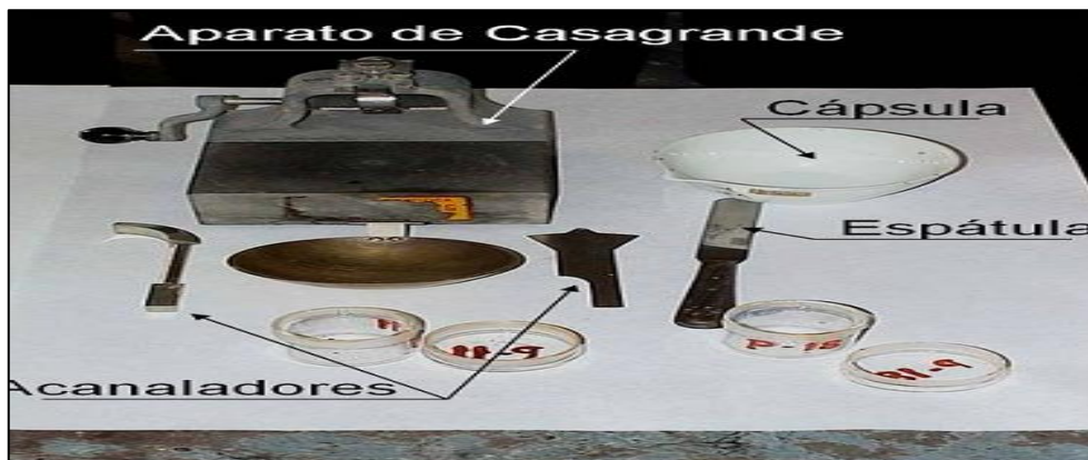
Figura 13. Límite de Atterberg- Aparato de Casagrande
