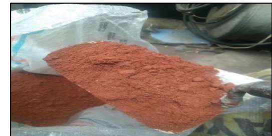
Figura 104. Material que se obtuvo del residuo de cerámica roja después de ser triturado.
