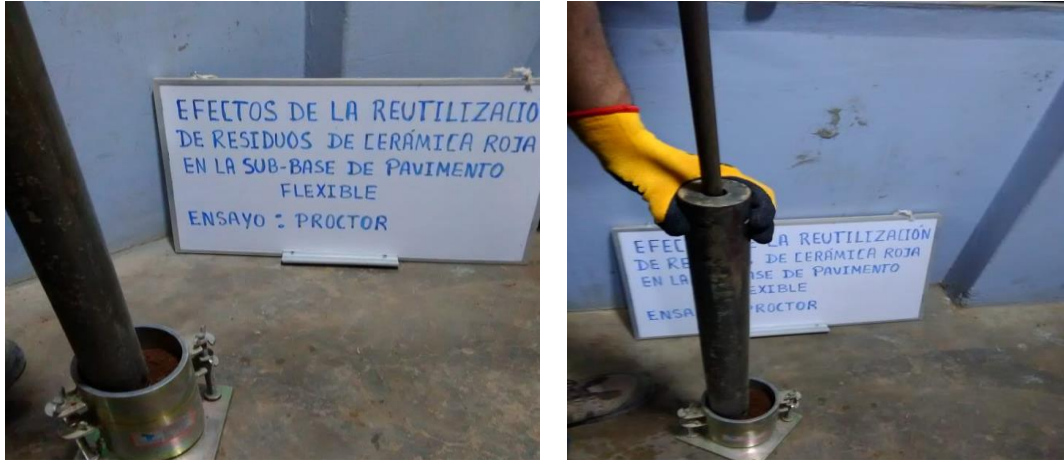
Figura 40. Ensayo Próctor Modificado
