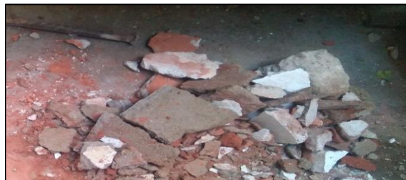
Figura 103. Material de concreto que fue desechado como los materiales de residuo fueron más ladrillo macizo se tuvo poco concreto.
