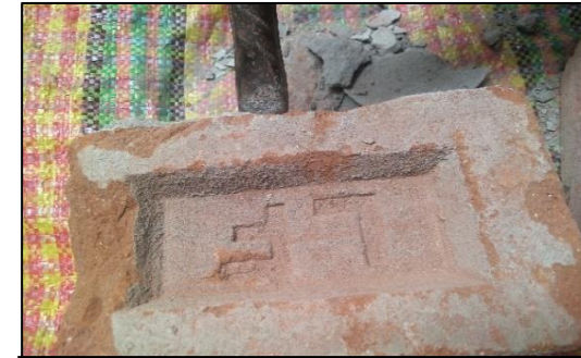
Figura 101. Ladrillo King Kong macizo obtenido de residuo.
