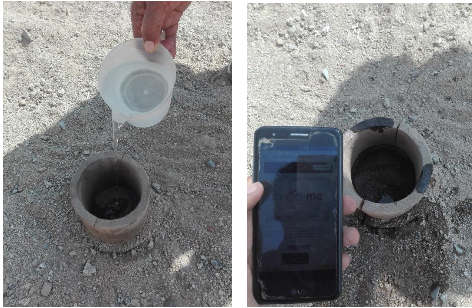
Figura 28. Medición de infiltración- método del cilindro
